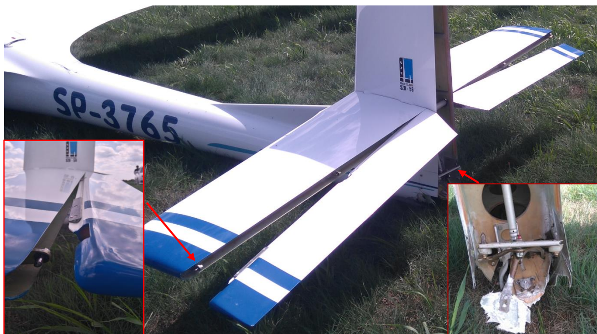
Rys. 8 Uszkodzenia szybowca – zniszczone mocowanie steru wysokości i steru kierunku
