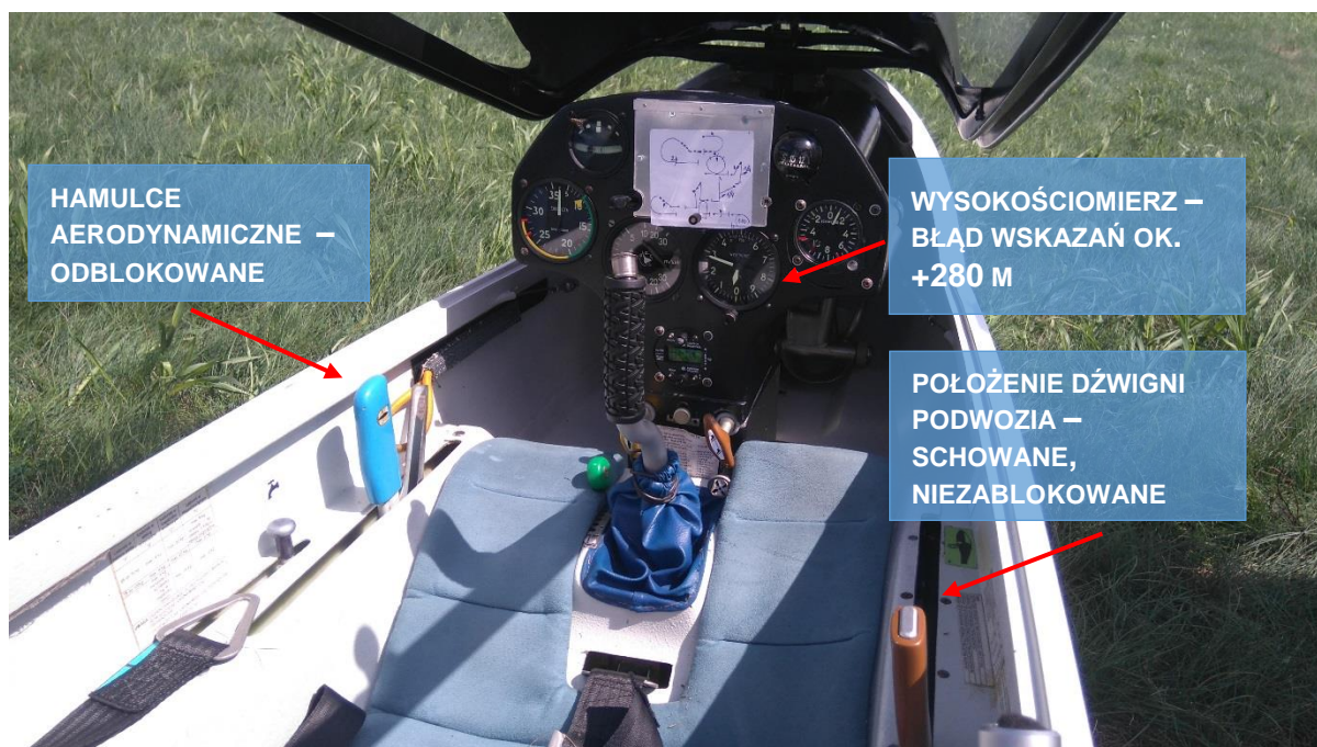
Rys. 3 Widok kabiny pilota po lądowaniu
