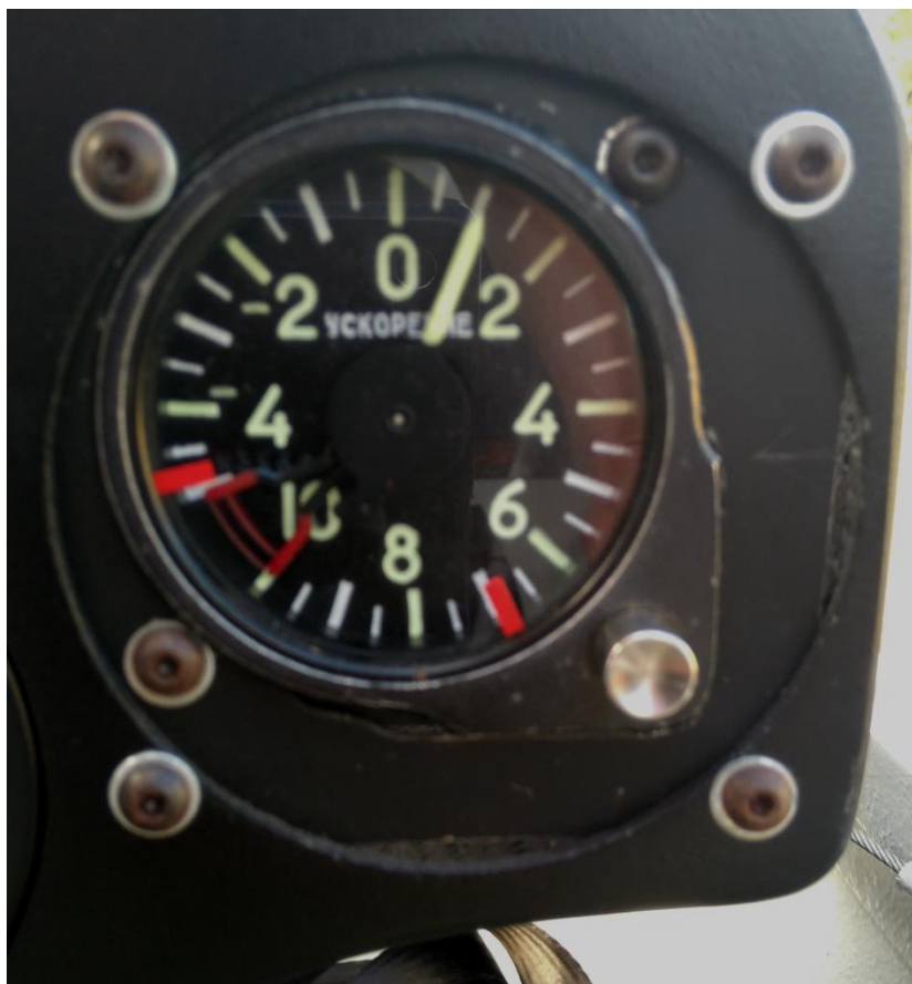
Rys. 10 Przeciążeniomierz – wskazania po zdarzeniu
