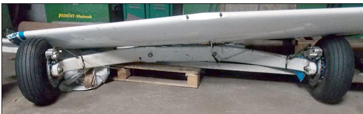
22 – Usterzenie poziome i wyłamane w całości podwozie główne.
