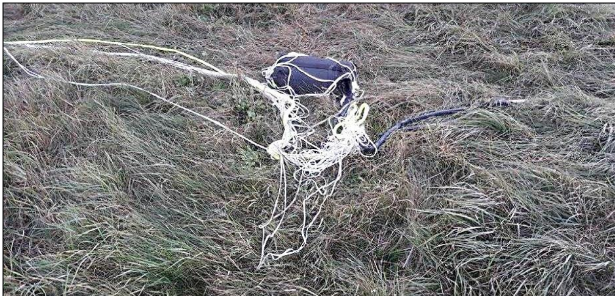
18 – Spadochron systemu ratowniczego GRS w pokrowcu, z częściowo wplecionymi linkami [foto: Wojciech Nawrocki, wloclawek.naszemiasto]
