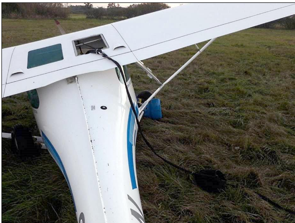
17 – Zbliżenie od tyłu na środkową część kadłuba. Widoczna wyrwana pokrywa zasobnika systemu GRS oraz wyciągnięta uprząż spadochronu ratowniczego systemu GRS [foto: Wojciech Nawrocki, wloclawek.naszemiasto]
