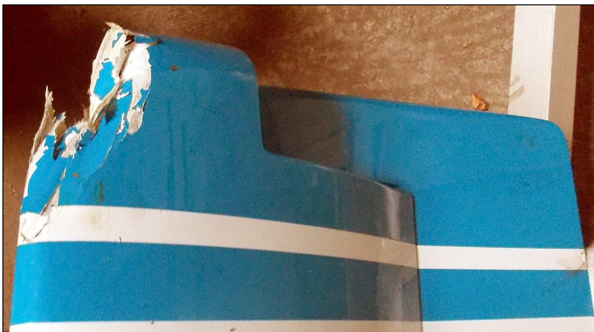
27 – Uszkodzony nosek prawej końcówki statecznika poziomego.
