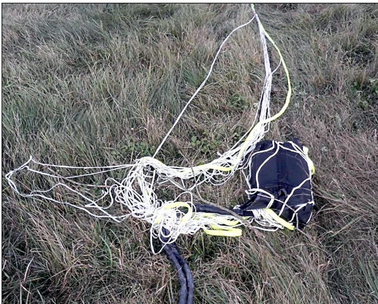
19 – Spadochron systemu ratowniczego GRS w pokrowcu, z częściowo wplecionymi linkami [foto: Wojciech Nawrocki, wloclawek.naszemiasto]
