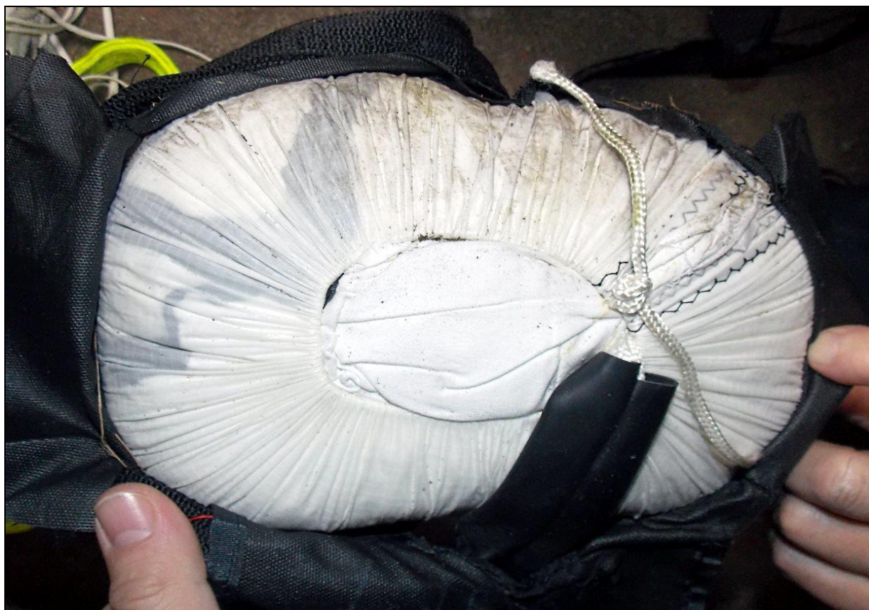
38 – Spadochron systemu GRS w pokrowcu – widok od spodu.
