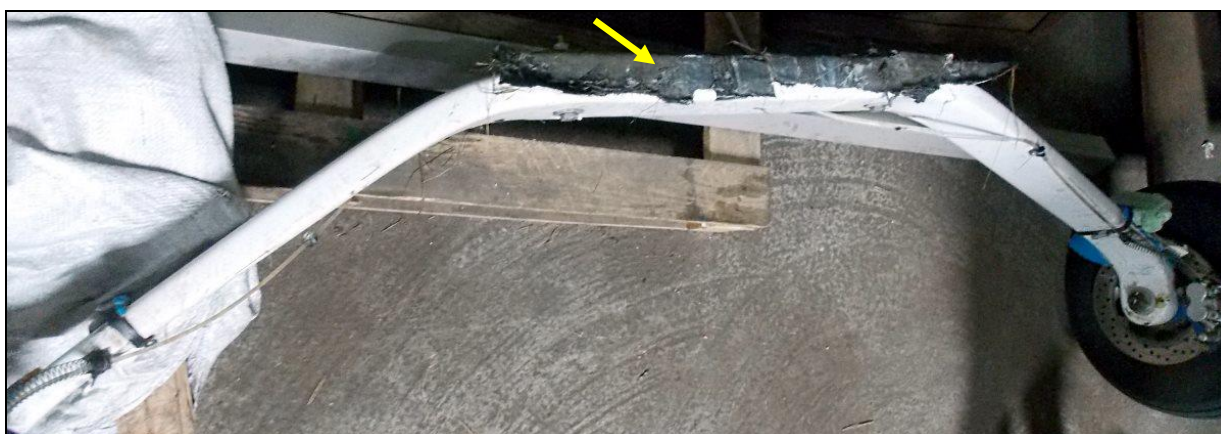
23 – Podwozie główne – widoczny fragment wyrwanego pokrycia kadłuba.
