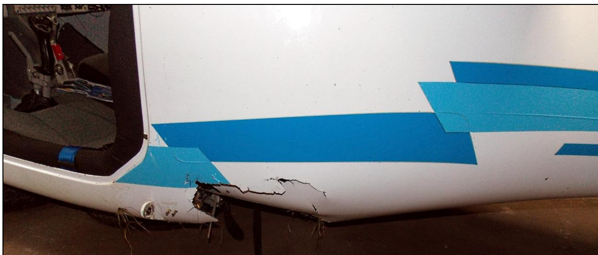
21 – Uszkodzenia kadłuba z lewej strony, spowodowane wyłamywaniem goleni podwozia głównego.
