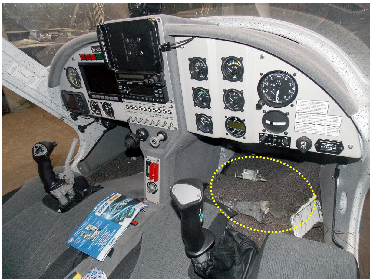
29 – Wnętrze kabiny i tablica przyrządów z prawej strony. Widoczne uszkodzenia prawej części podłogi.
