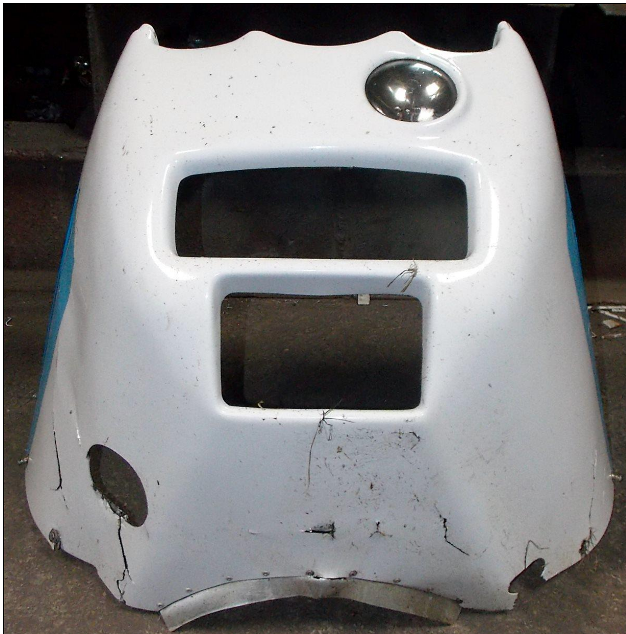
42 – Uszkodzona dolna osłona silnika.
