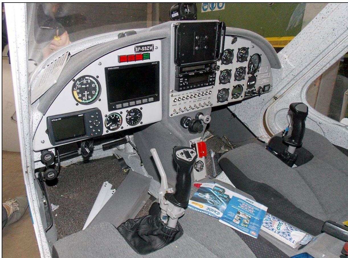
28 – Wnętrze kabiny i tablica przyrządów z lewej strony.
