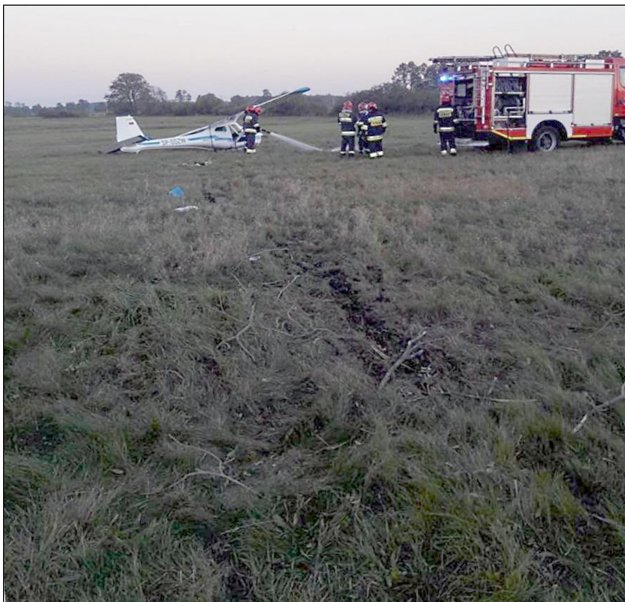
7 – Ślad przyziemienia – bruzda wryta złamaną golenią przedniego podwozia [foto: Wojciech Nawrocki, wloclawek.naszemiasto]
