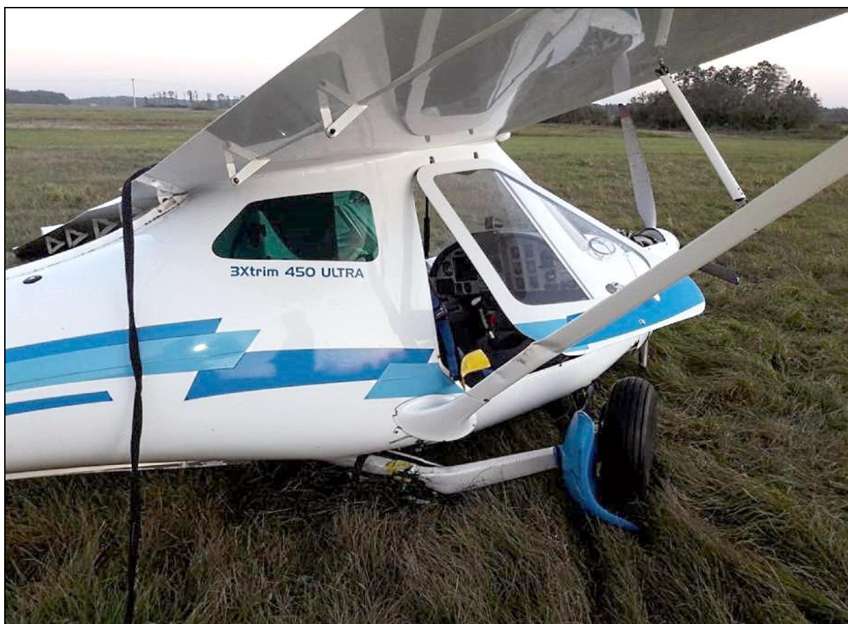
11 – Samolot na miejscu wypadku, zbliżenie z prawej strony. Widoczna wyciągnięta uprząż spadochronu ratowniczego systemu GRS i wylamane podwozie główne [foto: Wojciech Nawrocki, wloclawek.naszemiasto]
