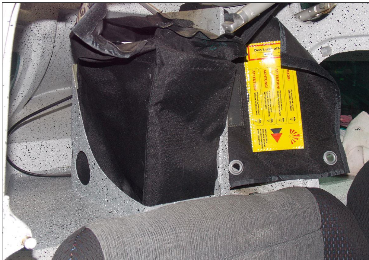
33 – Luk systemu ratowniczego GRS. Widoczny zasobnik spadochronu z opisami ostrzegawczymi.
