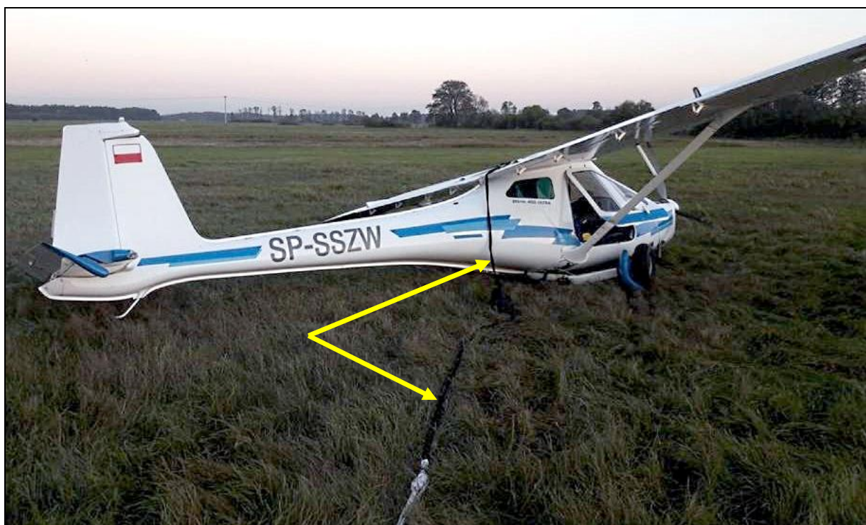
8 – Samolot na miejscu wypadku, widok ogólny z prawej strony. Widoczna wyciągnięta uprzęż spadochronu ratowniczego systemu GRS [foto: Wojciech Nawrocki, wloclawek.naszemiasto]
