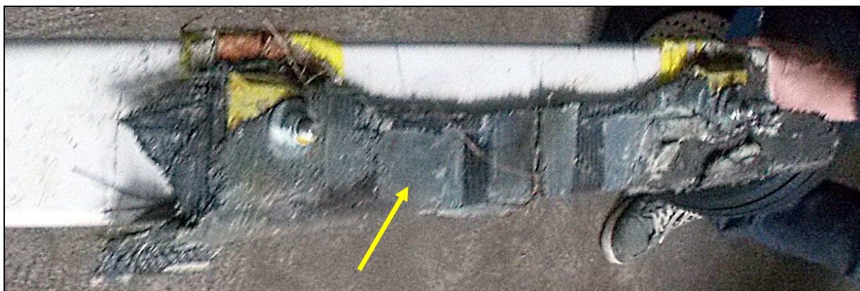
25 – Podwozie główne – zbliżenie na fragment wyrwanego pokrycia kadłuba.
