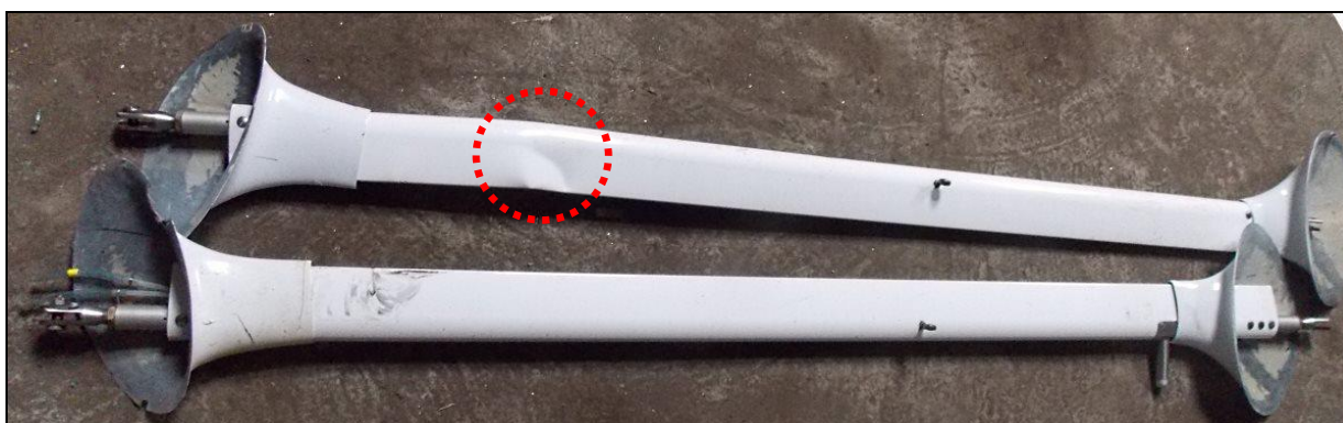
26 – Zdemontowane zastrzały skrzydeł. Widoczne lokalne odkształcenie prawego zastrzału.
