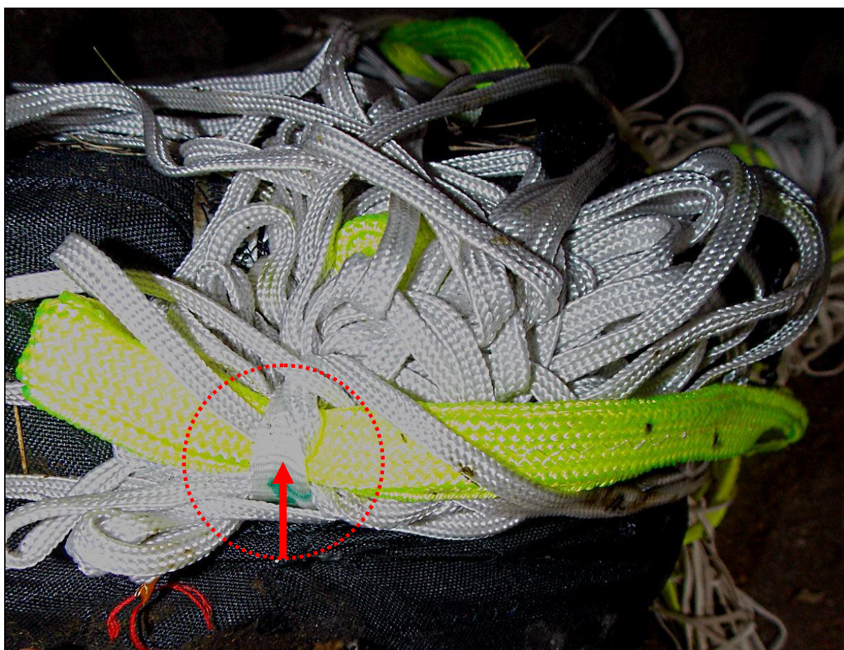
39– Spadochron systemu GRS w pokrowcu – widok od góry. Zaznaczona silnie zaciśnięta opaska, spod której nie zostały całkowicie wyplecione linki i żółta taśma czaszy spadochronu ratowniczego.
