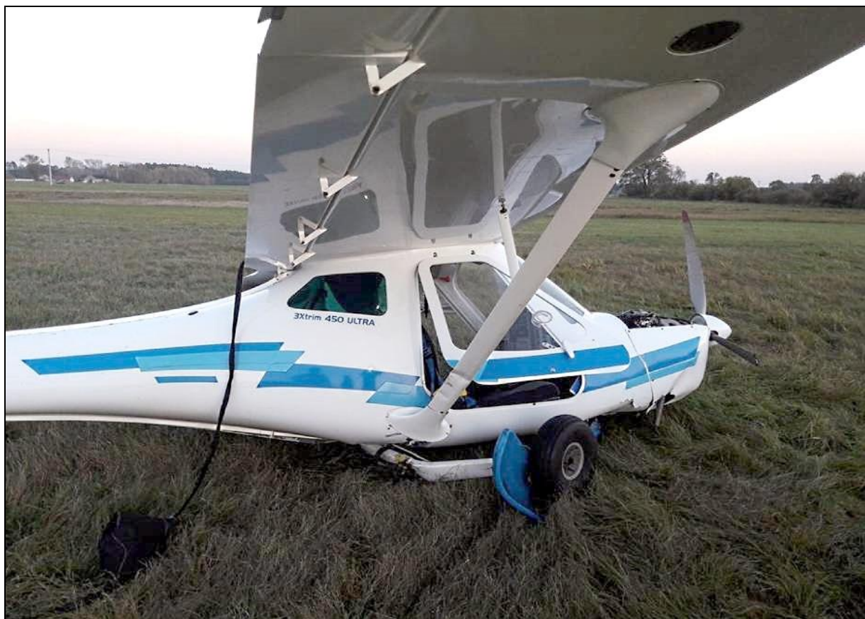
10 – Samolot na miejscu wypadku, zbliżenie z prawej strony. Widoczna wyciągnięta uprząż spadochronu ratowniczego systemu GRS i wylamane podwozie główne [foto: Wojciech Nawrocki, wloclawek.naszemiasto]
