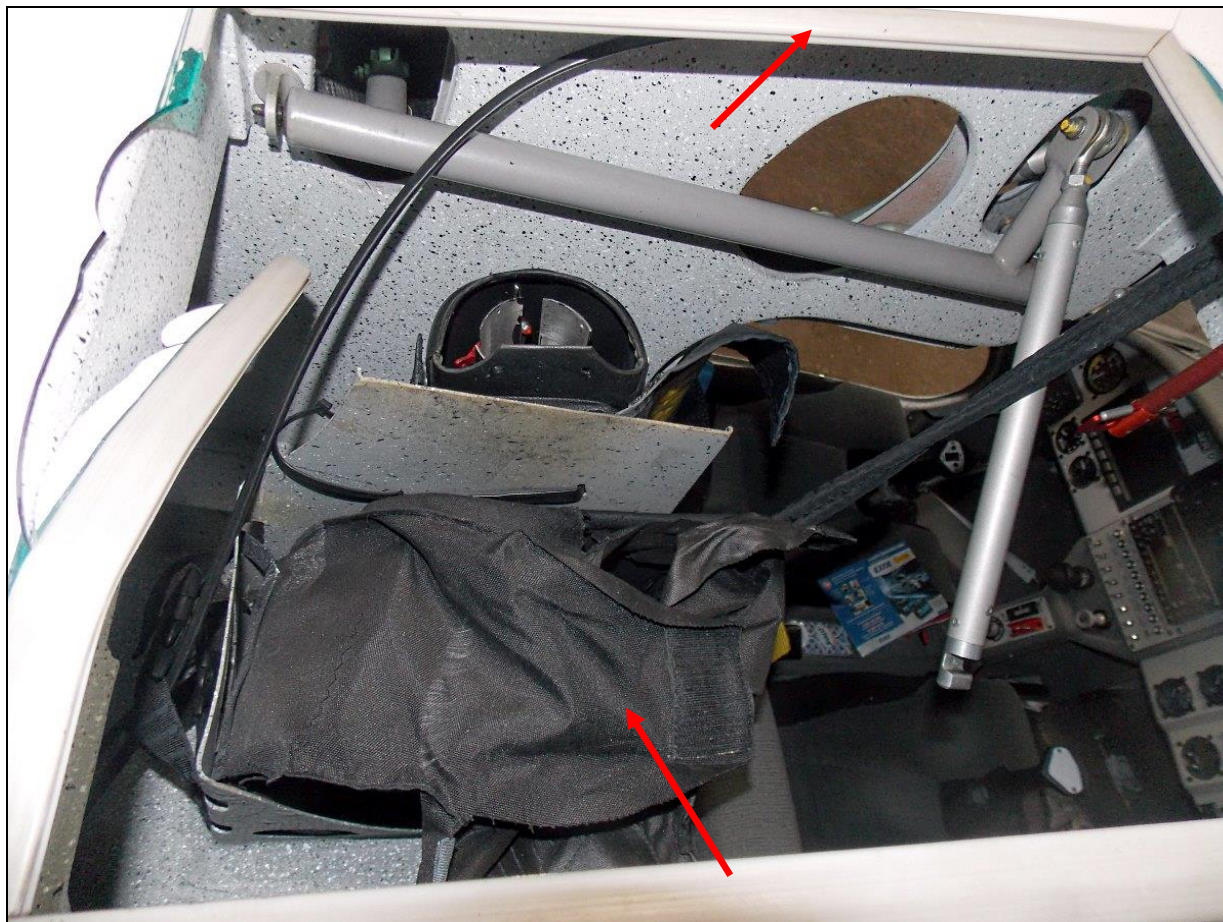
31 – Luk systemu ratowniczego GRS. Widoczny zasobnik spadochronu i uszczelka obramowania pokrywy luku.
