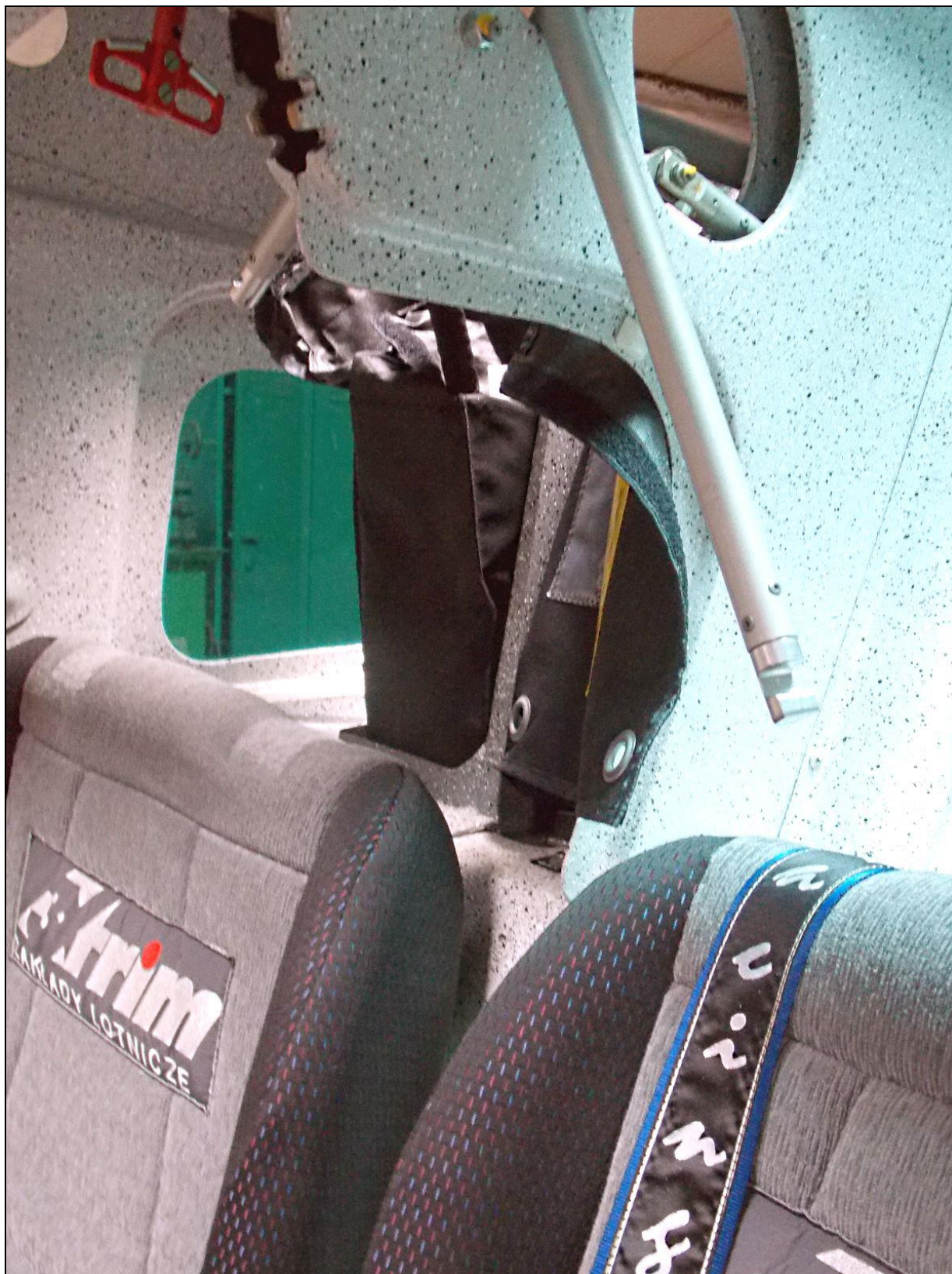
30 – Okolica luku systemu GRS za fotelami. Widoczny uchwyt aktywacji systemu.
