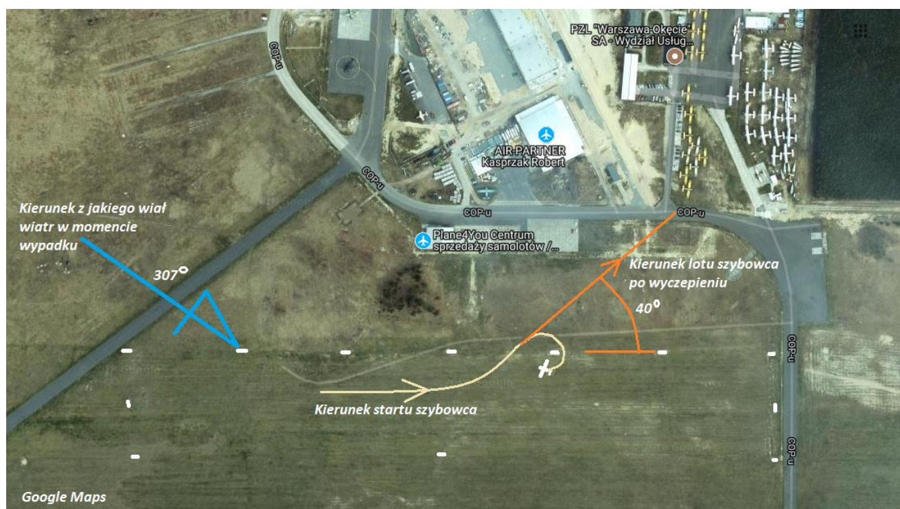
Ilustracja nr 4. Na ilustracji zaznaczono kierunek z jakiego wiał wiatr w momencie startu szybowca. Zaznaczono przybliżoną trajektorię lotu szybowca.
