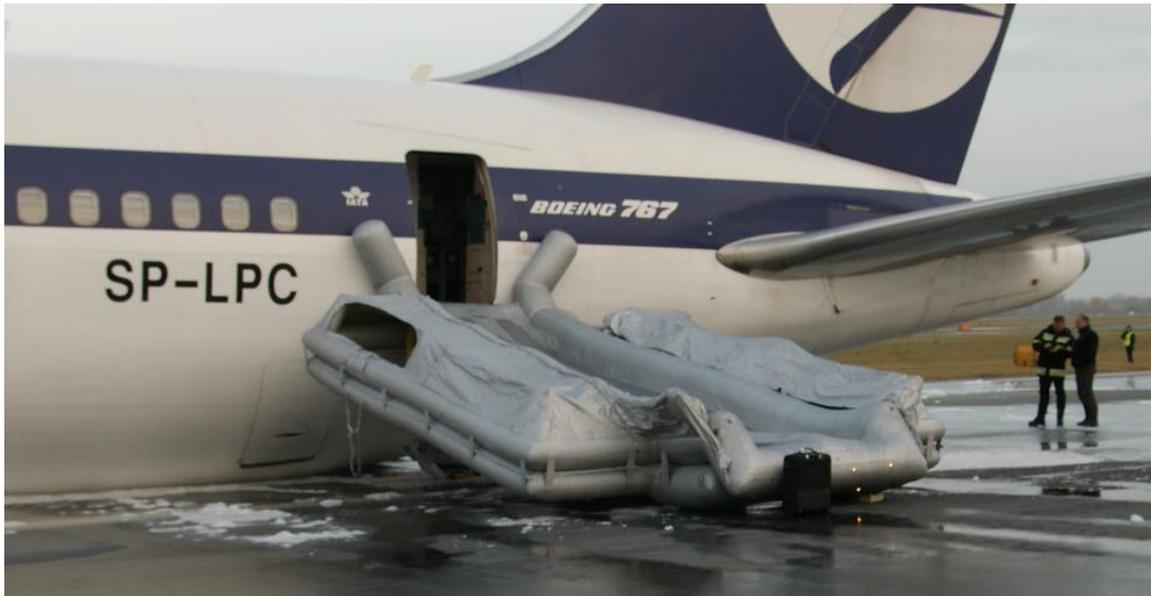
Figure 8. Escape slide at door 3L.
