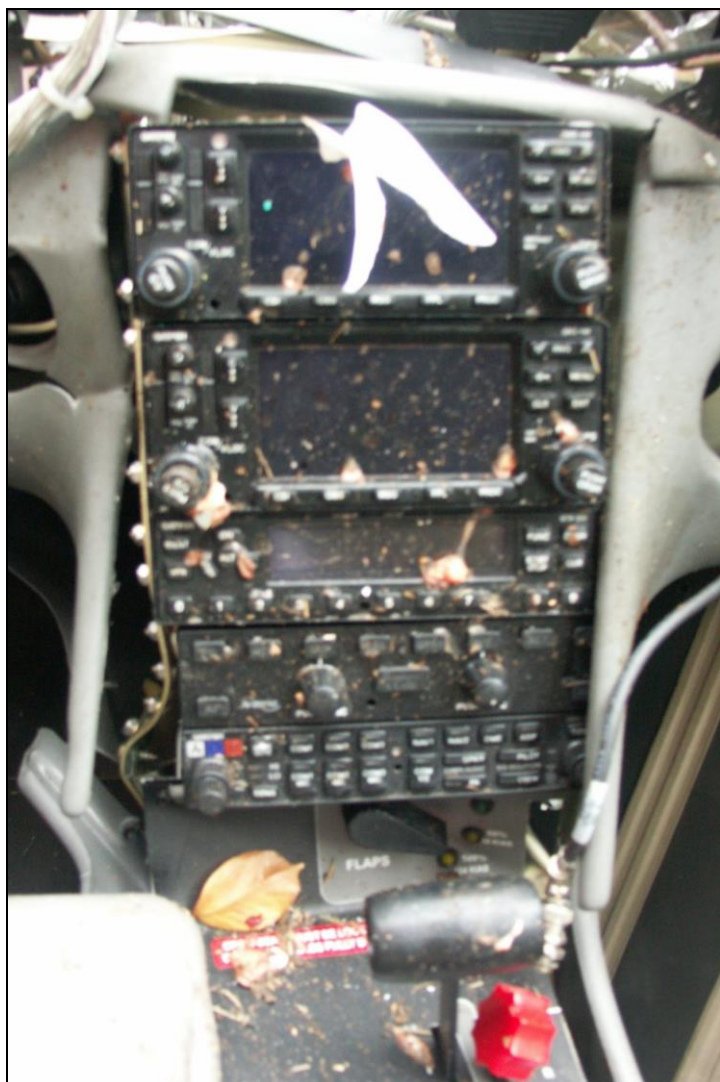
33 – Konsola centralna tablicy przyrządów z wyposażeniem radiowo-nawigacyjnym i elektronicznym (przed wymontowaniem pilota automatycznego). U dołu, na pulpicie środkowym, widoczne manetki sterowania zespołem napędowym.
