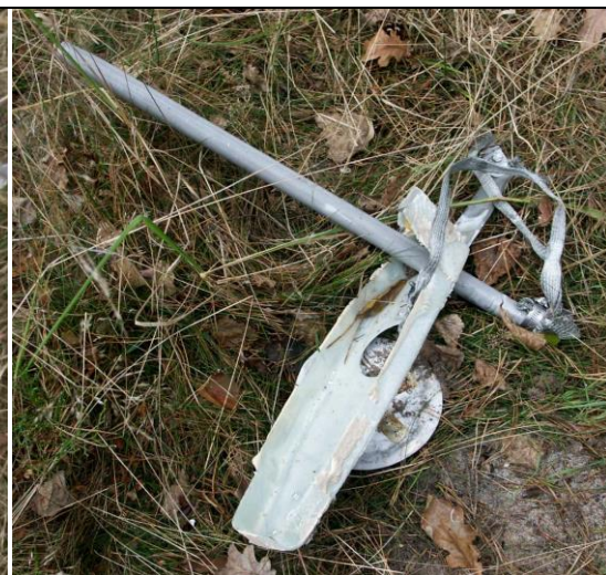
62, 63 – Fragment noska skrzydła z nakładką instalacji przeciwooblodzeniowej oraz jedno z żeberek struktury.
