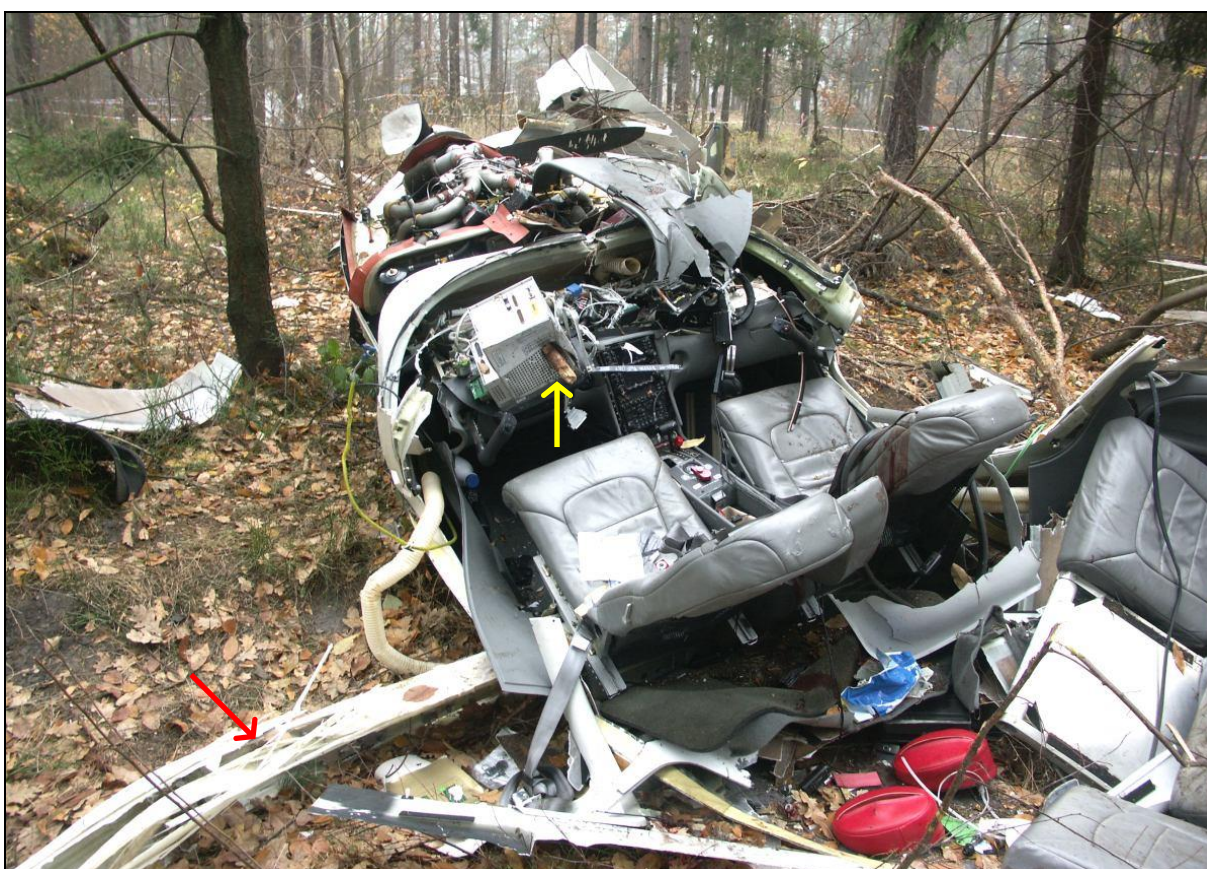
22 – Kabinowa część kadłuba, widok od tyłu. Monitor MFD wymontowany, w pozostawionym monitorze PFD widoczna wbita gałąź (żółta strzałka). Czerwoną strzałką zaznaczona ścianka dźwigara lewego skrzydła.
