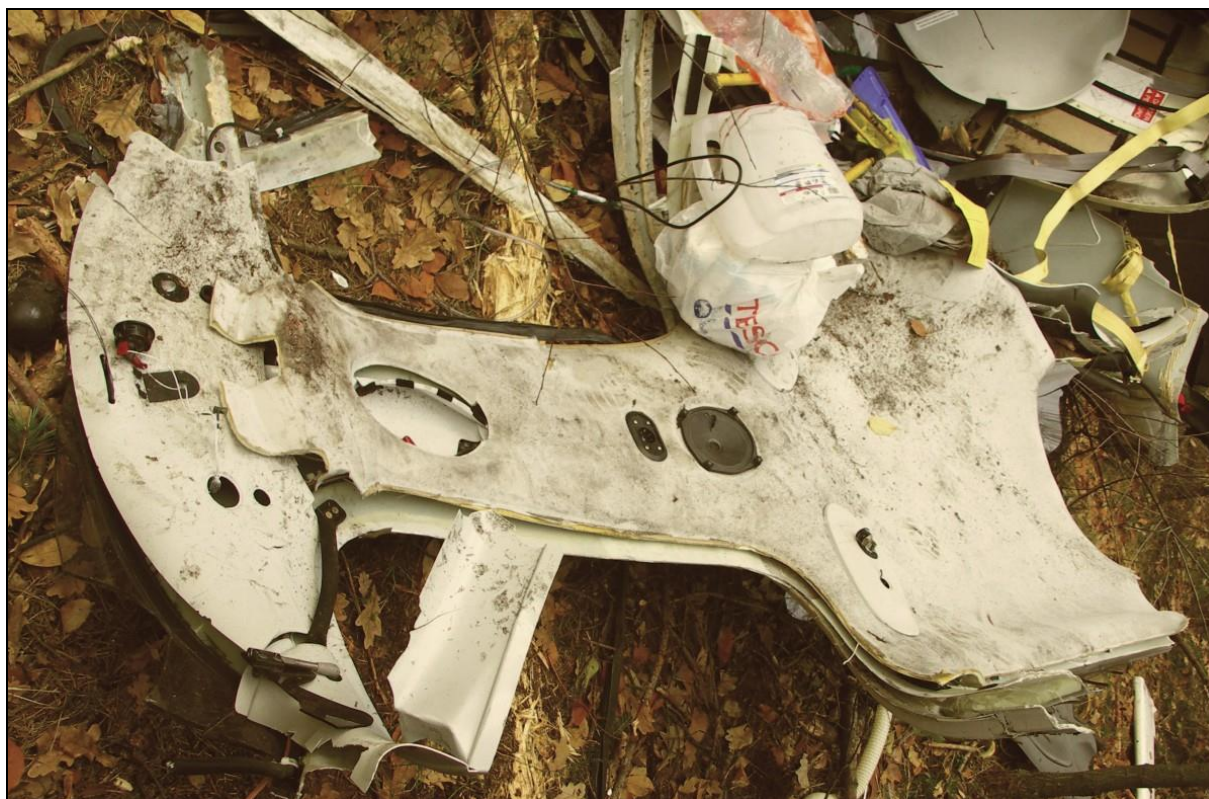
27 – Odcięty podczas akcji ratowniczej dach kabiny, widok od wewnątrz.
