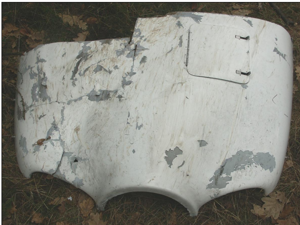
73 – Górna osłona silnika od zewnątrz. Widoczne uszkodzenia i ślady pozostawione przez gałęzie drzew.
