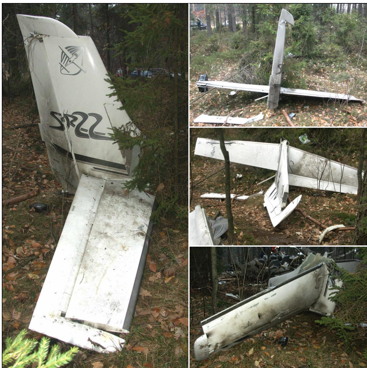
48, 49, 50, 51 – Usterzenie – widoczne osmalenia prawej strony, spowodowane odpaleniem systemu CAPS.
