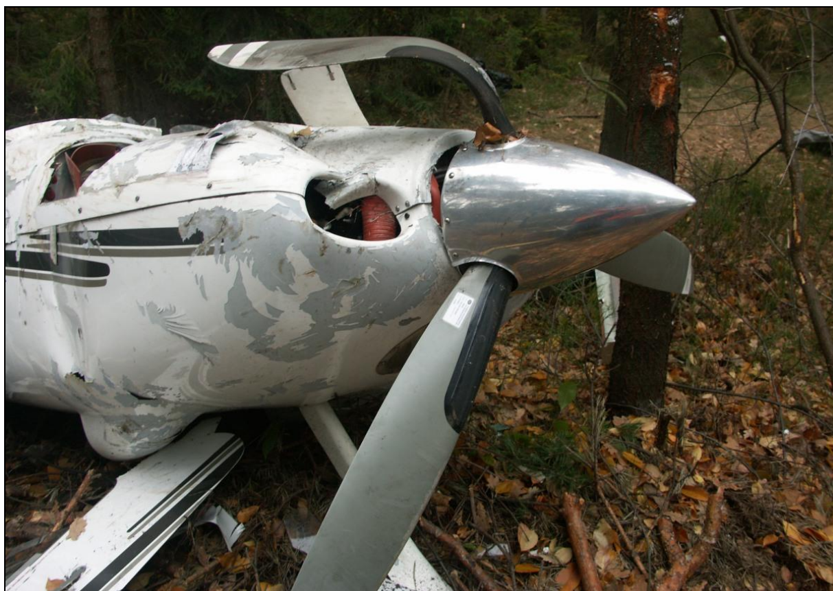
20 – Przód kadłuba samolotu, widok z lewej strony – widoczne śmigło, jedna zgięta łopata i dwie z niewielkimi uszkodzeniami, co świadczy o tym, że śmigło w chwili zderzenia z przeszkodą (drzewem) nie obracało się.
