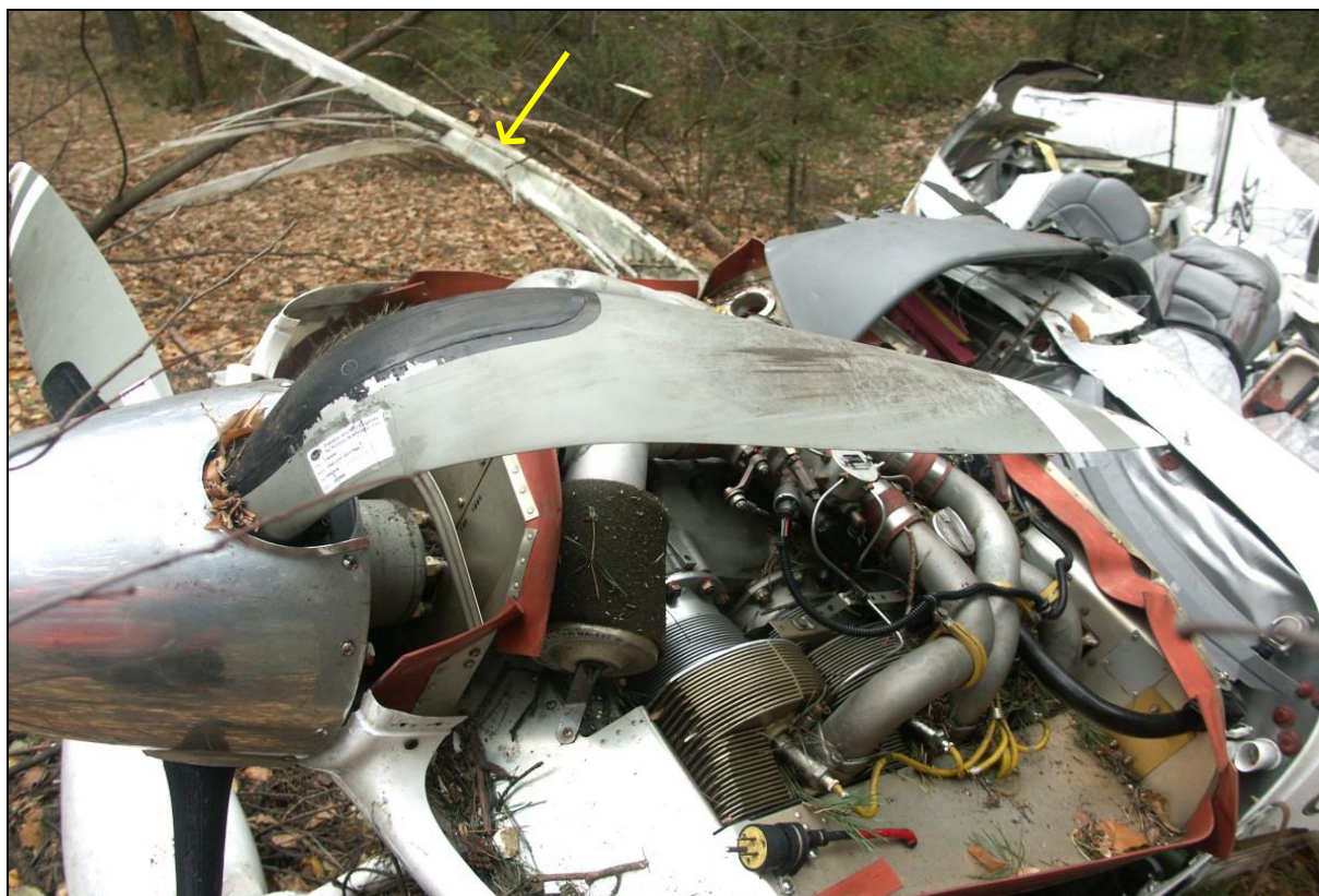
40 – Widok na zespół napędowy z lewej strony, górna osłona zdjęta. Sposób zniszczenia śmigła świadczy o tym, że w chwili kontaktu z przeszkodą (drzewem), nie obracało się. Strzałką wskazana ścianka dźwigara prawego skrzydła.
