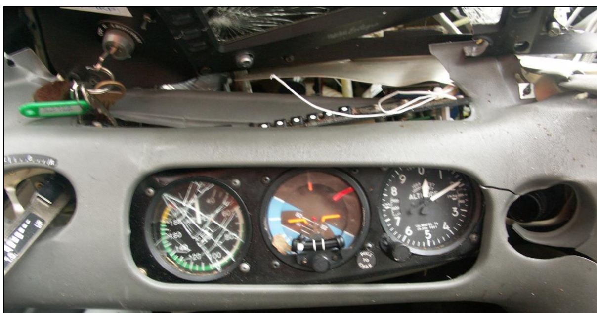
32 – Lewa, dolna, strona tablicy przyrządów. Widoczny prędkościomierz, sztuczny horyzont i wysokościomierz.
