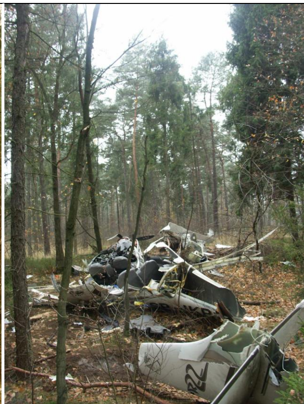
18 – Szczątki kadłuba, dźwigara prawego skrzydła i usterzenia (na pierwszym planie). Widok w kierunku, w przybliżeniu, przeciwnym do kierunku lotu.
