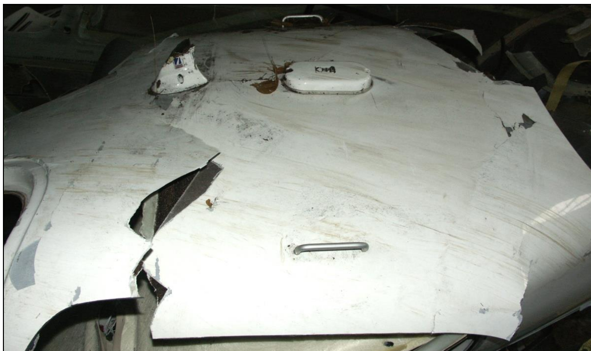
29 – Odcięty podczas akcji ratowniczej dach kabiny, widok od zewnątrz. Zwracają uwagę ślady kontaktu z przeszkodą (drzewem).
