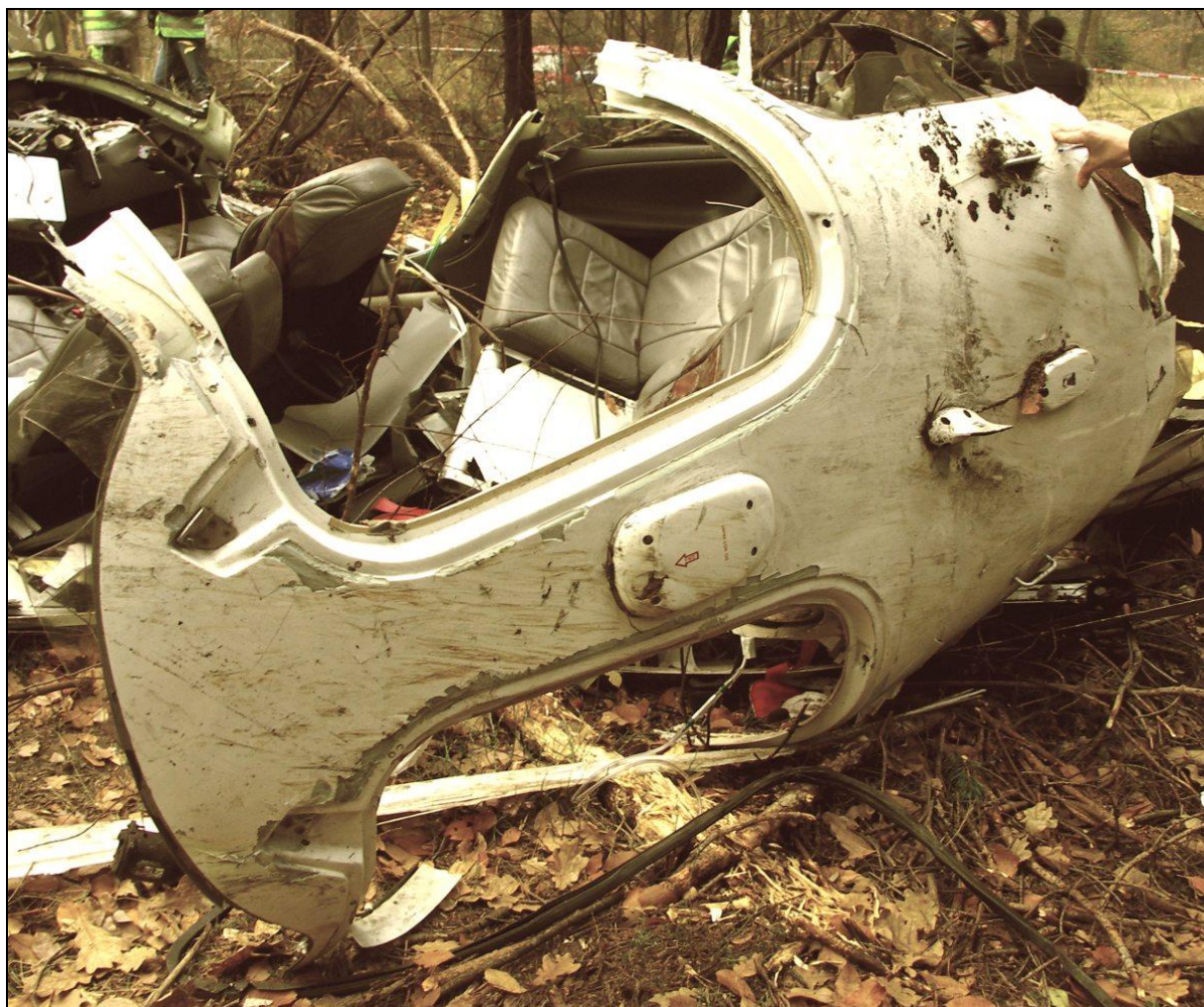
28 – Odcięty podczas akcji ratowniczej dach kabiny, widok od zewnątrz. Zwracają uwagę ślady kontaktu z przeszkodą (drzewem).
