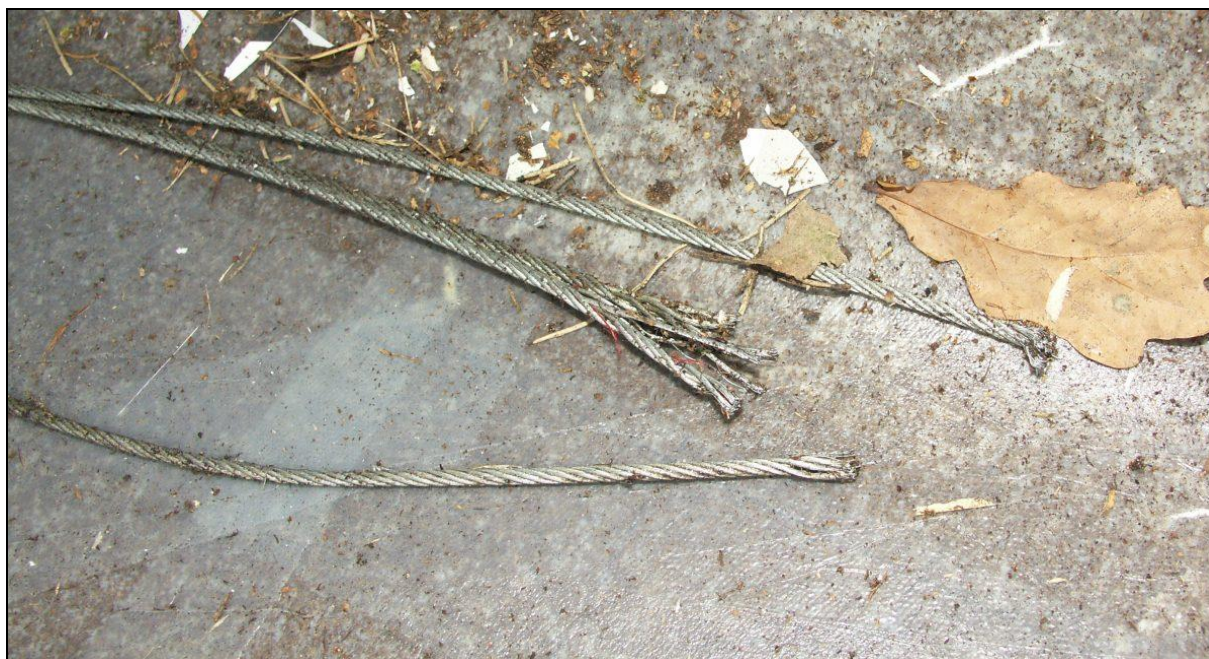
25 – Linki napędu sterów w tylnej części kadłuba, przecięte podczas akcji ratowniczej.
