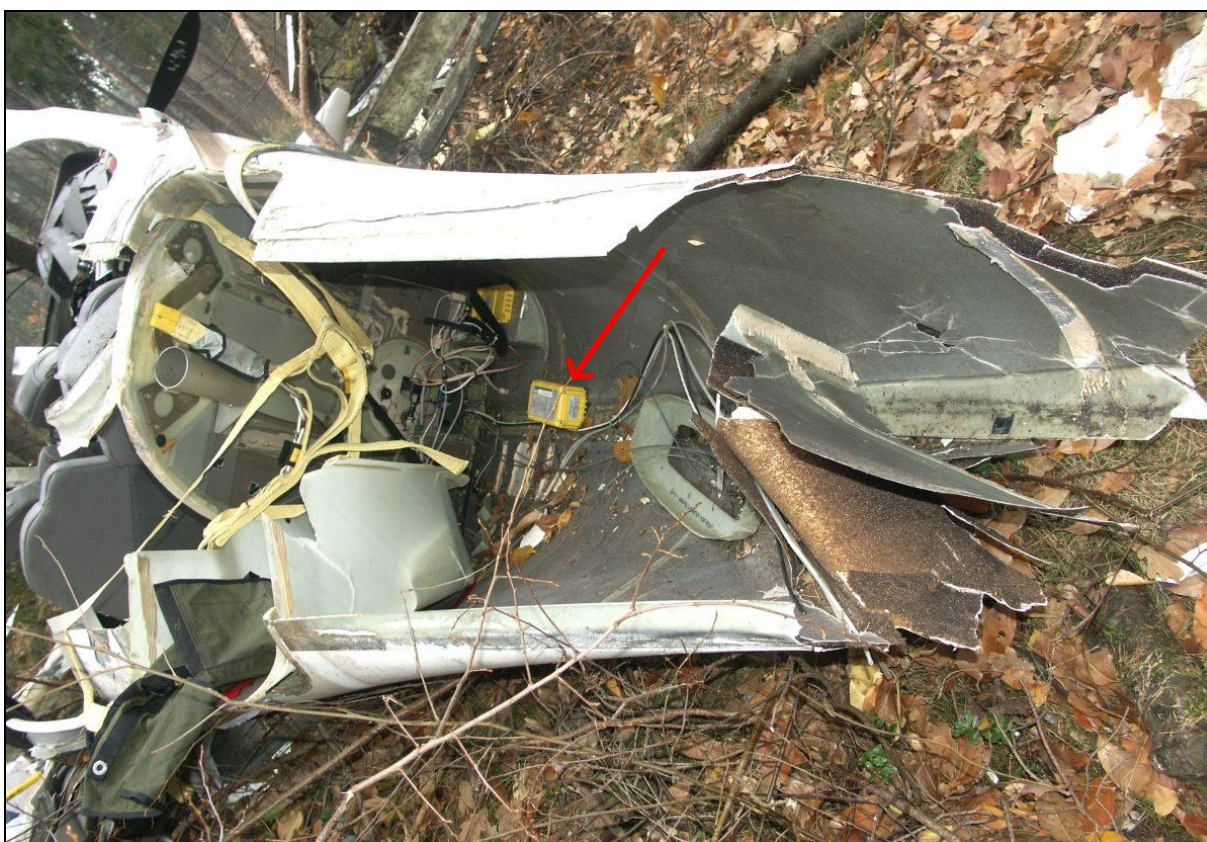
24 – Tylna część kadłuba. Widoczne jasnożółte taśmy spadochronowego systemu ratowniczego CAPS i ratowniczy nadajnik lokalizacyjny ELT, oznaczony czerwoną strzałką.
