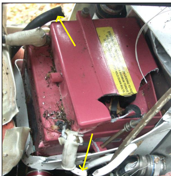
44 – Rozbity akumulator. Strzałkami wskazane obcięte podczas akcji ratowniczej przewody.
