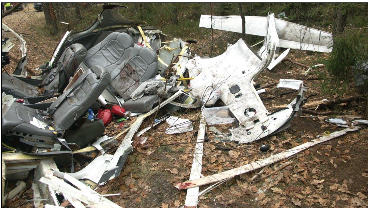
23 – Kabinowa część kadłuba, widok z lewej strony. Obok dach kabiny, odcięty podczas akcji ratowniczej. Na dalszym planie usterzenie, również oddzielone podczas akcji ratowniczej.
