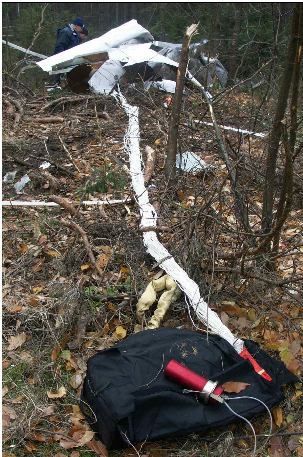
36 – Spadochron systemu ratowniczego CAPS, wystrzelony wskutek odkształceń konstrukcji na ostatnim odcinku drogi przemieszczania się kadłuba po ziemi.
