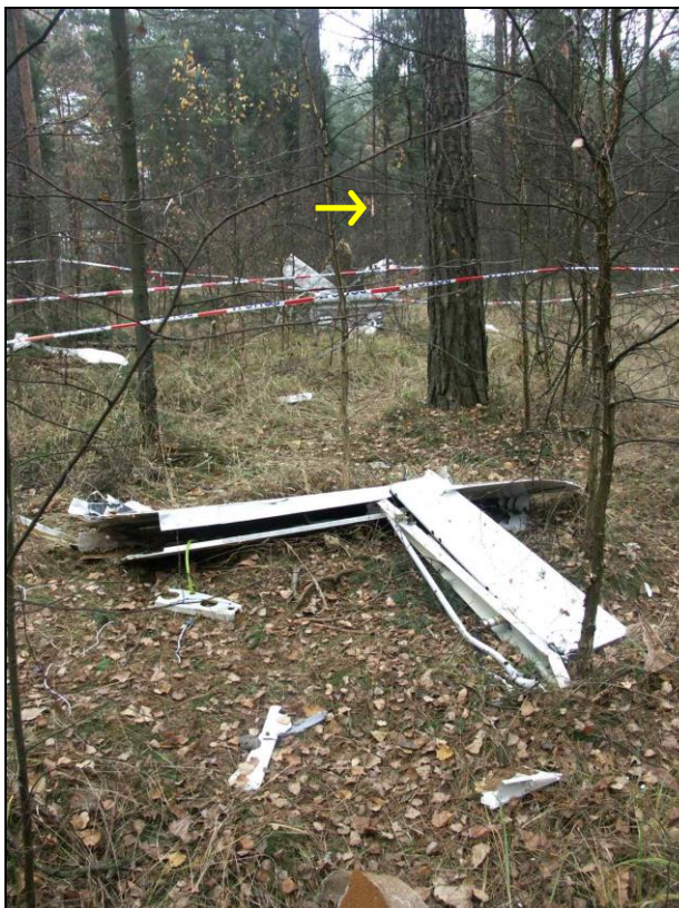
15 – Szczątki lewego skrzydła w pobliżu miejsca pierwszego zderzenia z drzewami – końcówka skrzydła z lotką. Strzałką oznaczone uszkodzone drzewo.
