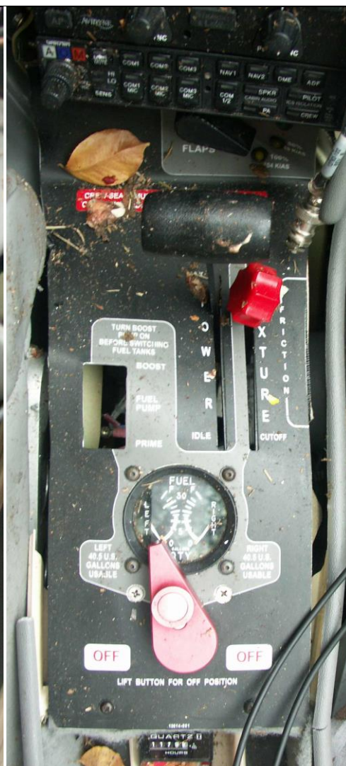
34 – Pulpit środkowy z manetkami sterowania zespołem napędowym, paliwomierzem, pokrętkiem przełącznika zaworu paliwowego i licznikiem czasu pracy płatowca.
