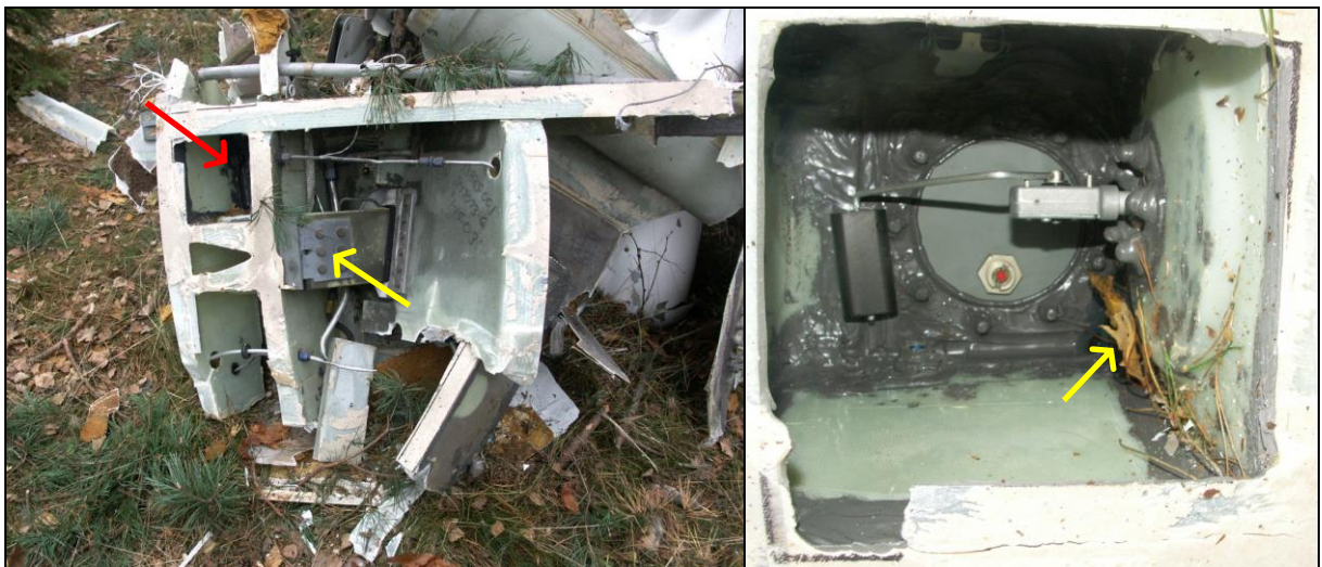
54, 55 – Szczątki nasadowej i części lewego skrzydła – żółtą strzałką wskazane mocowanie goleni podwozia, czerwoną – paliwowy zbiornik rozchodowy; na fot.56 widoczne wnętrze zbiornika rozchodowego w zbliżeniu, strzałką wskazane miejsce, gdzie stwierdzono obecność śladów paliwa w zanieczyszczeniach z podłoża.
