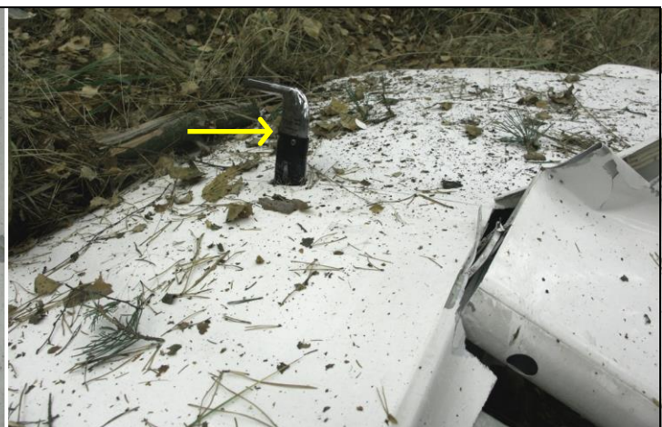
57 – Szczątki końcowej części lewego skrzydła. Widoczna rurka Pitota (wskazana strzałką) i odłamana lotka.
