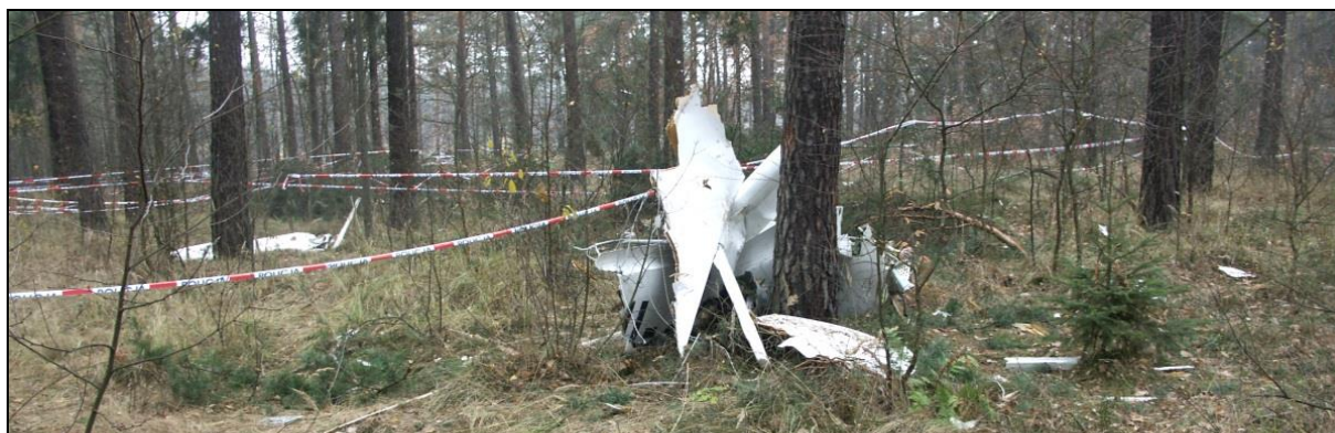
14 – Szczątki prawego skrzydła w pobliżu miejsca pierwszego zderzenia z drzewami. Widok w kierunku, w przybliżeniu, prostopadłym do kierunku lotu samolotu.
