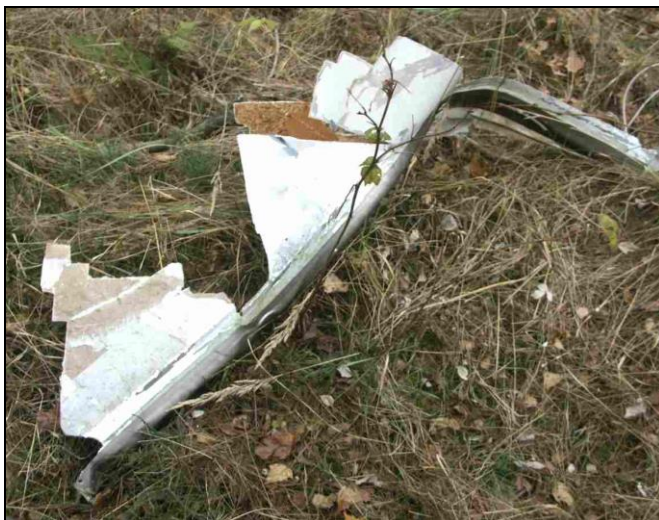
62, 63 – Fragment noska skrzydła z nakładką instalacji przeciwooblodzeniowej oraz jedno z żeberek struktury.
