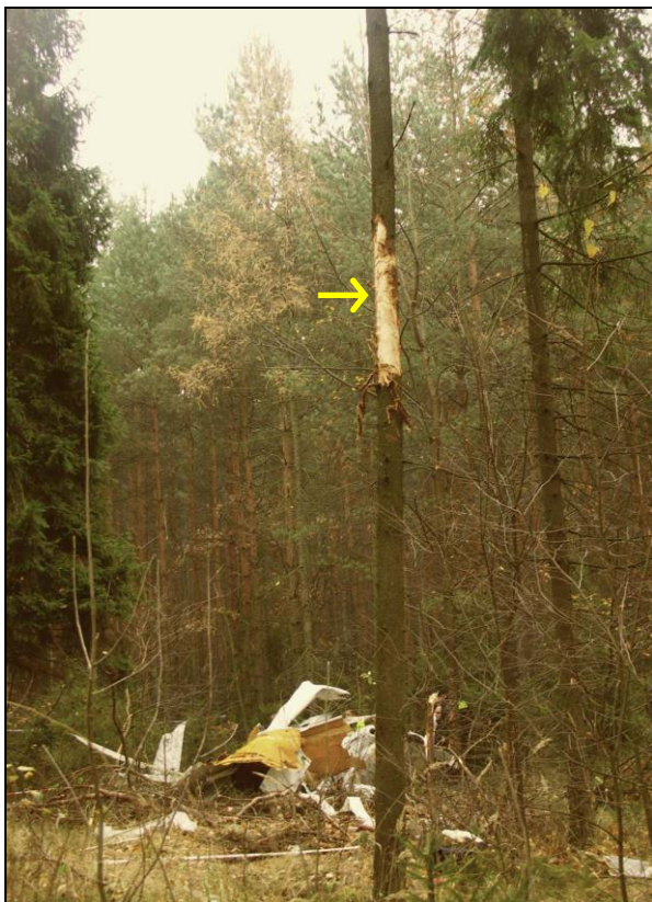
17 – Wrak samolotu na miejscu upadku – widok w kierunku lotu. Na pierwszym planie oznaczone strzałką drzewo uderzone prawdopodobnie łopatą śmigła.
