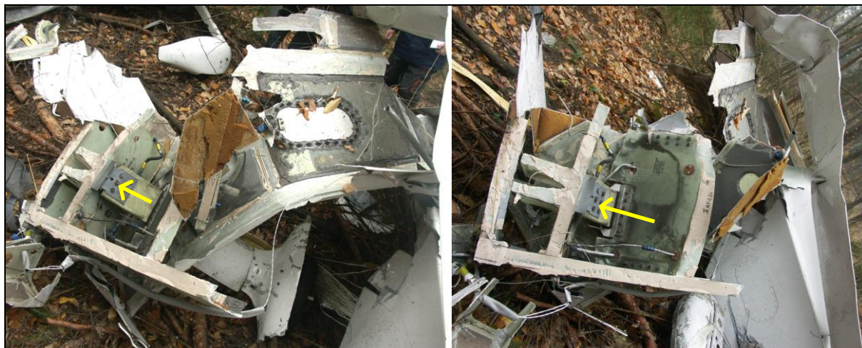
66, 67 – Szczątki nasadowej i środkowej części prawego skrzydła. Strzałką wskazane mocowanie goleni podwozia.
