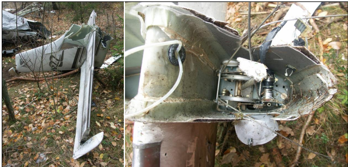
46, 47 – Usterzenie ogonowe, odcięte z końcówką kadłuba podczas akcji ratowniczej i zbliżenie na miejsca rozcięcia – widoczne przecięte linki napędu sterów.
