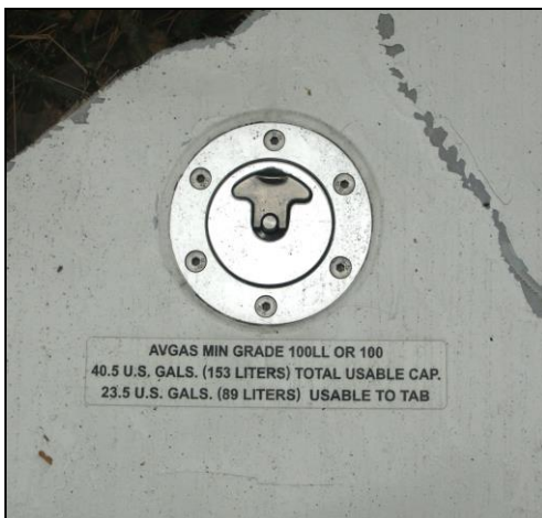
56 – Szczątki nasadowej i środkowej części lewego skrzydła – wlew paliwa.
