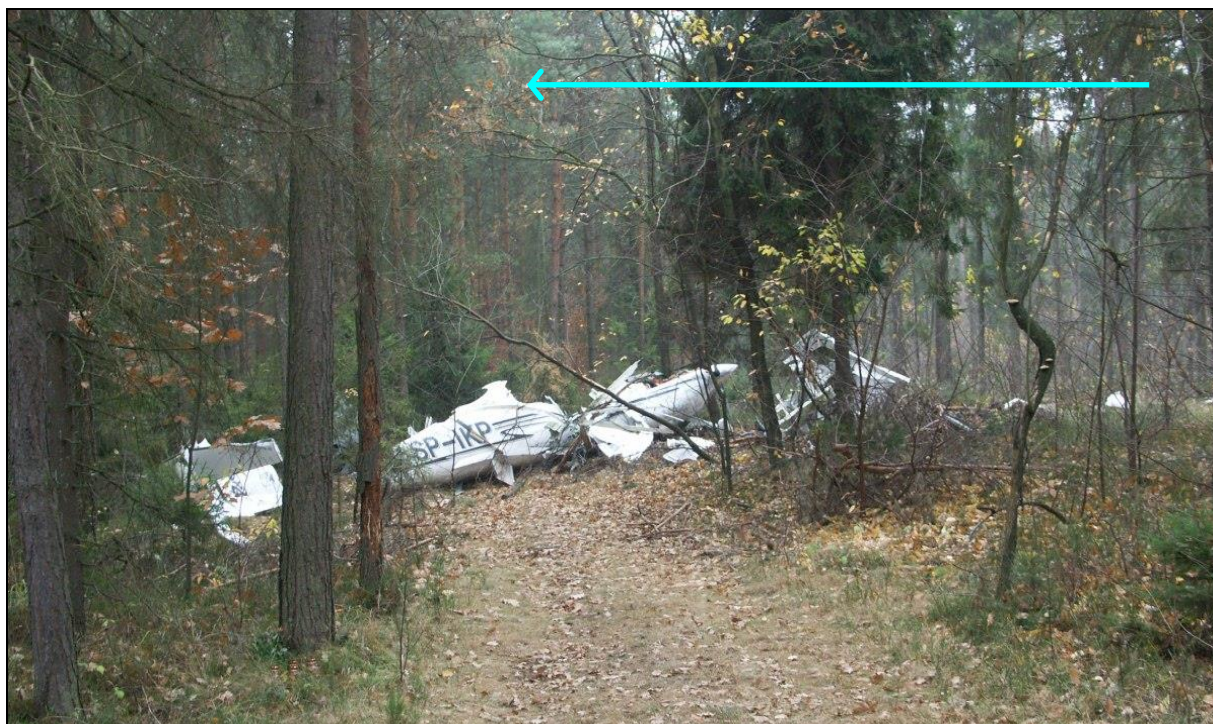
19 – Szczątki kadłuba, prawego skrzydła i usterzenia widziane z lewej strony ich trajektorii (kierunek przemieszczania się samolotu w trakcie niszczenia zaznaczony niebieską strzałką).
