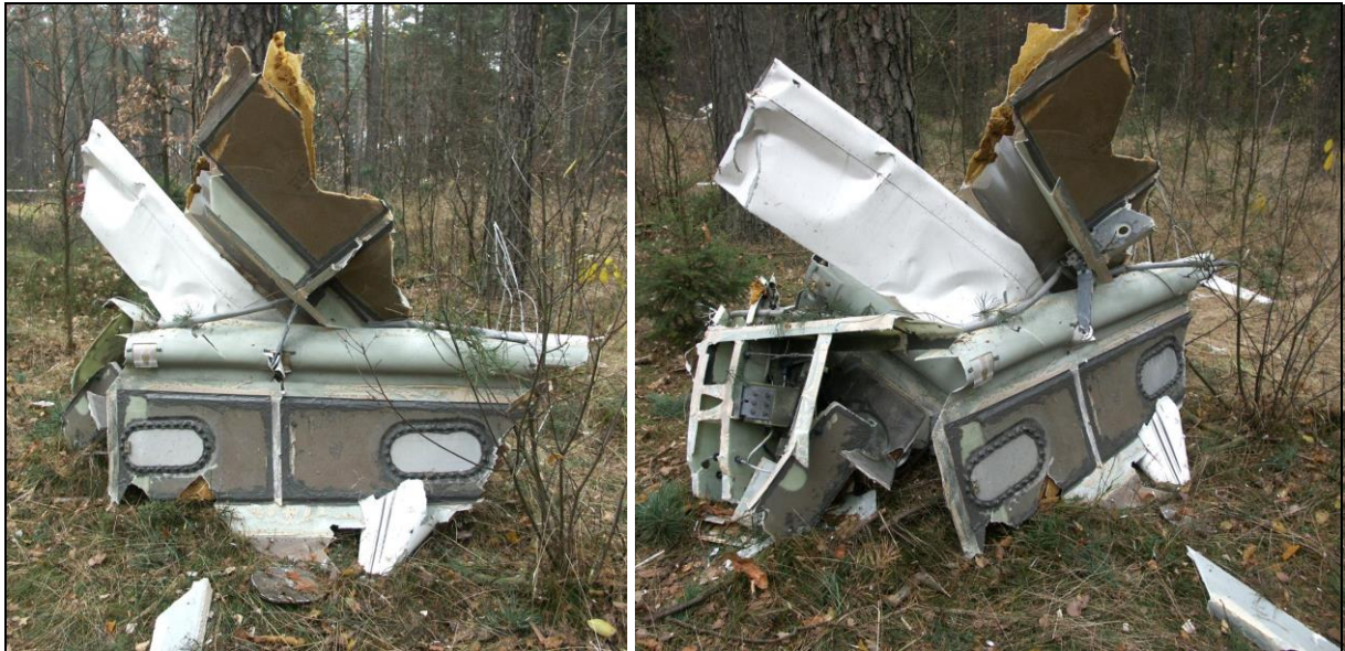
52, 53 – Szczątki nasadowej i środkowej części lewego skrzydła owinięte wokół drzewa, w które skrzydło to uderzyło – na zdjęciach widoczna strefa paliwowego zbiornika integralnego.
