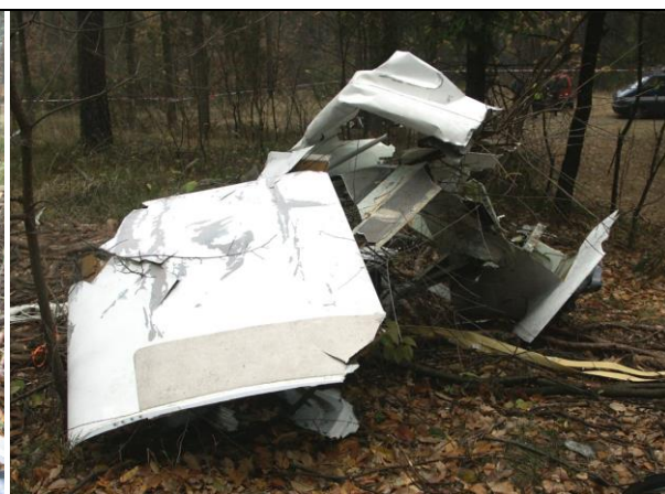
62, 63 – Fragment noska skrzydła z nakładką instalacji przeciwooblodzeniowej oraz jedno z żeberek struktury.
