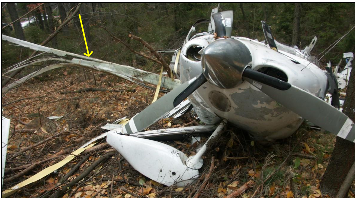
21 – Przód kadłuba samolotu, widok od czola samolotu – widoczne śmigło, jedna zgięta łopata i dwie z niewielkimi uszkodzeniami, co świadczy o tym, że śmigło w chwili zderzenia z przeszkodą (drzewem) nie obracało się. Strzałką zaznaczona ścianka dźwigara prawego skrzydła.
