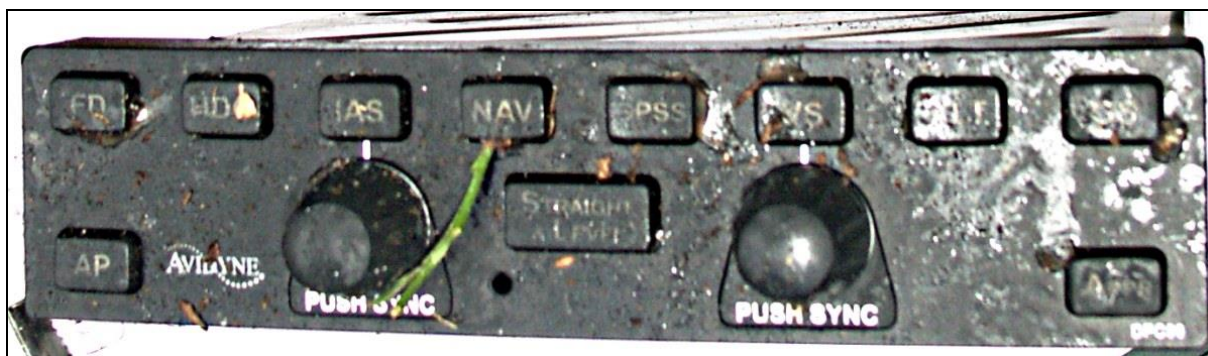
35 – Pulpit sterowania pilotem automatycznym, wymontowany z konsoli centralnej tablicy przyrządów.
