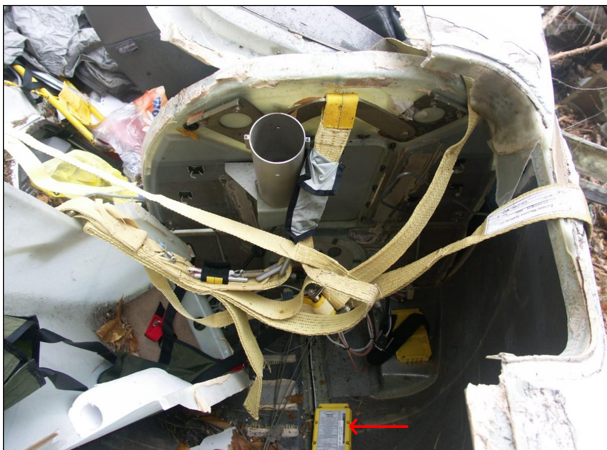
26 – Tylna część kadłuba. Widoczne jasnożółte taśmy spadochronowego systemu ratowniczego CAPS, rurowa wyrzutnia rakiety wyciągającej spadochron ratowniczy i ratowniczy nadajnik lokalizacyjny ELT (zaznaczony czerwoną strzałką).
