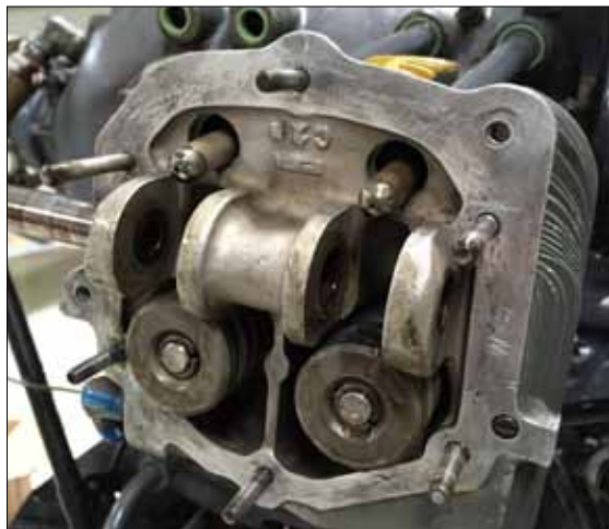
Po lewej - po zdemontowaniu pokrywy zaworowej i jednej dźwigniki zaworowej widać popychacz i sprężyny zaworowe. Po prawej - zespół głowicy po wyczyszczeniu i ponownym montażu.
