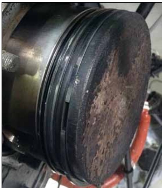
Po lewej - tłok po zdjęciu głowicy. Widać pierścienie - dwa pierwsze „kompresyjne” i trzeci, najbardziej z lewej, zbierający olej, uszczelniający. Zwraca uwagę nagar na górnej powierzchni tłoka. Po prawej - ten sam tłok po wyczyszczeniu, podczas montażu.
