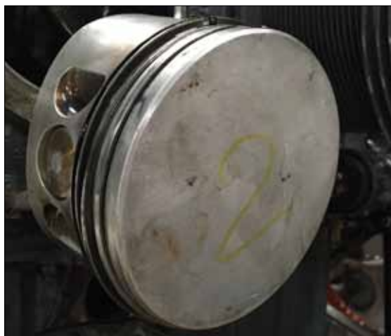
Po lewej - tłok po zdjęciu głowicy. Widać pierścienie - dwa pierwsze „kompresyjne” i trzeci, najbardziej z lewej, zbierający olej, uszczelniający. Zwraca uwagę nagar na górnej powierzchni tłoka. Po prawej - ten sam tłok po wyczyszczeniu, podczas montażu.
