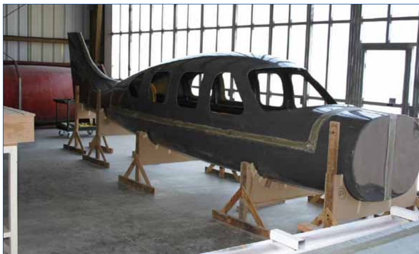
Po wylaminowaniu elementów kadłuba, wyjęciu ich z form i wstępnej obróbce kadłub jest sklejaný.
