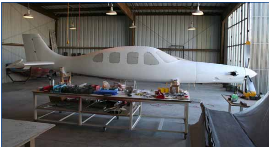
Po wylaminowaniu elementów kadłuba, wyjęciu ich z form i wstępnej obróbce kadłub jest sklejaný.
