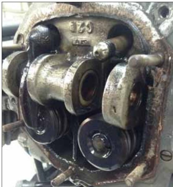
Po lewej - po zdemontowaniu pokrywy zaworowej i jednej dźwigniki zaworowej widać popychacz i sprężyny zaworowe. Po prawej - zespół głowicy po wyczyszczeniu i ponownym montażu.
