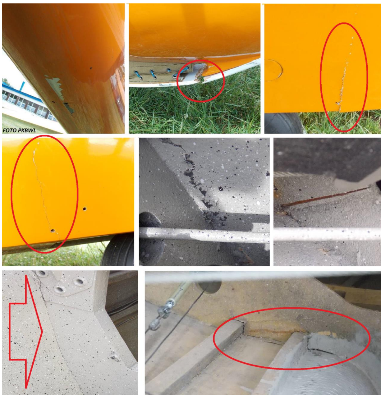
Ilustracje nr 1. Na ilustracji pokazano uszkodzone elementy szybowca.
