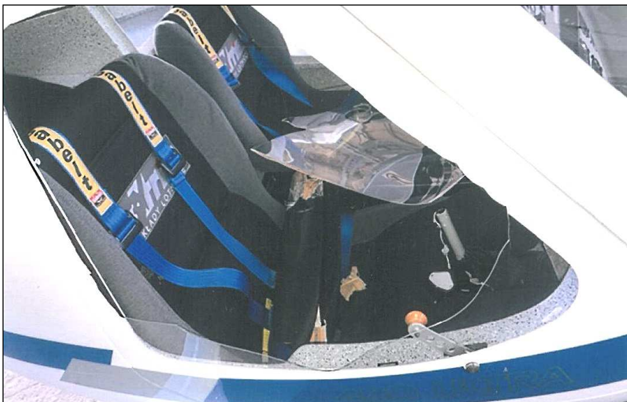
4 – Zniszczone oszklenie prawych drzwi.
