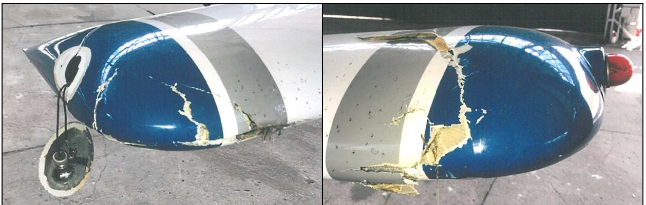
7, 8 – Uszkodzenia końcówek skrzydeł.
