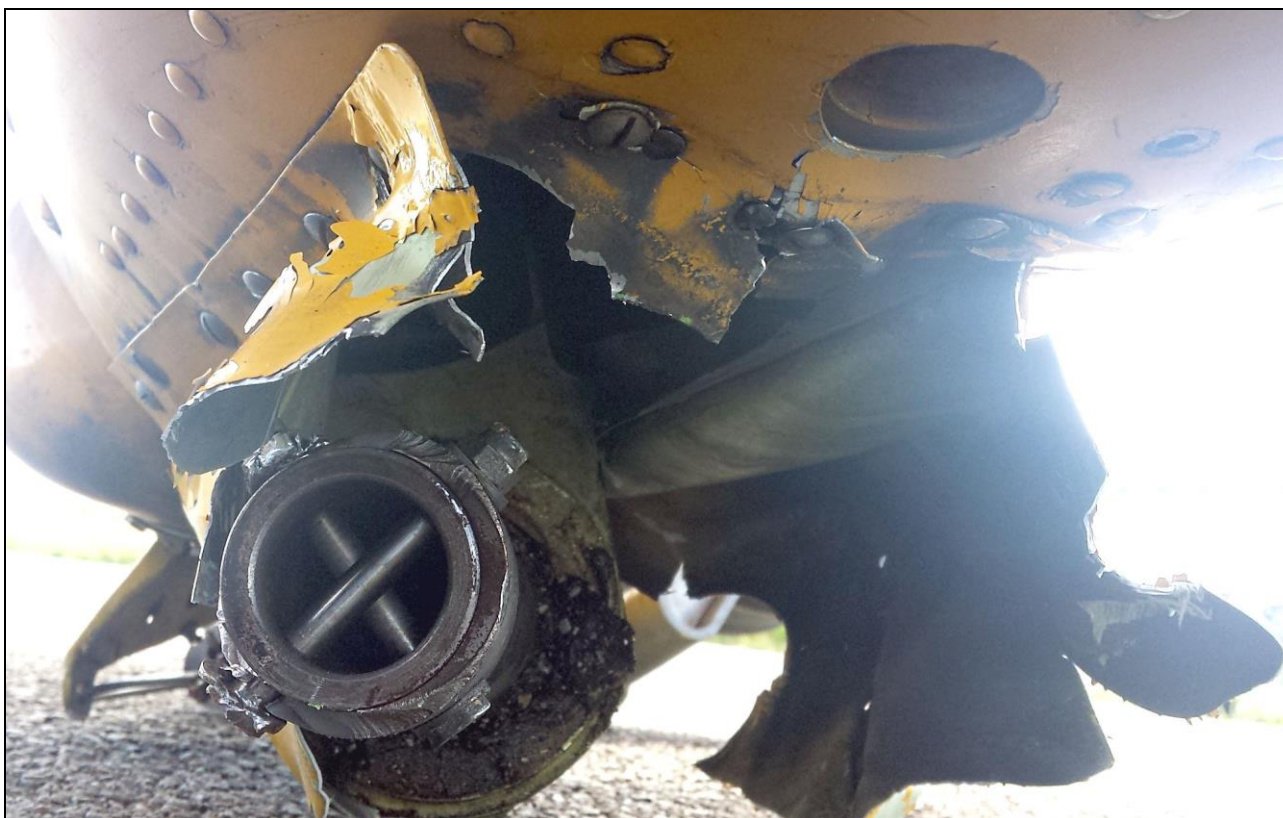
Uszkodzenia pokryw kadłuba w najbliższym sąsiedztwie zamocowania podwozia tylnego.
