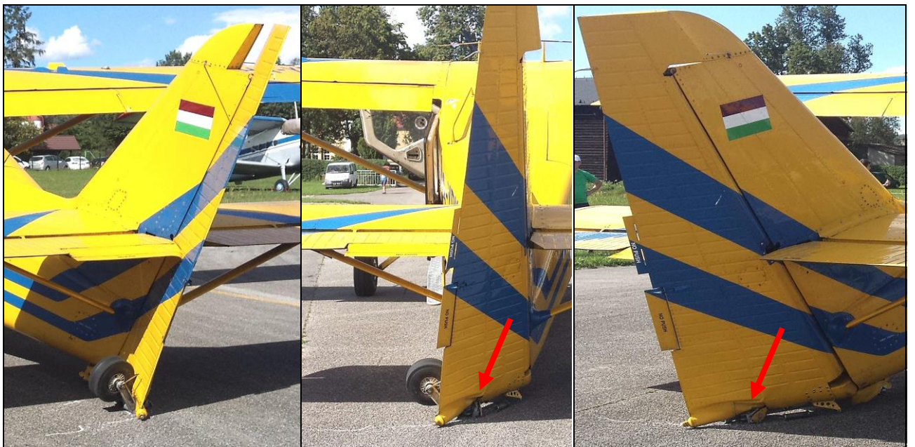
Zbliżenia na tylną część kadłuba i usterzenie, widoczne uszkodzenie steru kierunku.
