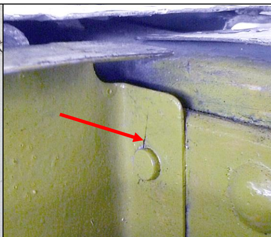
13 – Pęknięcie na żebrze nasadowym skrzydła lewego w tylnym mocowaniu do dźwigara pomocniczego – górny nit.
