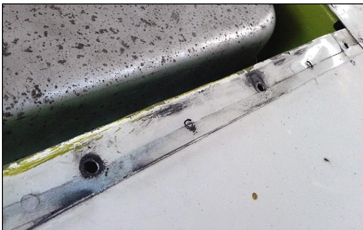
12 – Obluzowane nity na dźwigarku tylnym skrzydła prawego (na górze i na dole) w części nasadowej.
