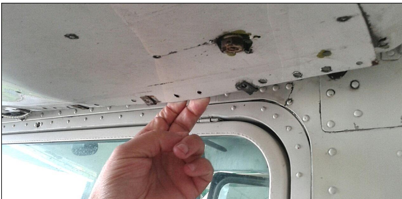
5 – Brak integralności poszycia dolnego na żebrze nasadowym skrzydła lewego; przetarcie poszycia, obluzowane nity.
