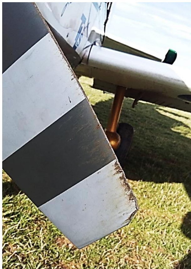
Rys.1. Zdjęcia uszkodzonej nawierzchni pasa startowego, po lewej oraz uszkodzonej końcówki łopaty śmigła, po prawej. [foto STL Świebodzice]
