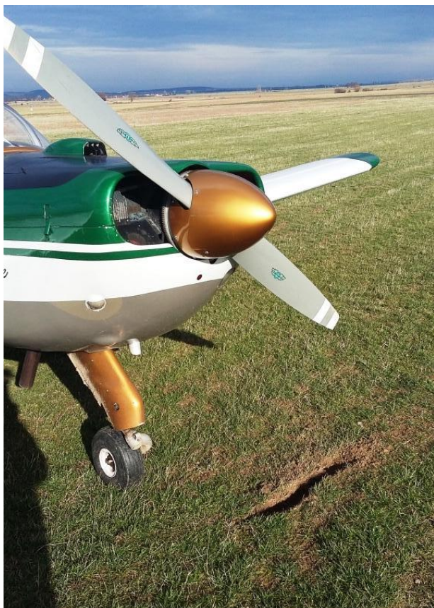
Rys.1. Zdjęcia uszkodzonej nawierzchni pasa startowego, po lewej oraz uszkodzonej końcówki łopaty śmigła, po prawej. [foto STL Świebodzice]
