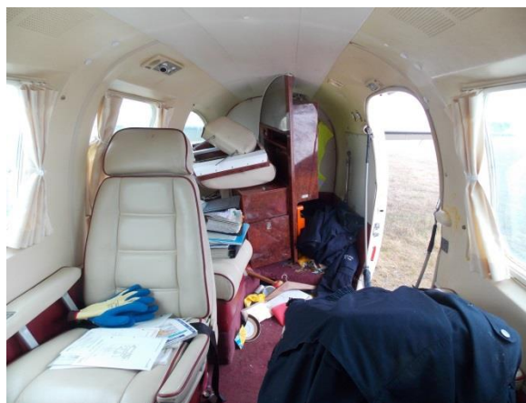
Rys. 9. Kabina pasażerska po wypadku. Zdjęcie po lewej, widok do przodu – brak oparcia fotela pilota wyciętego podczas akcji ratowniczej. Zdjęcie po prawej, widok do tyłu.
