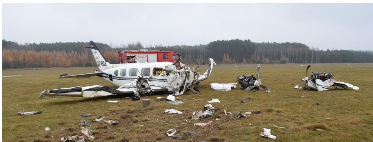
Rys.5. Samolot na miejscu zdarzenia bezpośrednio po wypadku. Po prawej silniki, bliżej samolotu silnik prawy, dalej silnik lewy.[foto Policja]
