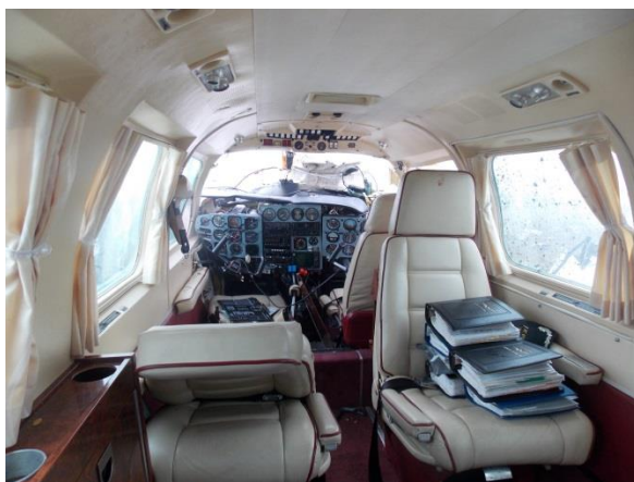
Rys. 9. Kabina pasażerska po wypadku. Zdjęcie po lewej, widok do przodu – brak oparcia fotela pilota wyciętego podczas akcji ratowniczej. Zdjęcie po prawej, widok do tyłu.
