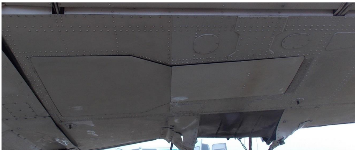
Rys.11. Stan prawego podwozia głównego po wypadku - „podwozie schowane”, obie osłony gondoli podwozia „zamknięte”.
