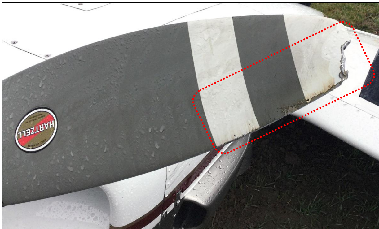
8 – Uszkodzona końcówka łopaty prawego śmigła.
