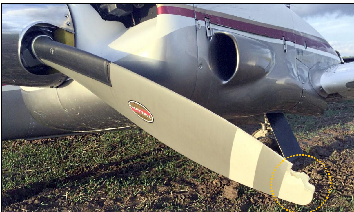
6 – Uszkodzona końcówka łopaty lewego śmigła.
