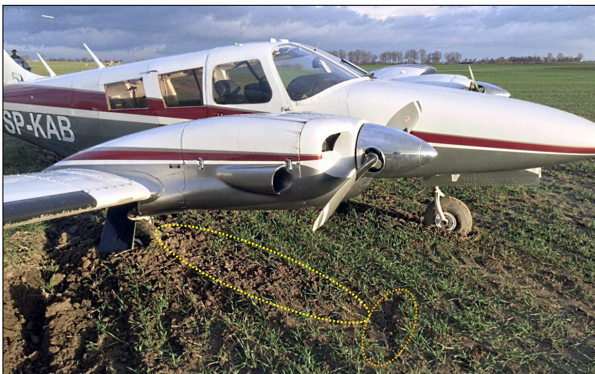
2 – Samolot po wytoczeniu się poza próg drogi startowej, widok \frac{3}{4} od przodu z prawej - zbliżenie. Widoczne ugrzęźnięte koła podwozia oraz ślad łopat śmigła na powierzchni.
