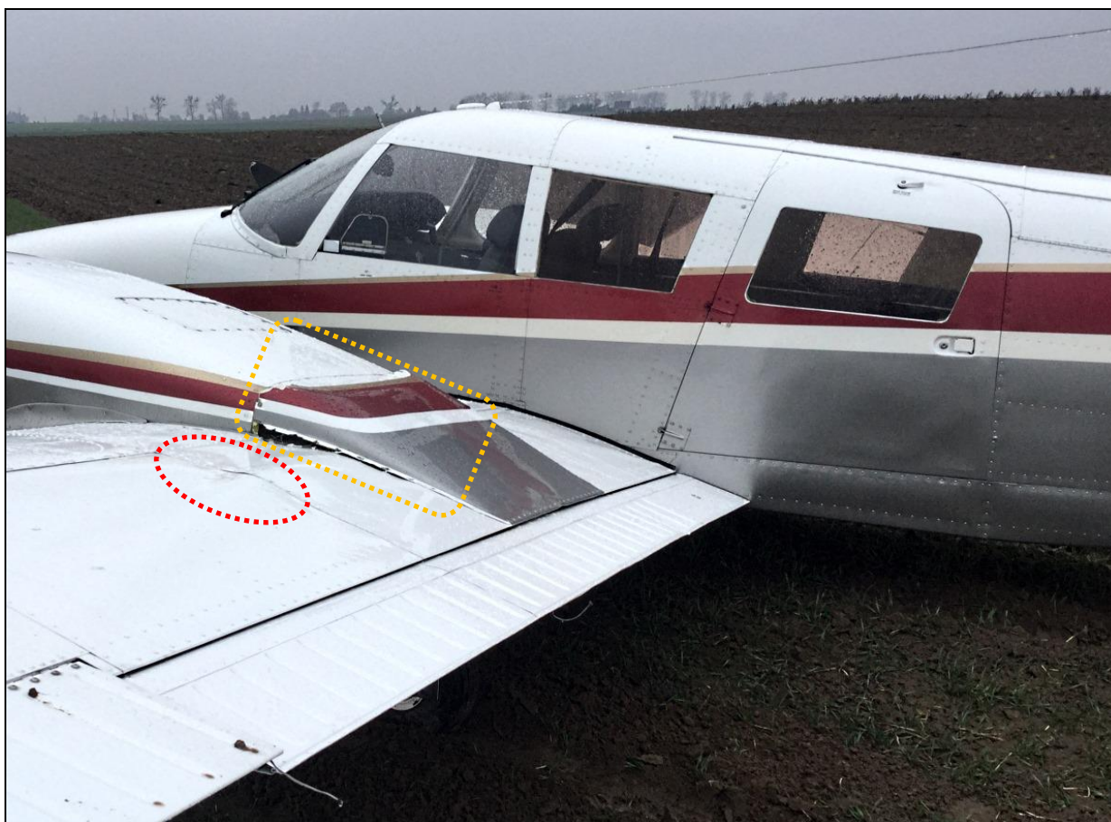
4 – Samolot po wytoczeniu się poza próg drogi startowej, zbliżenie z lewej strony. Widoczne zewnętrzne uszkodzenia tylnej części gondoli lewego silnika (oznaczenia pomarańczowe) i skrzydła (oznaczenia czerwone).
