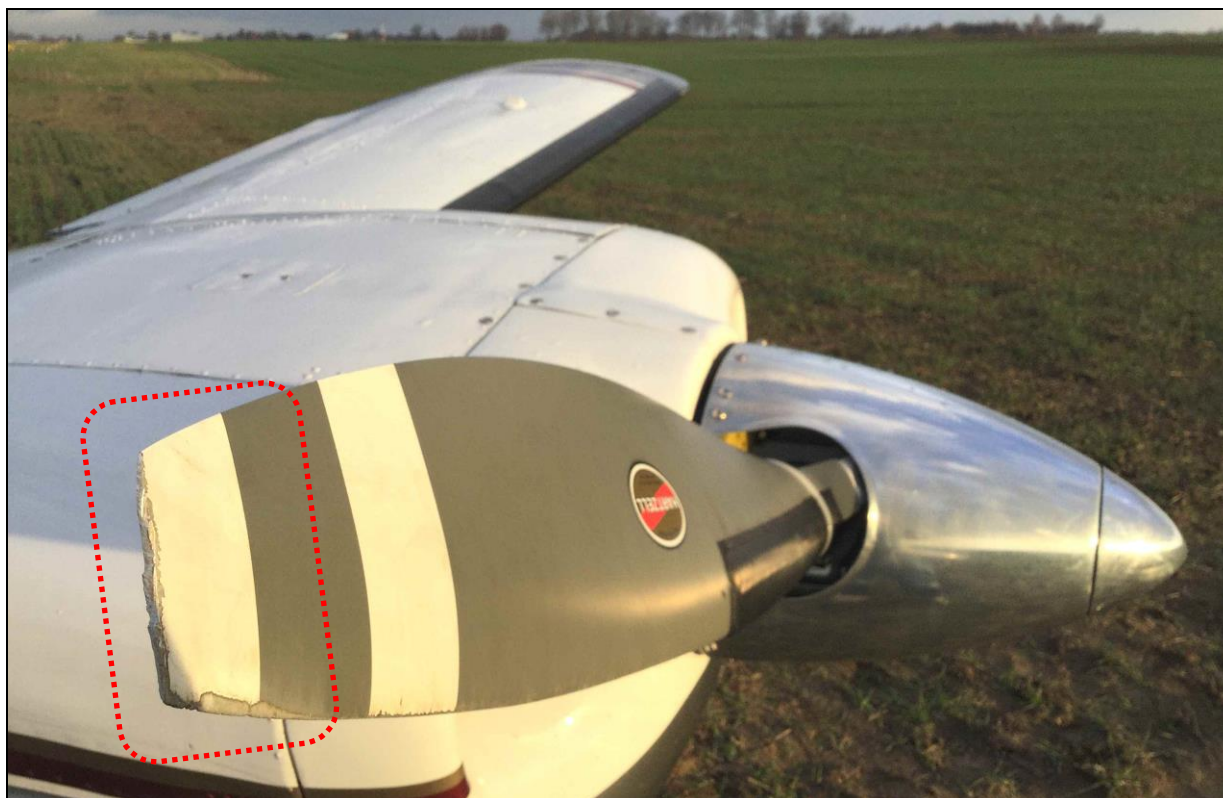
7 – Uszkodzona końcówka łopaty lewego śmigła.
