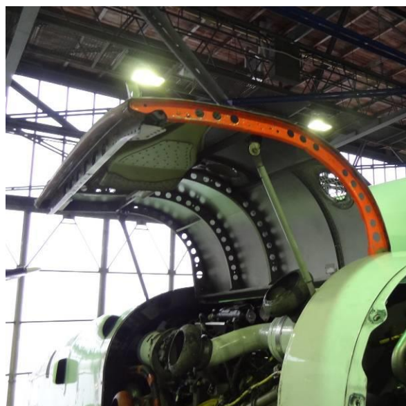
Rys.10. i 11. Oznakowanie farbą odblaskową skrajnych węg drzewi górnych godoli silnikowej.
