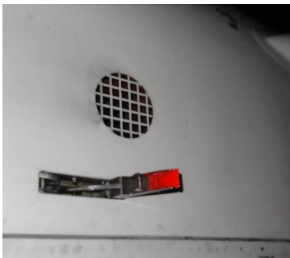
Rys.8. Wewnętrzna strona klamki oznakowana farbą odblaskową
