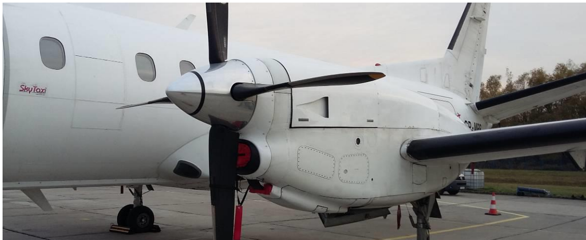
Rys. 5. Przykład nieprawidłowo zamkniętych górnych drzwi gondoli silnikowej
