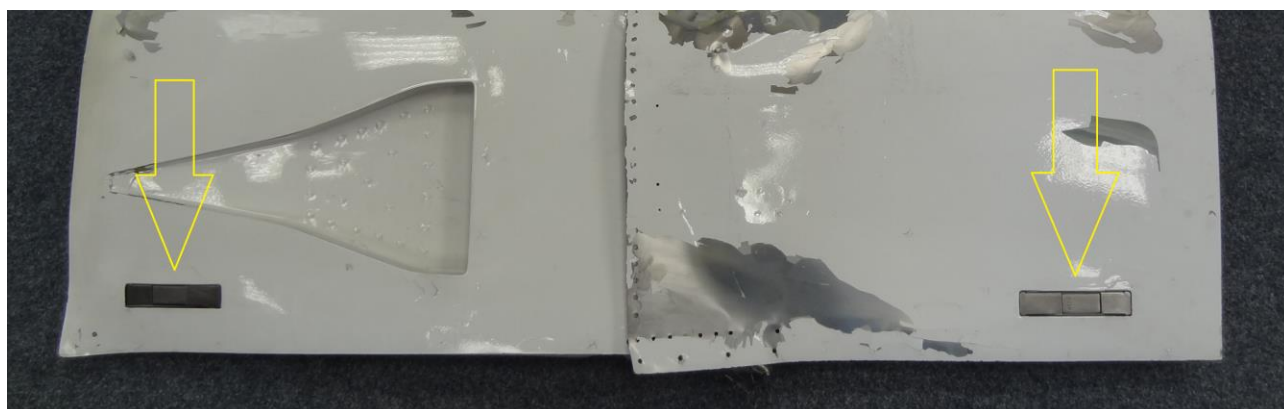
Rys. 3. Strona zewnętrzna drzwi górnych po zdarzeniu, obie klamki w położeniu „zamknięte”
