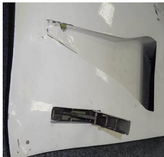
Rys.9. Wewnętrzna strona klamki bez oznakowania farbą odblaskową
