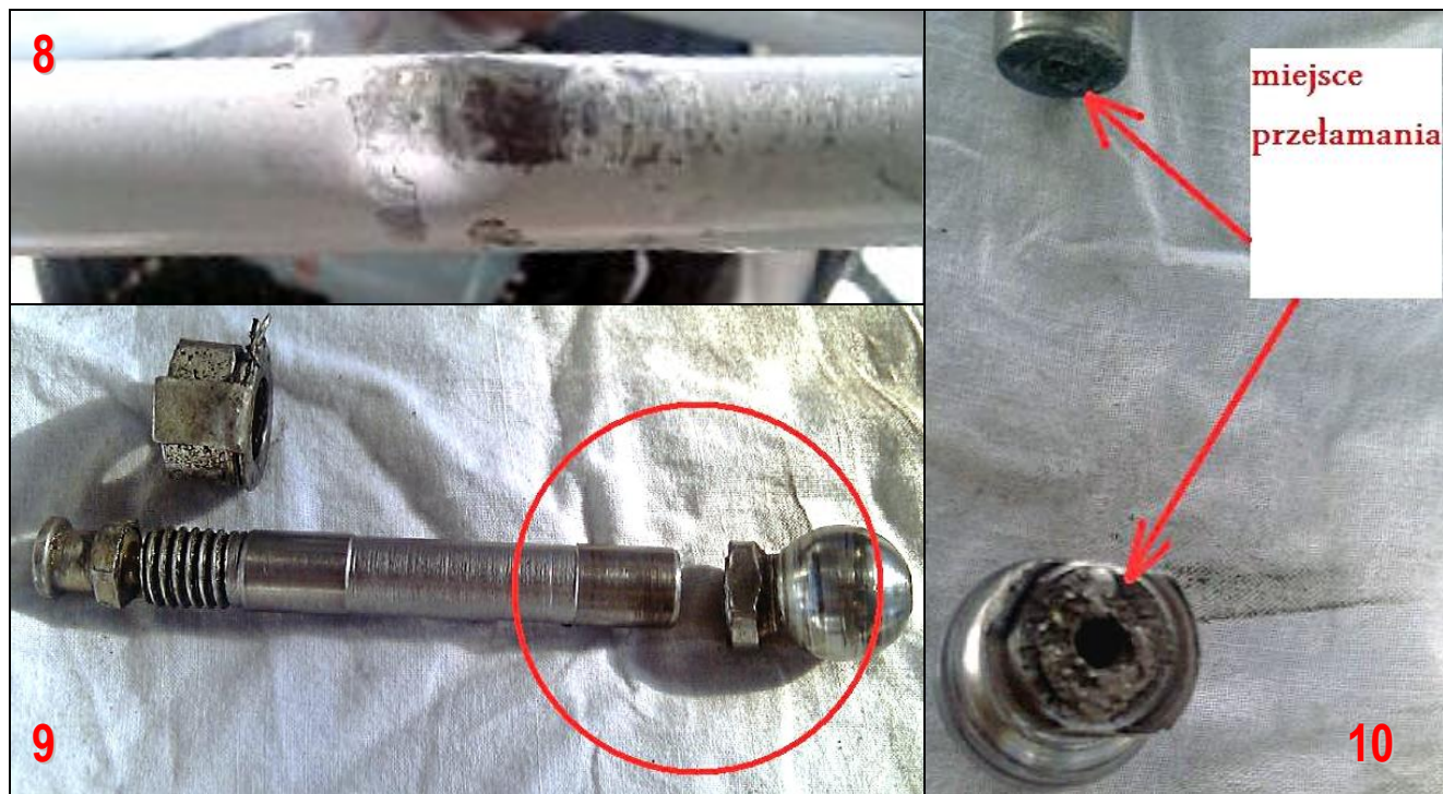
8 – Uszkodzenie poprzeczki popychacza w zbliżeniu.
