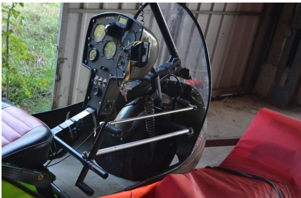
Fot. 1. Położenie popychaczy nożnego sterowania przepustnicą silnika w pozycji biegu jałowego silnika. Źródło: PKBWL
