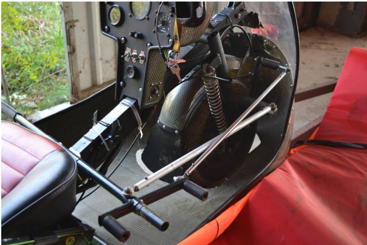
Fot. 2. Położenie popychaczy nożnego sterowania przepustnicą silnika po przekroczeniu tzw. martwego punktu powodujące zablokowanie przepustnicy silnika w maksymalnym położeniu. Źródło: PKBWL
