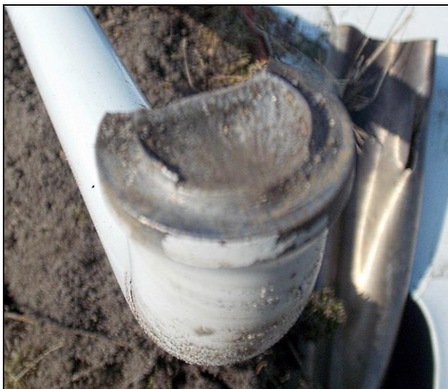
13 – Zbliżenie przełomu końcówki nogi przedniego podwozia - powiększenie. W tle widoczna zgnieciona rura wydechowa.
