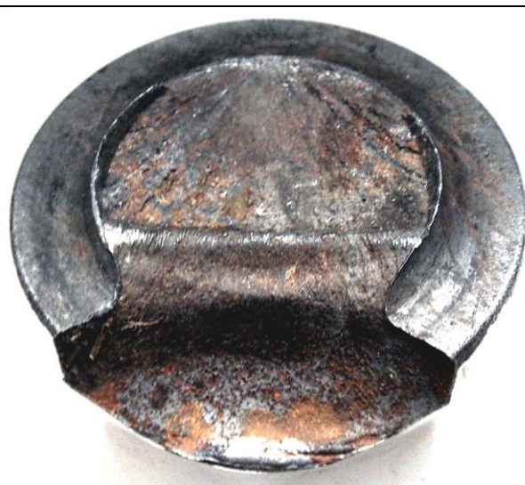
14 – Zbliżenie przełomu końcówki nogi przedniego podwozia z drugiej strony - powiększenie. Dobrze widoczna zmiana średnicy nogi.
