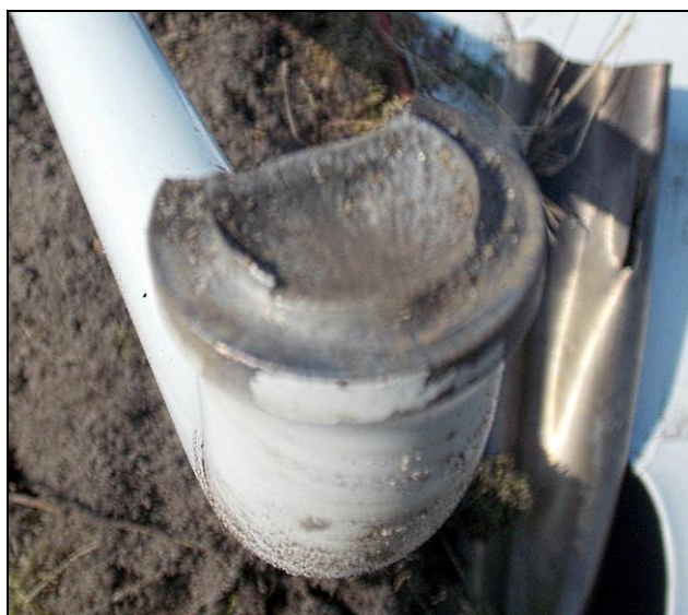
25 – Zbliżenie przełomu końcówki goleń przedniego podwozia - powiększenie. W tle widoczna zgnieciona rura wydechowa.
