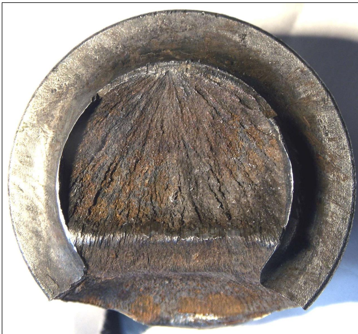
32 – Zbliżenie przełomu złamanej końcówki goleń przedniego podwozia - powiększenie.
