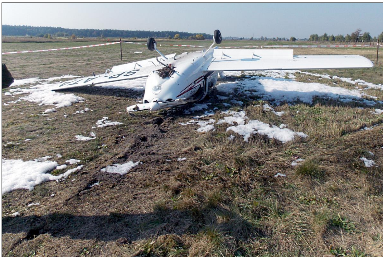
14 – Zbliżenie na ślad złamanej nogi z prawej strony samolotu.
