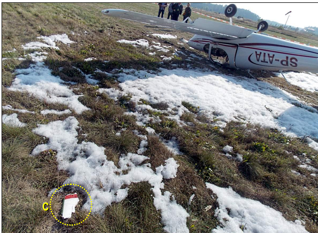
21 – Odłamek łopaty śmigła (C) w pobliżu samolotu. W tle widoczny rękaw lądowiska.
