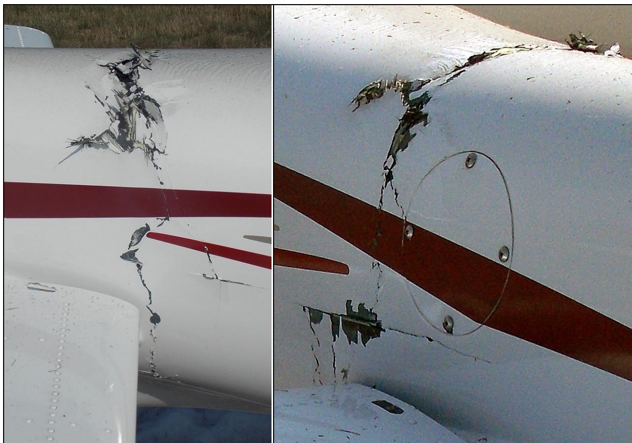
18, 19 – Przełom kadłuba przed usterzeniem, zbliżenia z lewej i prawej strony.
