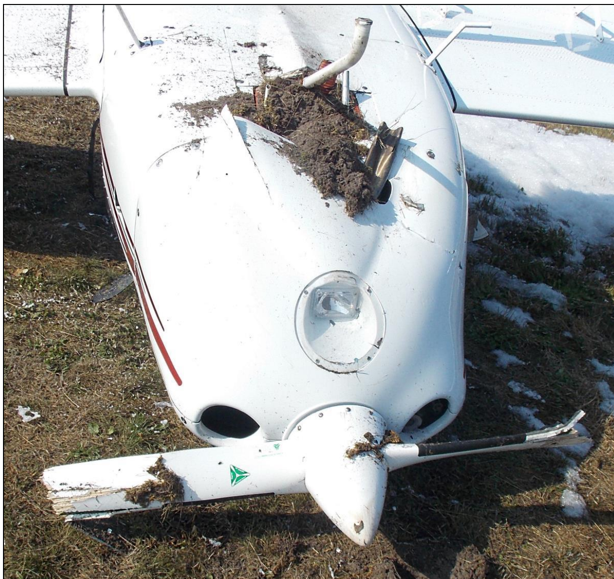
24 – Zbliżenie na przednią część kadłuba. Widoczna złamana goleń podwozia przedniego, zniszczone śmigło, popękana dolna osłona silnika ze stłuczoną szybą reflektora i zgnieciona rura wydechowa.
