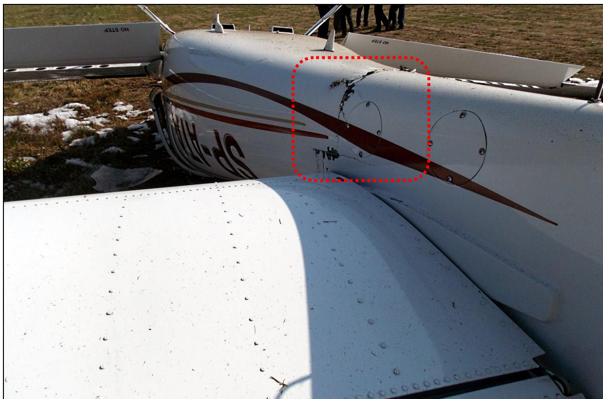
17 – Usterzenie i tylna część kadłuba z wyraźnie widocznym przełomem, prawa strona.
