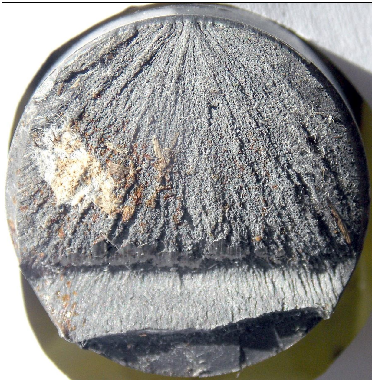
30 – Zbliżenie przełomu na odłamanej części goleni przedniego podwozia - powiększenie.
