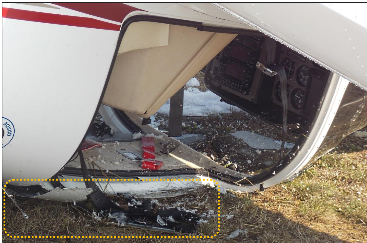
15 – Zbliżenie na resztki ramy wyłamanych lewych drzwi, pozostałe przy samolocie.
