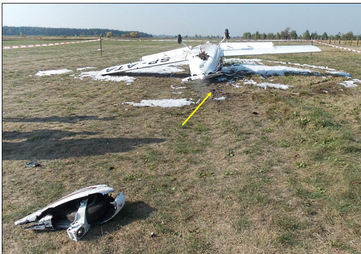
11 – Samolot na miejscu wypadku, przed nim, na pierwszym planie, widoczny odłamany widelec przedniego podwozia z kołem i owiewką oraz ślad złamanej goleni podwozia na nawierzchni lądowiska (wskazany strzałką).
