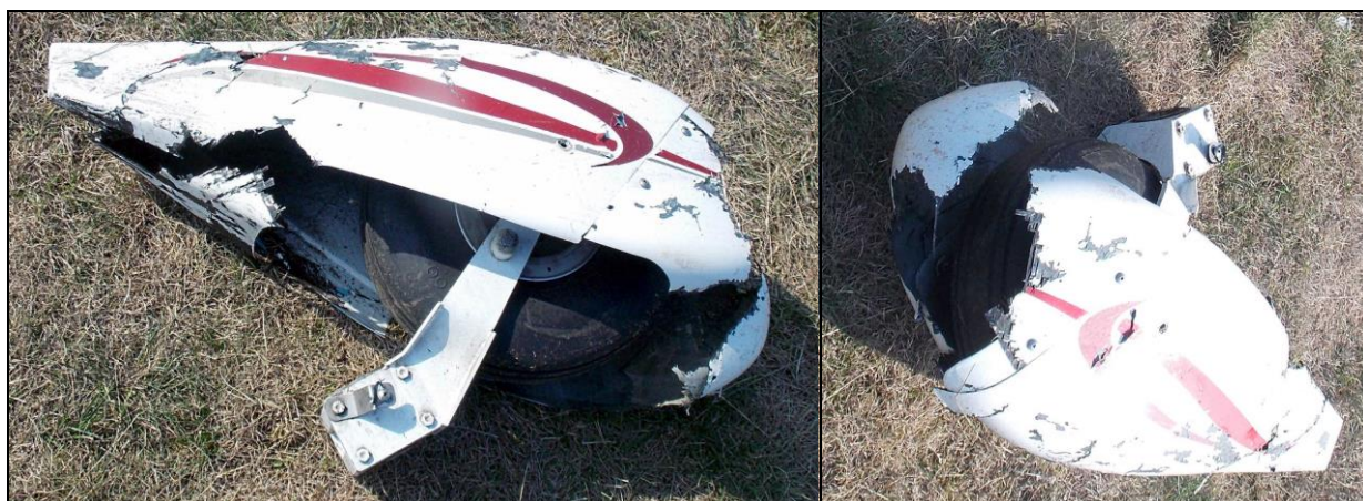
8, 9 – Odłamany widelec przedniego podwozia z kołem i zniszczoną owiewką (B).
