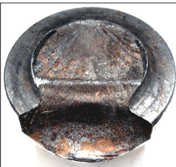
26 – Zbliżenie przełomu końcówki goleń przedniego podwozia z drugiej strony - powiększenie. Dobrze widoczna zmiana średnicy goleń.
