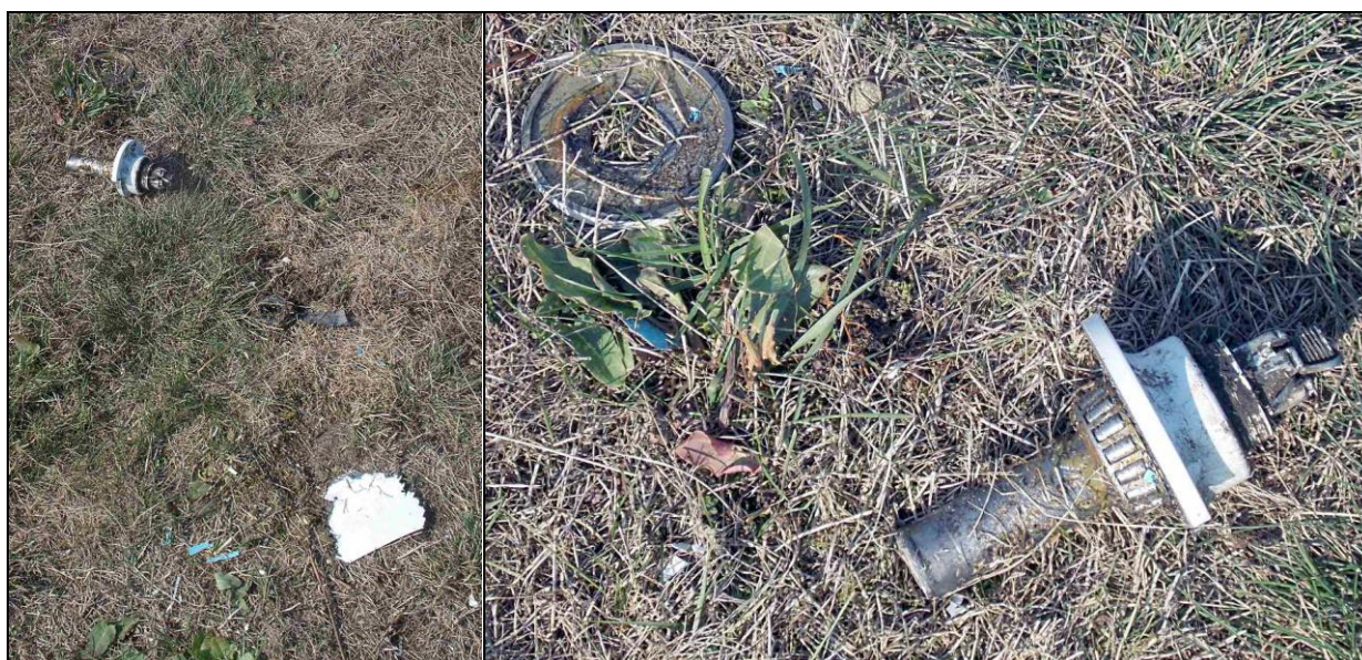
6, 7 – Odłamana końcówka goleni przedniego podwozia z dolnym łożyskiem widelca koła (A).
