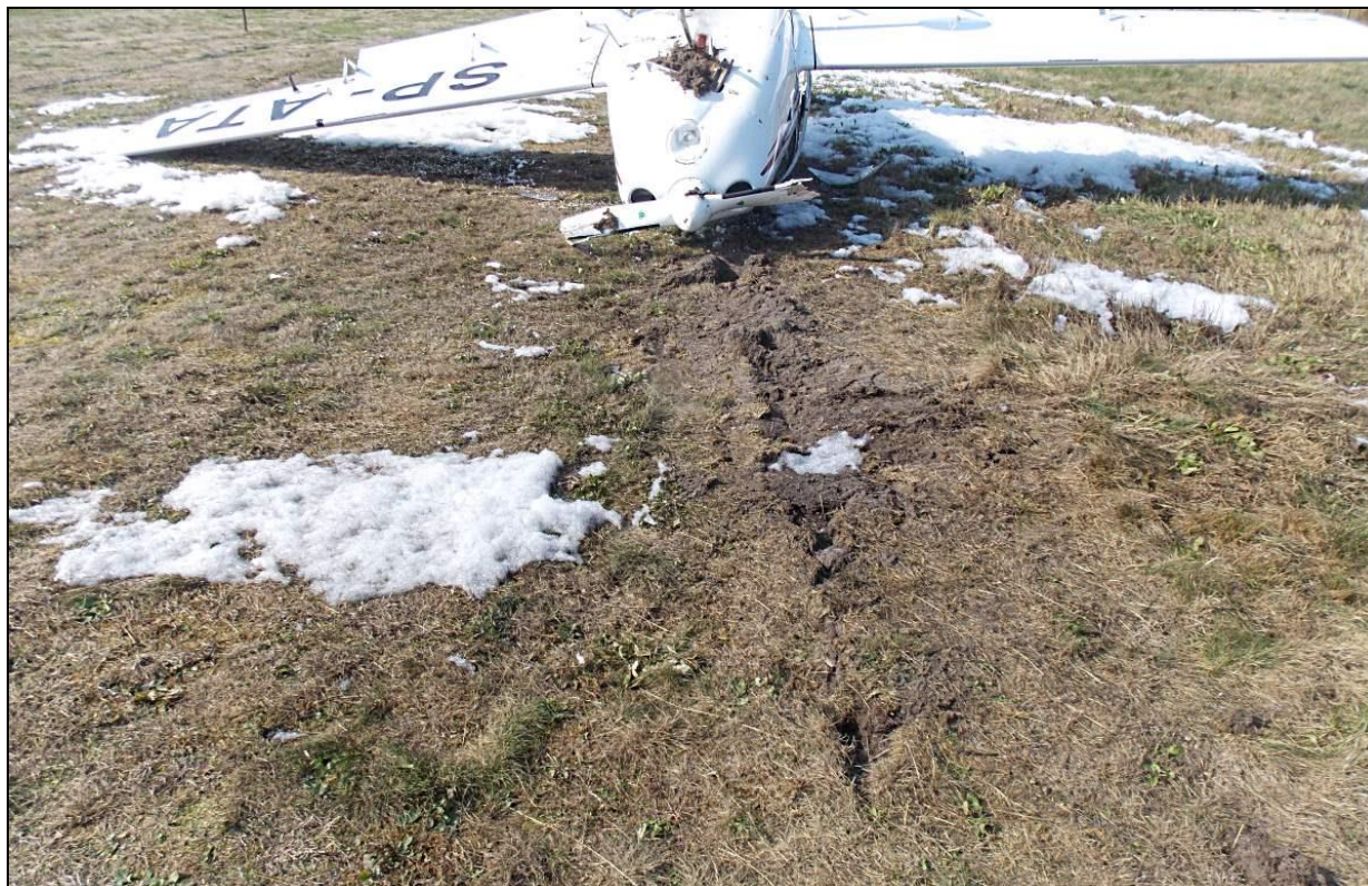
12 – Zbliżenie na ślad złamanej goleni w kierunku ruchu samolotu.
