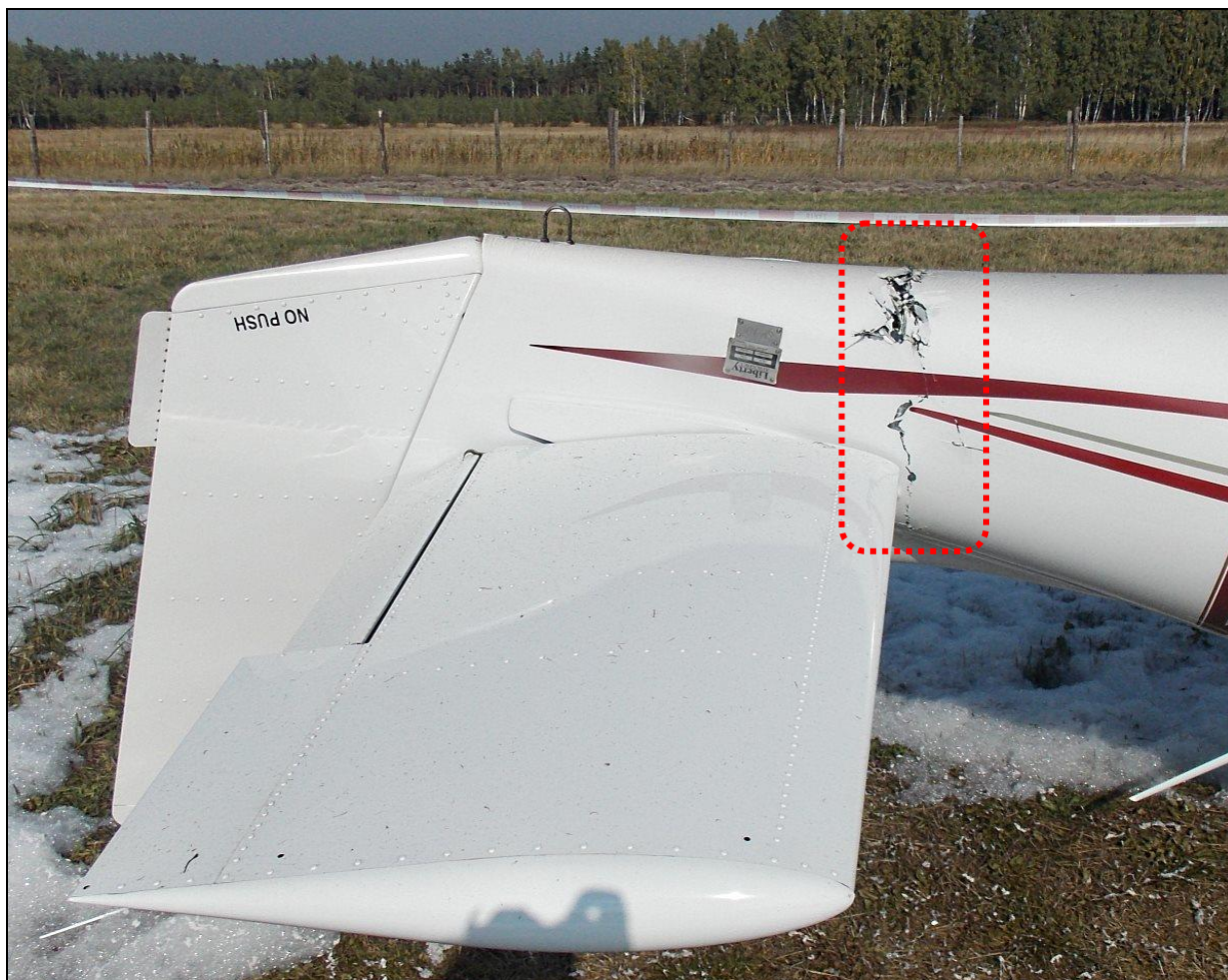
16 – Usterzenie i tylna część kadłuba z wyraźnie widocznym przełomem, lewa strona.
