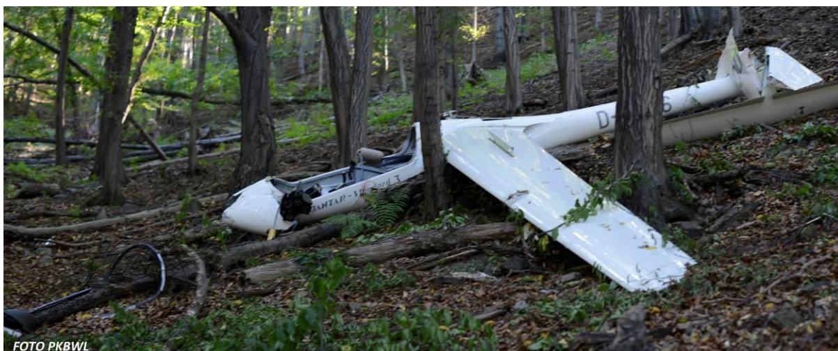
Ilustracja nr 4. Uszkodzenie szybowca –widok z lewej strony.
