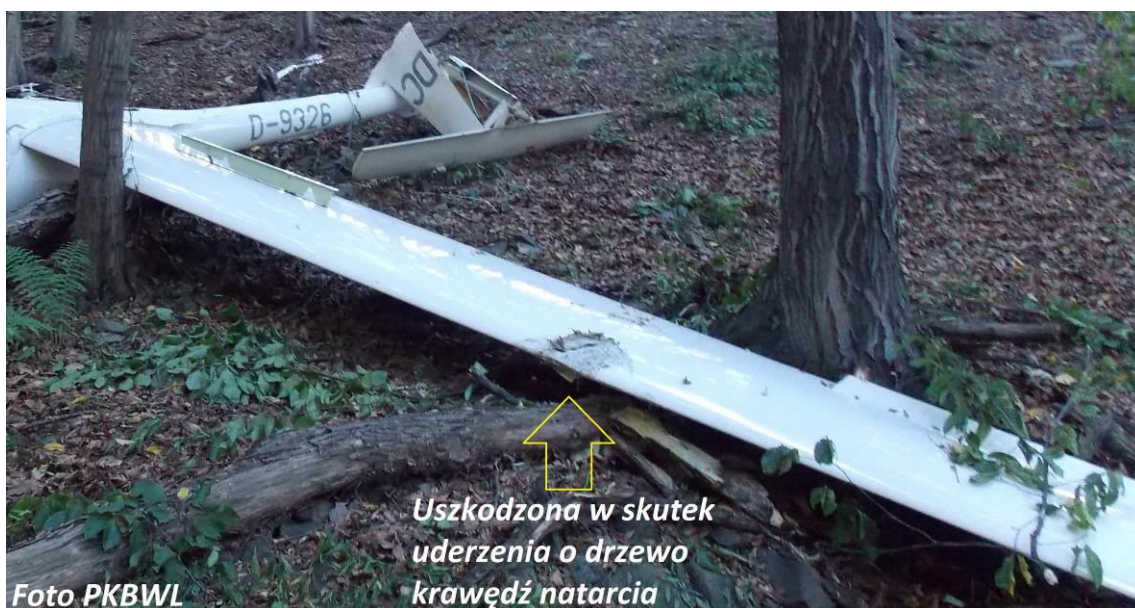
Ilustracja nr 8. Widoczne uszkodzenia lewego skrzydła i wyłamany ogon szybowca.
