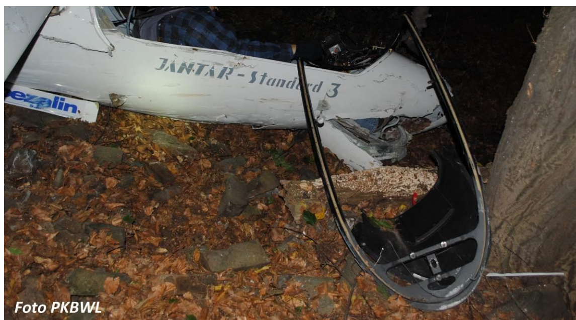
Ilustracja nr 9. Widoczne otarcia poszycia i uszkodzenie przedniej części kadłuba oraz wyłamana i rozbita owiewka kabiny
