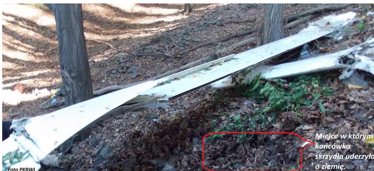
Ilustracja nr 11. Widoczne złamane prawe skrzydło i rozwarstwienie krawędzi spływu.
