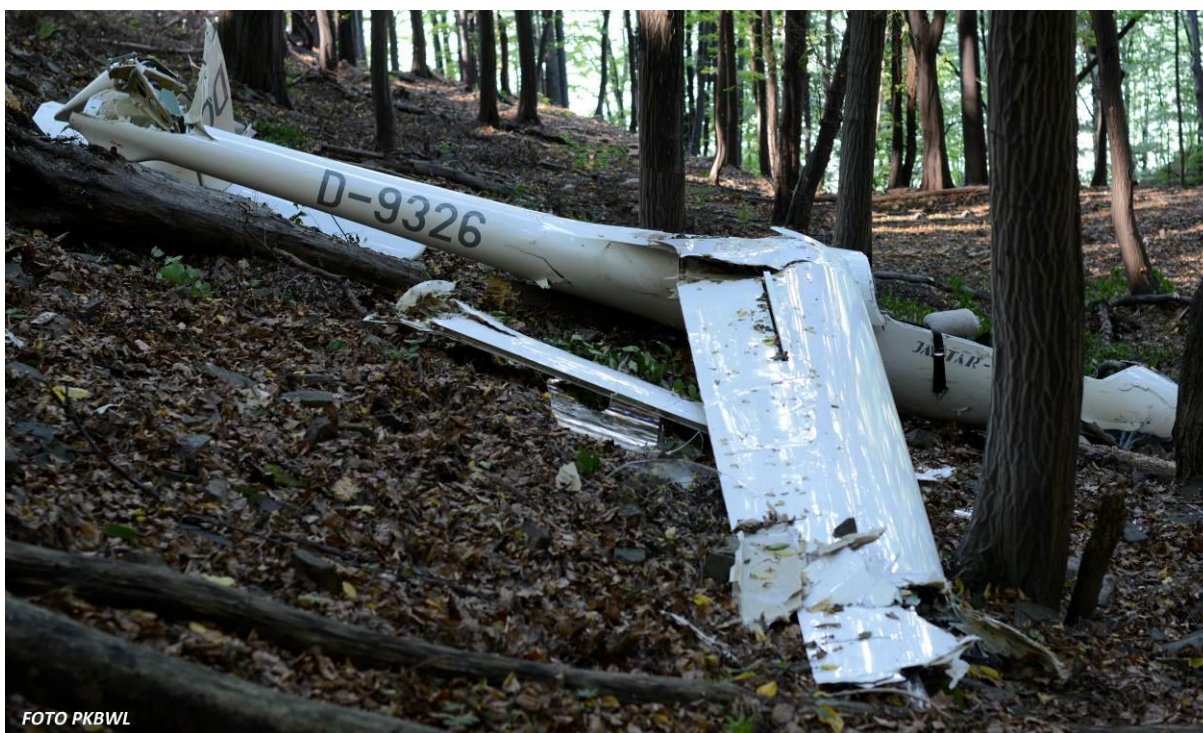
Ilustracja nr 5. Uszkodzenia szybowca – widok z prawej strony.
