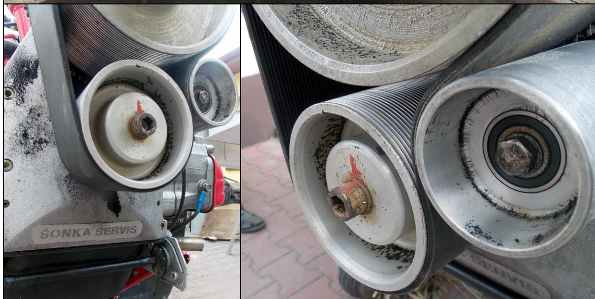
22, 23, 24 – Zbliżenia od tyłu na zespół napędowy i na przekładnie pasową silnika. Dobrze widoczne zalegające we wnętrzach kół przekładni oraz na powierzchni silnika i sprężystej gołeni podwozia główne obfite złogi materiału wykruszonego z paska klinowego przekładni, świadczące o jej nieprawidłowym działaniu.
