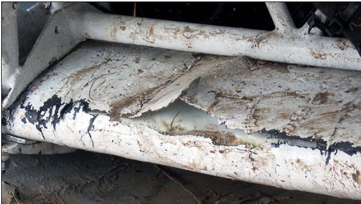
14 – Kompozytowa goleń sprężysta podwozia głównego – zbliżenie części środkowej.
