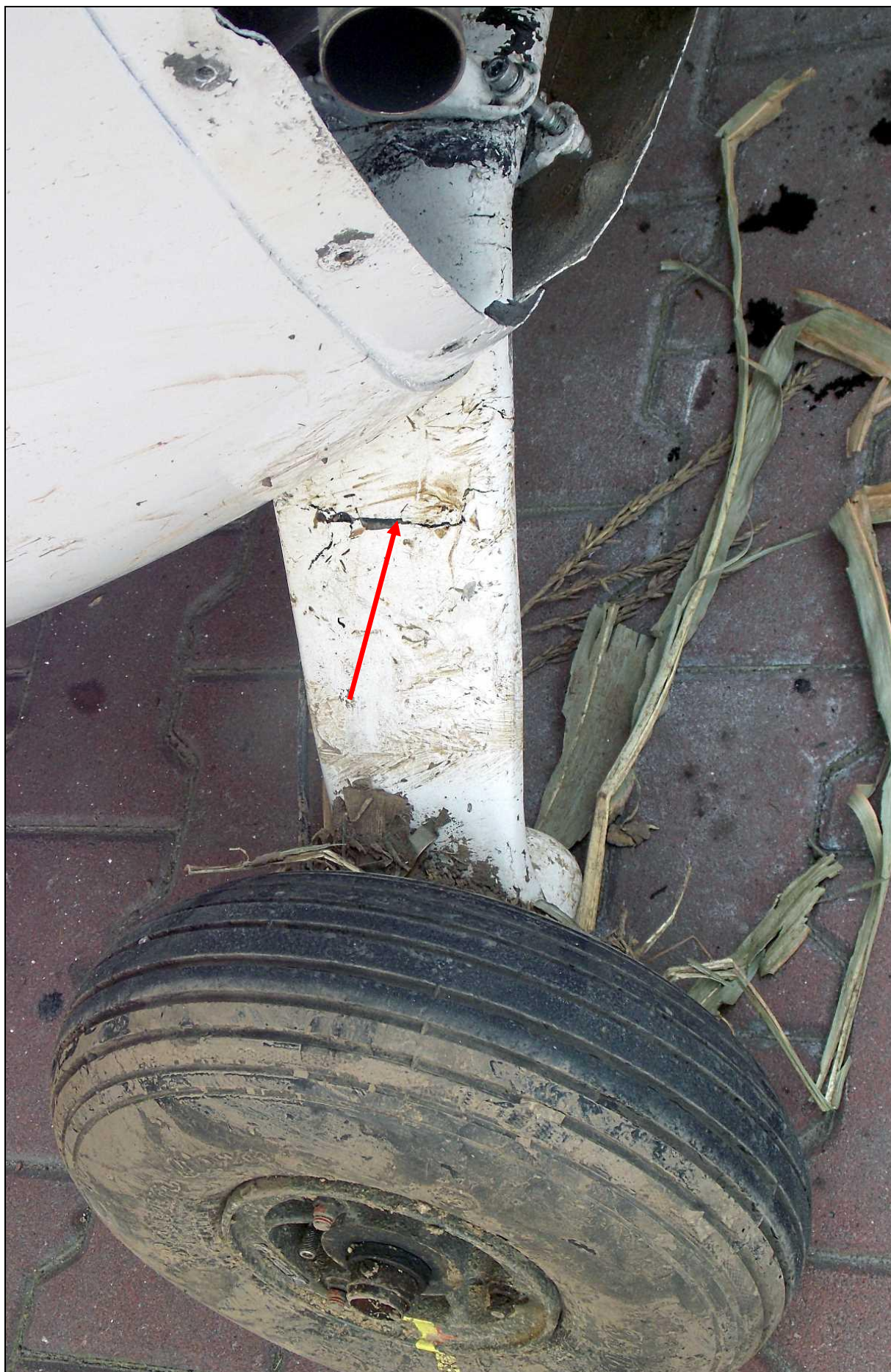
13 – Kompozytowa goleń sprężysta podwozia głównego – zbliżenie lewej strony, strzałką wskazane pęknięcie.
