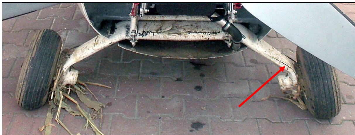
11 – Widok od tyłu na podwozie główne. Widoczne deformacje i pęknięcia. Strzałką zaznaczone rozwarstwienie.
