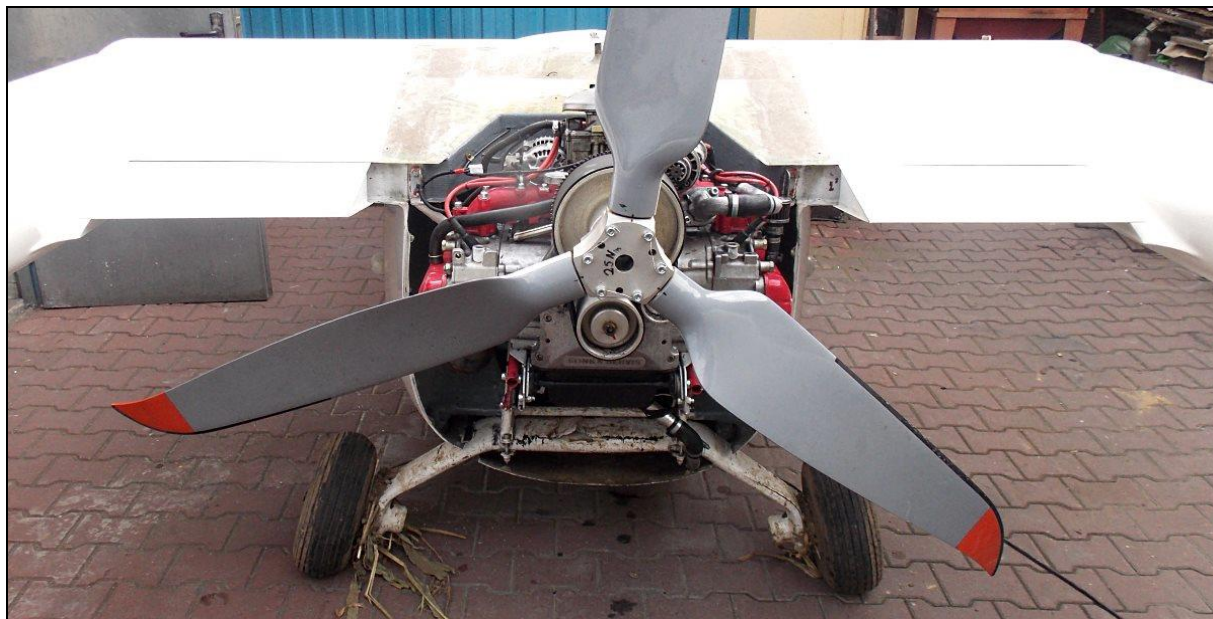
10 – Widok od tyłu na centropląt, zespół napędowy i podwozie główne. Osłony silnika zdjęte.
