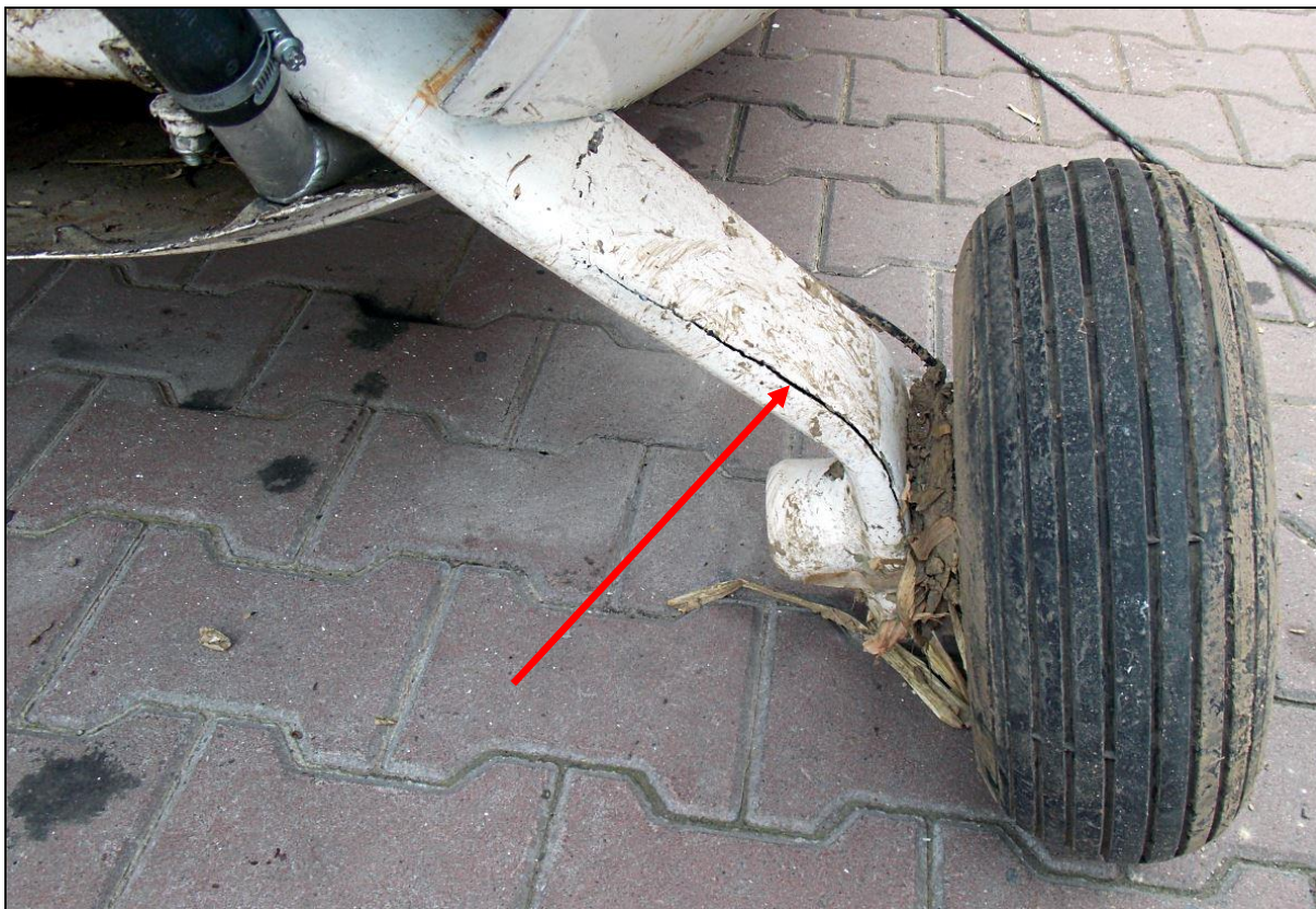
15 – Kompozytowa goleń sprężysta podwozia głównego – zbliżenie prawej strony, strzałką wskazane rozwarstwienie.
