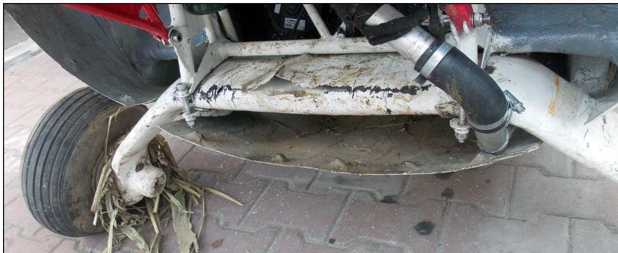
12 – Kompozytowa goleń sprężysta podwozia głównego – zbliżenie lewej strony.
