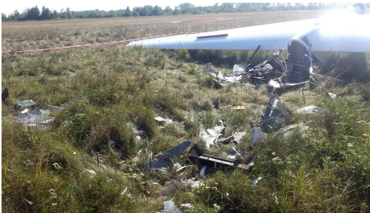
Ilustracja nr 3. Szczątki szybowca skupione na małej przestrzeni na kierunku zderzenia świadczą o tym, że zetknięcie z ziemią nastąpiło pod dużym kątem.
