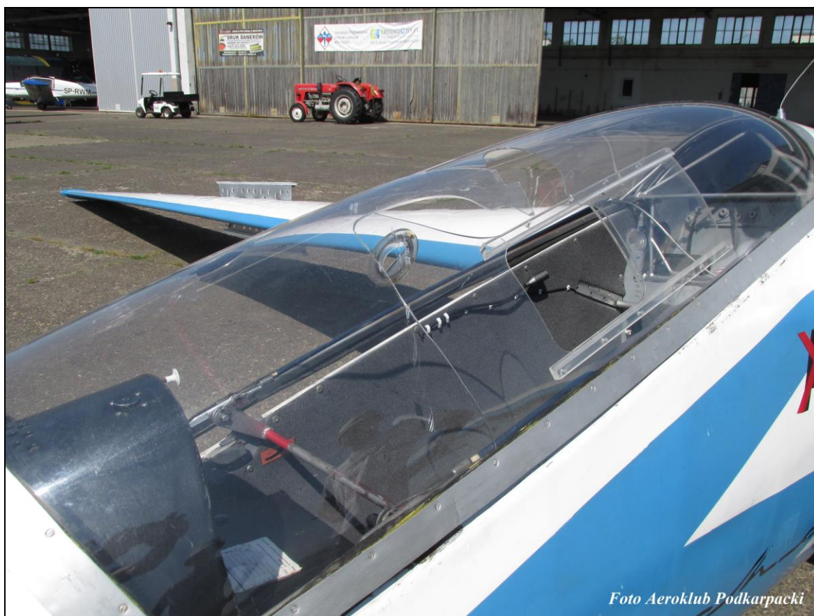
Ilustracje nr 3. Uszkodzenie oszklenia kabiny szybowca.
