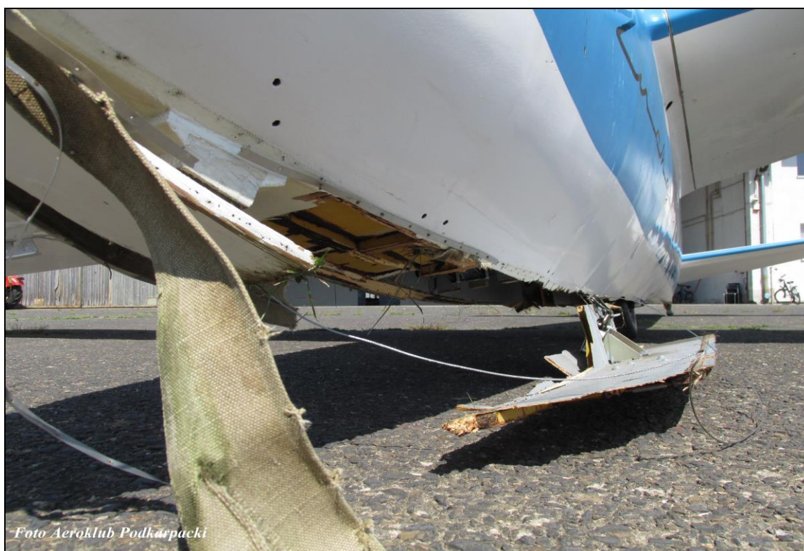
Ilustracja nr 2. Uszkodzona listwa kilowa, złamana płoza.
