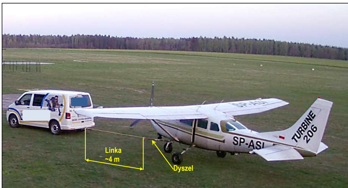
10 – Holowanie samolotu za samochodem z użyciem linki między dyszlem holowniczym a samochodem [foto: Aeroklub Słupski].
