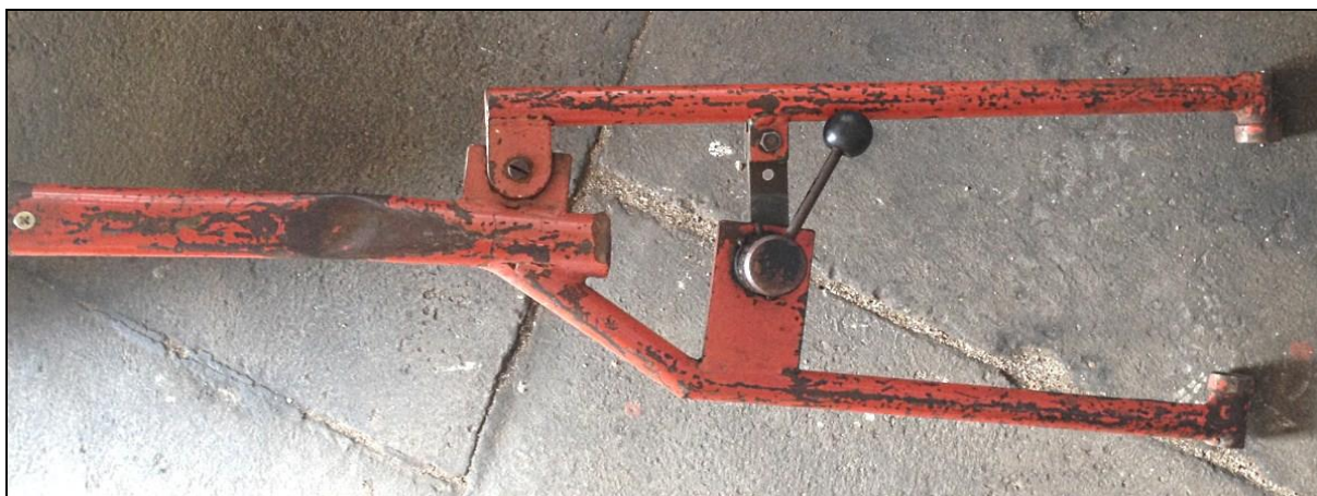
9 – Dyszel-wodzydło, używane podczas holowania samolotu po ziemi [foto: pilot samolotu].
