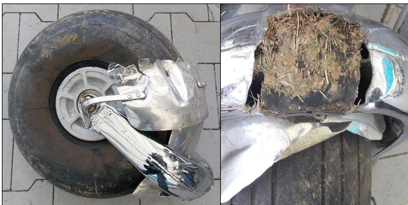
Odlamany od osi skrętu widelec przedniego podwozia z kołem i zbliżenie na zniszczoną spoinę łączącą widelec z osią skrętu.
