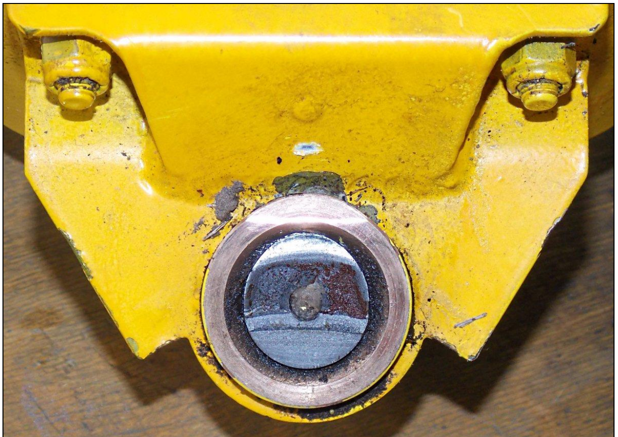
25 – Widok na górną półkę widelca ze złamaną osią obrotu pozostającą w jego tulei [fot. PKBWL]
