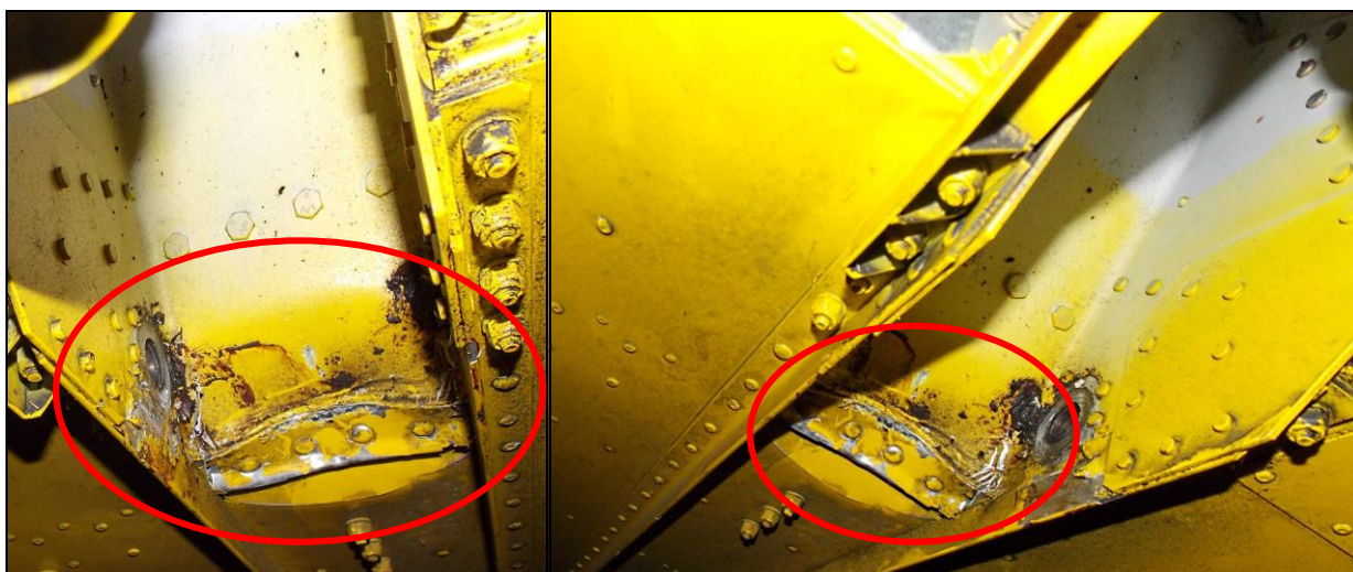
9, 10 – Wgniecenie kadłuba przy dolnej krawędzi przegrody ogniowej przez goleń przedniego podwozia, przemieszczającą się w trakcie zdarzenia pod spód samolotu [fot. PKBWL]
