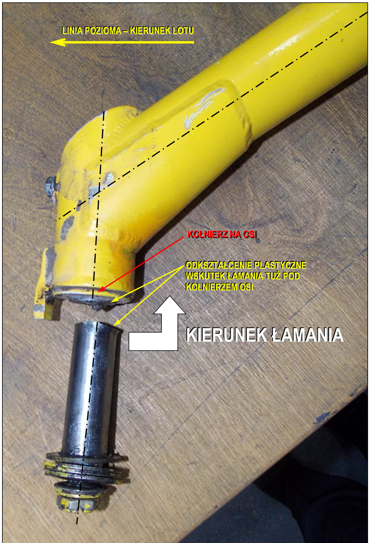
23 – Dolny węzeł goleni przedniego podwozia i odłamany dolny fragment osi obrotu widelca – fragment górny pozostaje w tulei goleni [fot. PKBWL]
