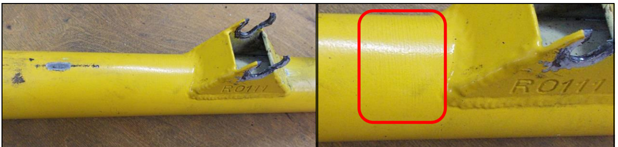
21, 22 – Fragment goleni podwozia przedniego z rozerwanym podwójnym uchem mocowania dolnego przegubu amortyzatora oraz powiększony szczegół z charakterystycznymi prążkami pęknięć pokrycia lakierniczego, świadczącymi o wyraźnym odkształceniu tej części goleni wskutek chwilowego zginania [fot. PKBWL]
