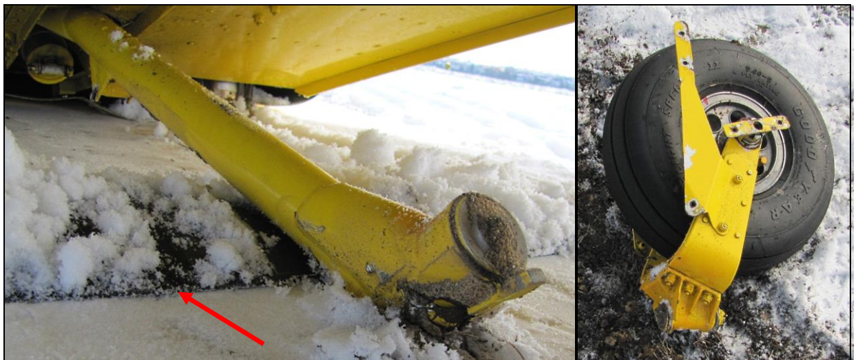
5, 6 – Z lewej: wyłamana goleń podwozia przedniego, jedna z łopat śmigła (wskazana strzałką). Z prawej: oderwany widelec podwozia przedniego z kołem [fot. Ventum Air Flight Academy]
