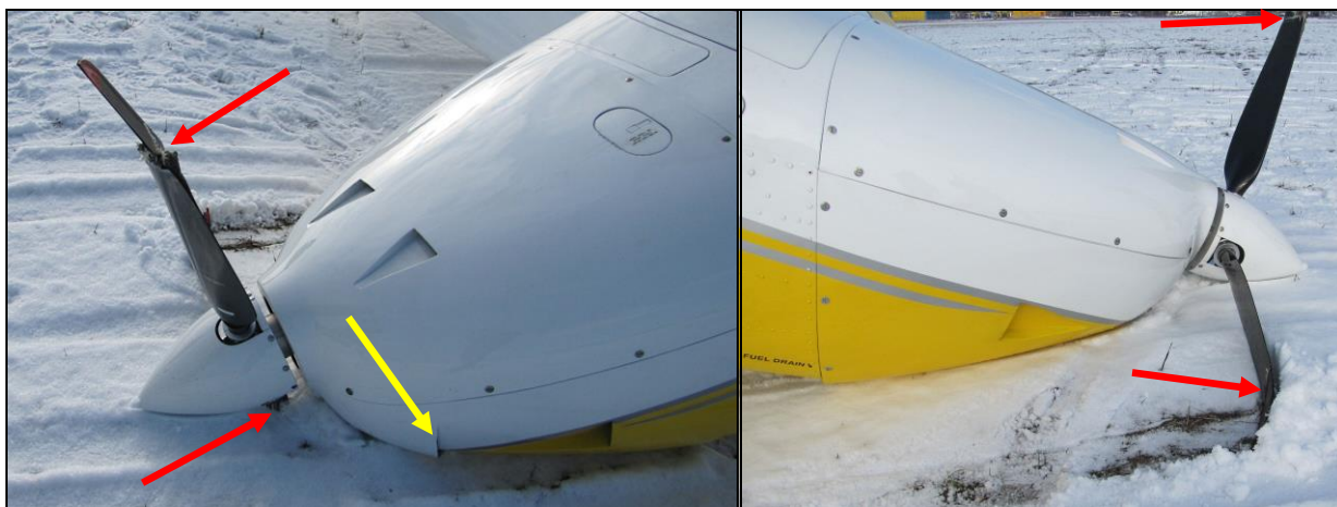
7, 8 – Przednia część kadłuba. Z lewej lewa strona – widoczne zniszczenia łopaty śmigła (strzałki czerwone) i rozdarcie dolnej osłony silnika (strzałka żółta). Z prawej prawa strona – widoczne zniszczenia łopaty śmigła (strzałki czerwone) [fot. Ventum Air Flight Academy]
