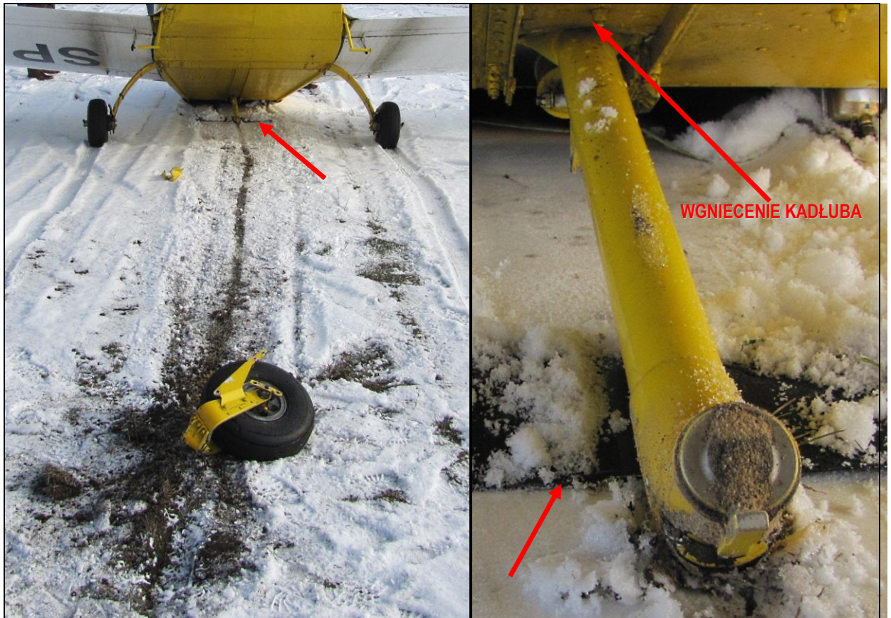
3, 4 – Z lewej: zbliżenie na ślad zdarzenia oraz uszkodzone elementy podwozia przedniego. Z prawej: wyłamana, podwinięta pod kadłub goleń podwozia przedniego i odłamana łopata śmigła (wskazana strzałką) [fot. Ventum Air Flight Academy]
