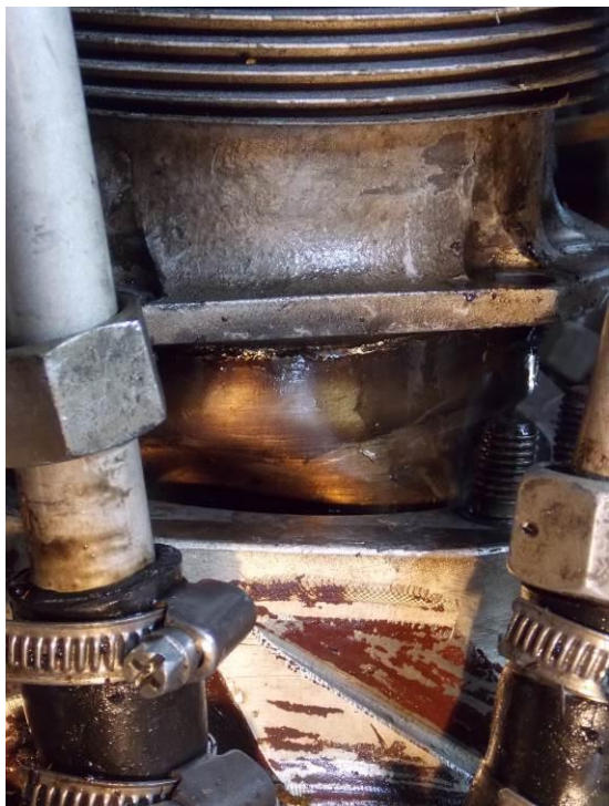
Rys. 4. Próba demontażu cylindra z karteru silnika w hangarze. Pod kołnierzem widoczne znaczne odkształcenia tulei, które uniemożliwiły wybudowanie cylindra bez naruszenia struktury karteru. [foto PKBWL]
