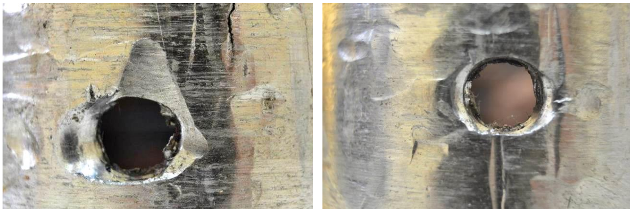
Rys.11. Uszkodzenia otworów stabilizujących tuleję korbowodu głównego między korbowodami nr 5 i 6, po lewej oraz nr 2 i 3, po prawej. [foto Politechnika Śląska]
