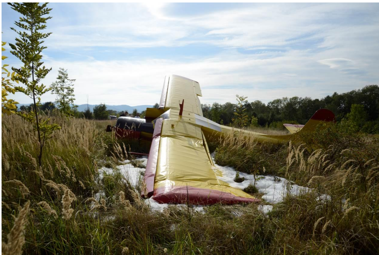
Rys. 3. Samolot na miejscu wypadku, widoczne uszkodzenia lewego skrzydła oraz piana gaśnicza zabezpieczająca rejon zdarzenia przed pożarem. [foto W. Gorgolewski]
