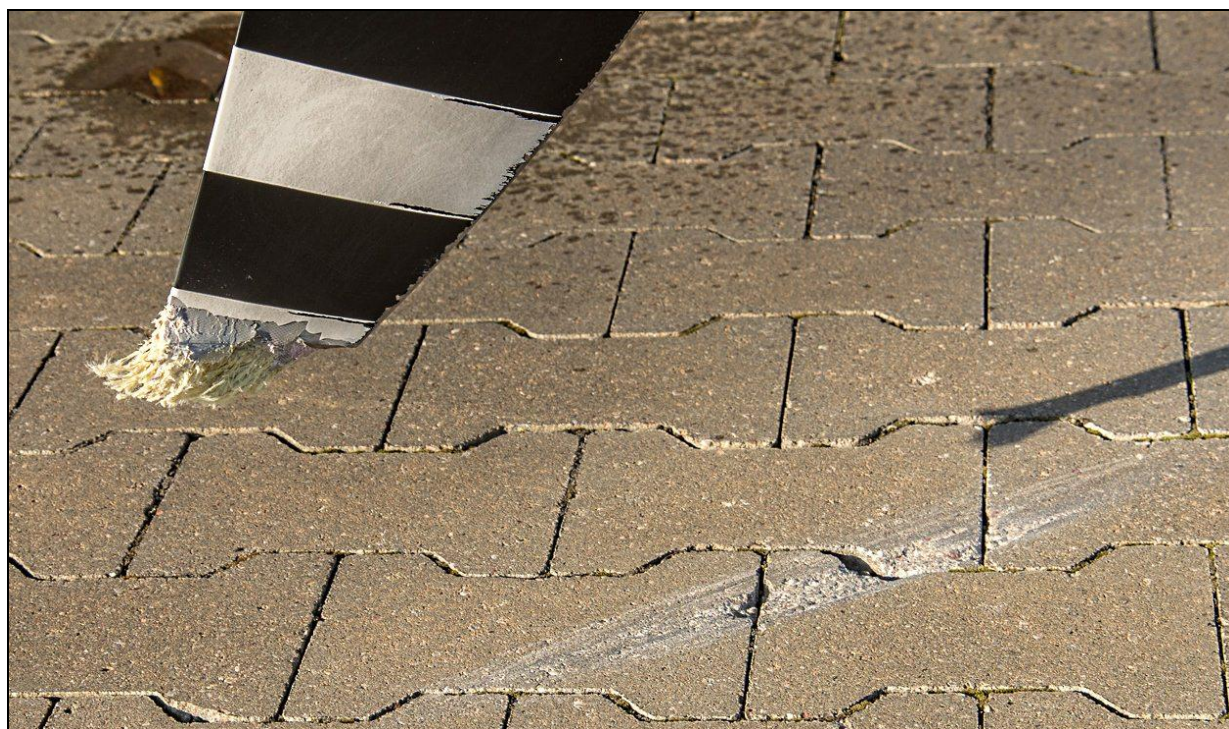
2 – Uszkodzona końcówka łopaty śmigła i ślad łopaty śmigła na nawierzchni [fot. Aero Club sp. z o.o.].
