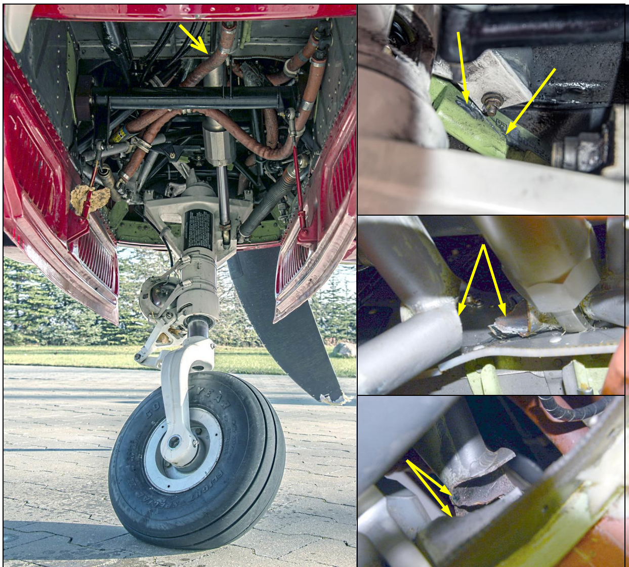
3, 4, 5, 6 – Wnęka podwozia przedniego oraz zbliżenia na uszkodzone i zniszczone elementy w okolicy węzła mocowania siłownika chowania podwozia przedniego do kratownicy łoża silnika [fot. Aero Club sp. z o.o.].
