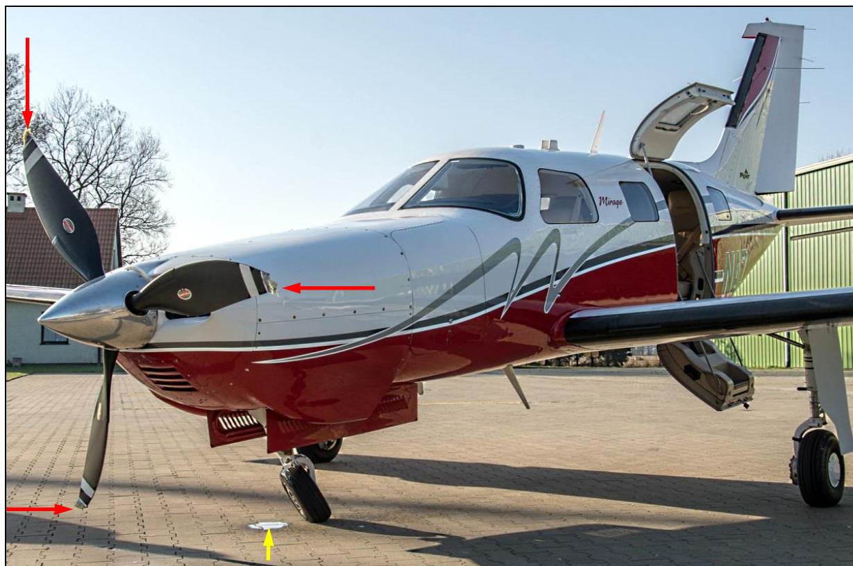
1 – Ogólny widok samolotu po zdarzeniu. Widoczne uszkodzenia końcówek łopatek śmigła i wyciek płynu hydraulicznego z siłownika podwozia przedniego. [fot. Aero Club sp. z o.o.]
