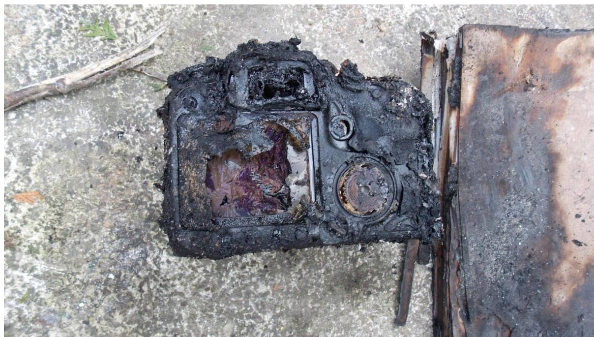
Rys.16. Wydobyty z kabiny samolotu zniszczony pożarem aparat fotograficzny, którym wykonywano zdjęcia z powietrza.
