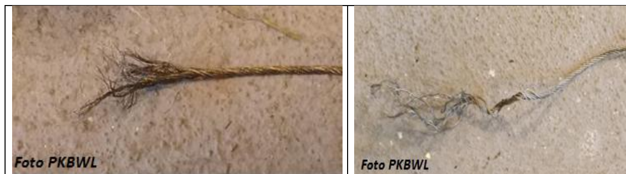
Rys.17. Zerwane linki napędu lotek. Sposób zerwania wskazuje na doraźny charakter zniszczenia, na skutek przekroczenia naprężeń dopuszczalnych podczas odrywania części prawego skrzydła.
