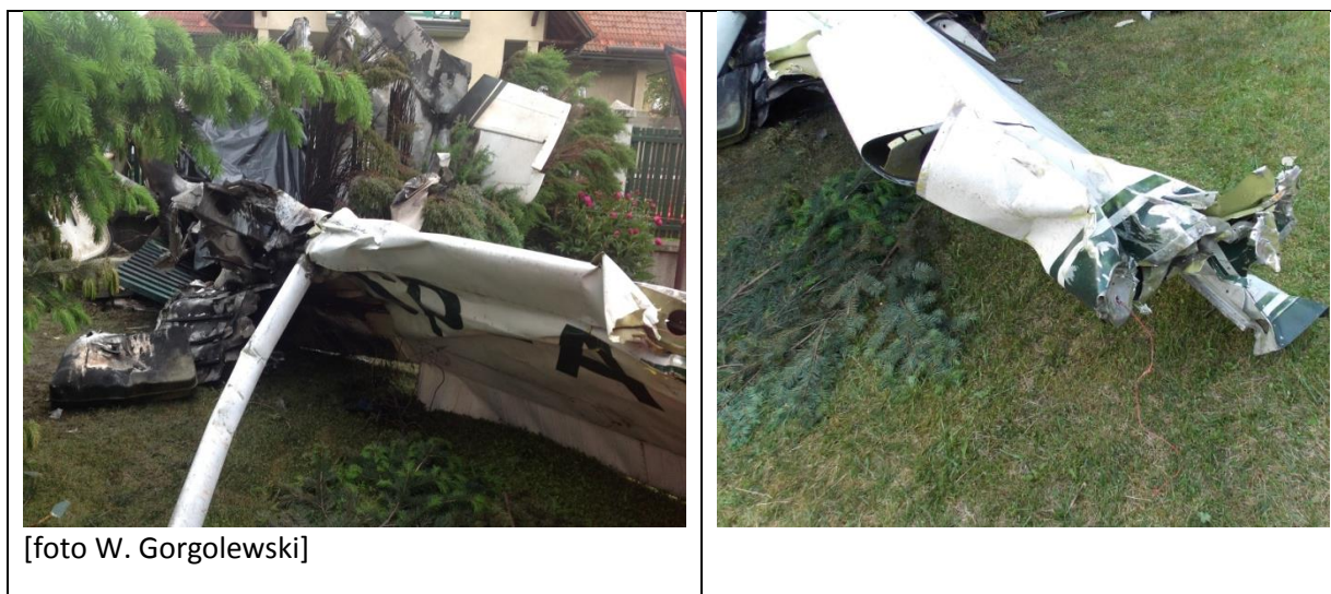
Rys.10 i 11. Lewe skrzydło. Zdjęcie po lewej – na trawniku widoczny wyrwany z konstrukcji zbiornik paliwa. Zdjęcie po prawej – zniszczona końcówka skrzydła
