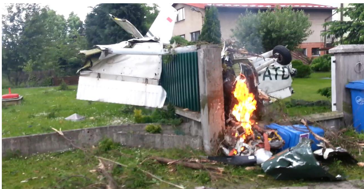
Rys.6. Wrak samolotu bezpośrednio po wypadku. Widoczny lokalny pożar instalacji paliwowej. Pozostała część wraku jeszcze nie zniszczona pożarem jaki nastąpił po wybuchu oparów rozlanego paliwa. [foto Krzysztof Zimny]
