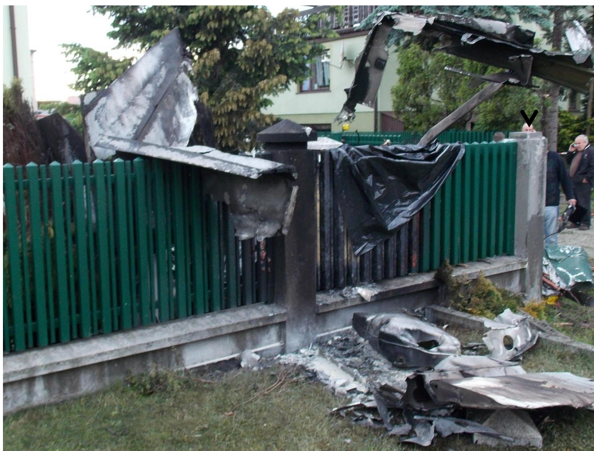
Rys. 8. Wrak samolotu zniszczony pożarem – po prawej szczątki prawego skrzydła z wypalonym zbiornikiem paliwa.
