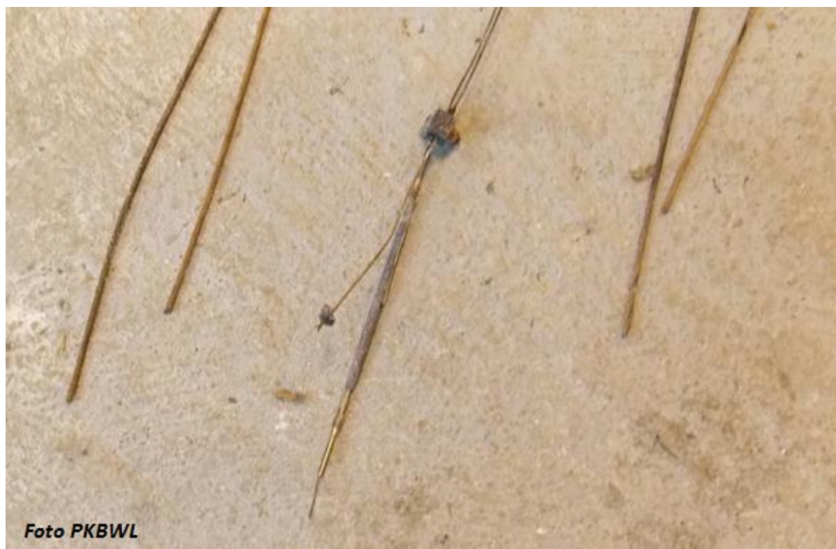
Rys.18. Linki napędów sterów wysokości, trymera i steru kierunku (przecięte w trakcie przygotowania wraku samolotu do transportu).
