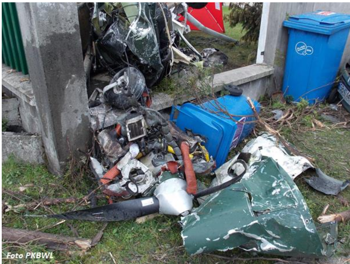
Rys.12. Oddzielony od kadłuba silnik. Na pierwszym planie uszkodzone maski silnika i śmigło.
