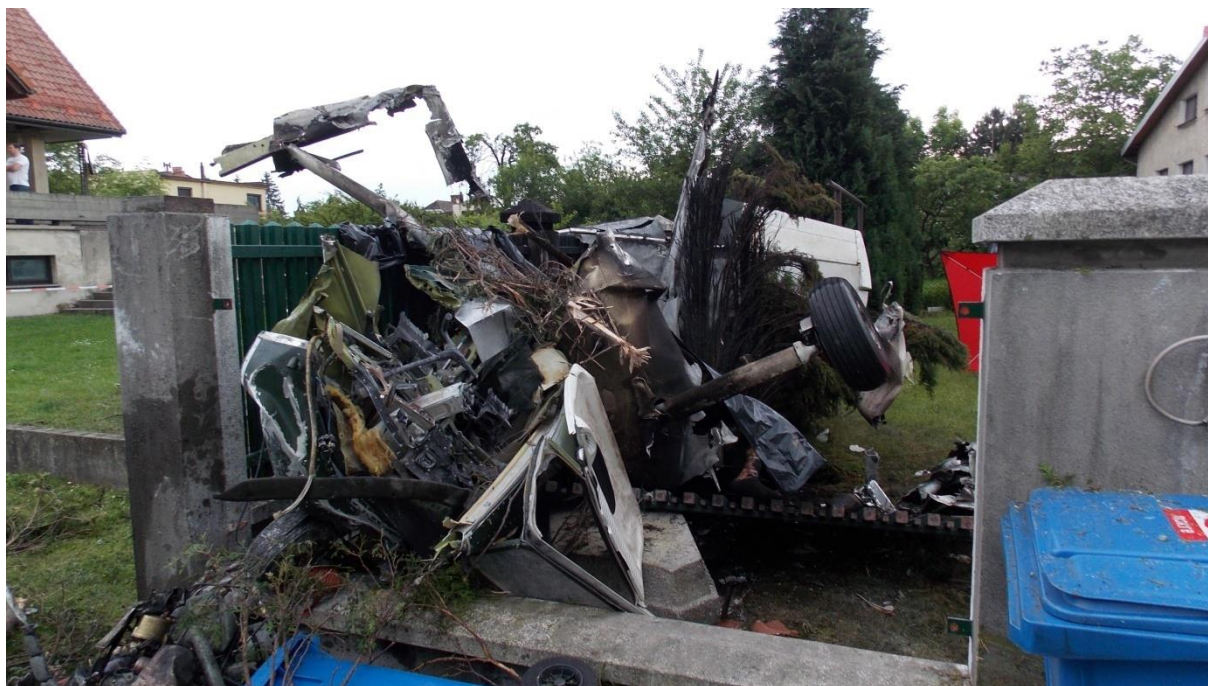
Rys.7. Wrak samolotu zniszczony pożarem – widok o strony ściany ogniowej.
