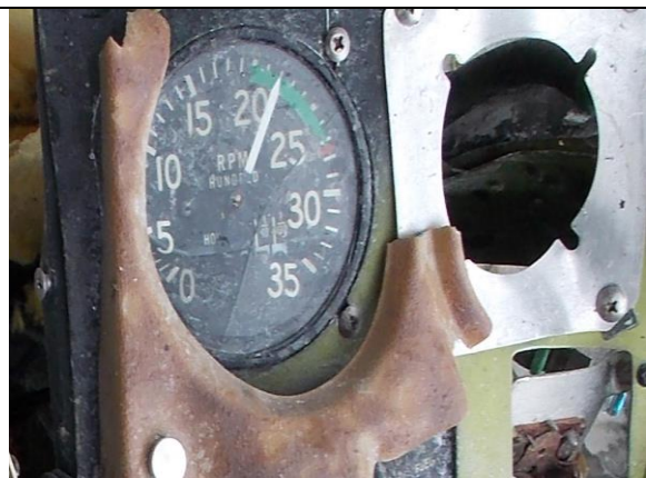
Rys.14. Fragment tablicy przyrządów pokładowych - zablokowane wskazania obrotomierza (2200 obr./min.).
