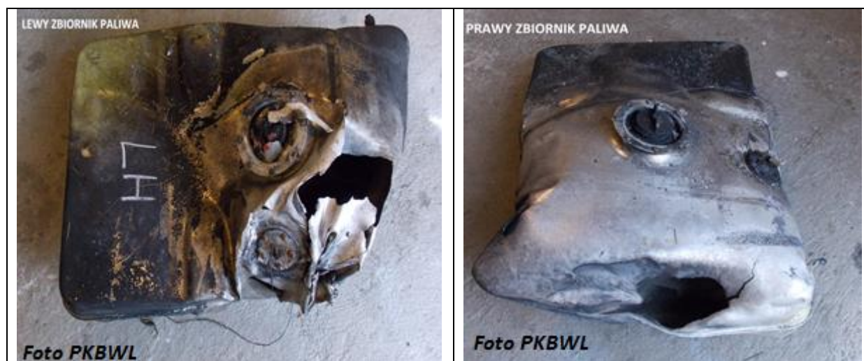
Rys.19 i 20. Stan zbiorników paliwa po wypadku.
