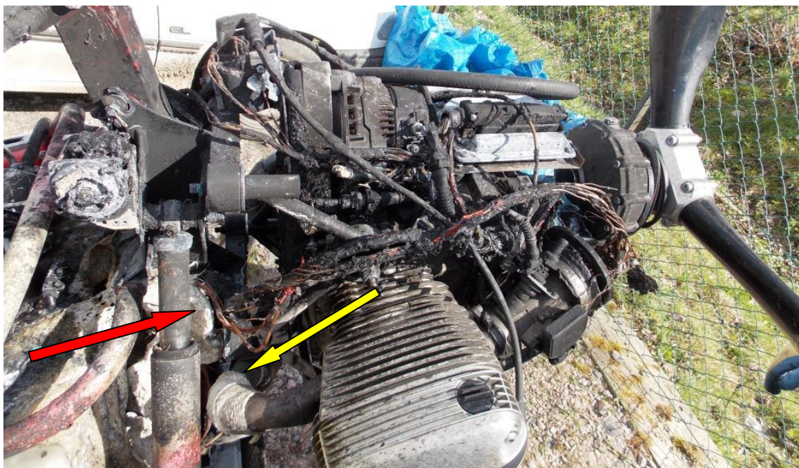
Fot. 1. Czerwona strzałka wskazuje rejon zniszczonej tylnej ściany zbiornika paliwa. Żółta strzałka wskazuje rurę wydechową biegnącą od lewego cylindra. Część rury wydechowej była owinięta białym bandażem z niepalnej tkaniny. Fot. PKBWL.
