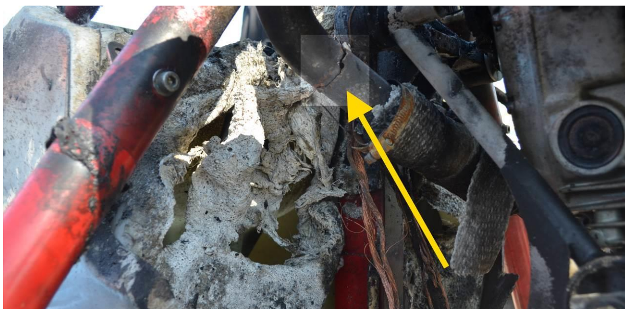
Fot. 5. Strzałka ukazuje pęknięcie kolektora (rozjaśnione dla większej czytelności), oraz wypalony otwór w zbiorniku – miejsce rozpoczęcia pożaru. Zdjęcie z późniejszych oględzin, bandaż usunięty. Fot. PKBWL.
