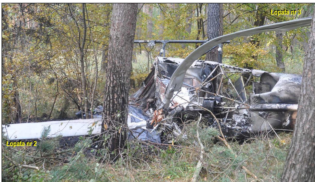
22 – Środkowa część kadłuba, widok od grzbietu. Widoczne znaczne zniszczenia od pożaru w przedziale za silnikiem oraz kompletne spalenie części kabinowej. Stan łopat nr 2 i nr 3 wirnika głównego świadczy, że w chwili zderzenia śmigłowca z ziemią był on nieruchomy lub obracał się bardzo wolno [foto: Policja].
