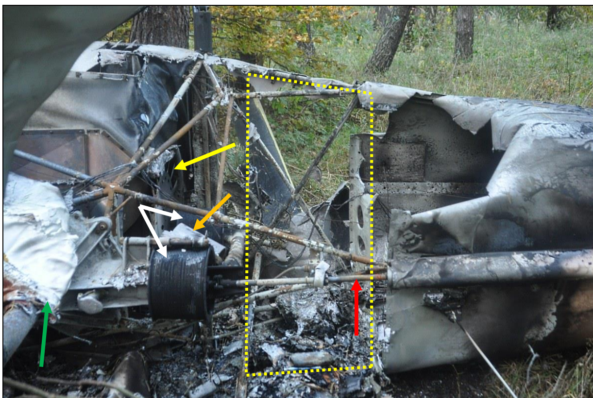
28 – Widok wypalonego kratownicowego przedziału kadłuba za silnikiem od strony grzbietu - zbliżenie. Widoczny wentylator silnika (strzałka żółta) oraz koła przekładni pasowej (strzałki białe), koło napinające (strzałka pomarańczowa) i wał transmisyjny napędu śmigła ogonowego (strzałka czerwona). Strzałką zieloną wskazane resztki prawego zbiornika paliwa. Kropkowaną żółtą linią orientacyjnie obramowana przestrzeń zajmowana w kadłubie przez bagażnik, gdzie mógł być kanister z olejem [foto: Policja].
