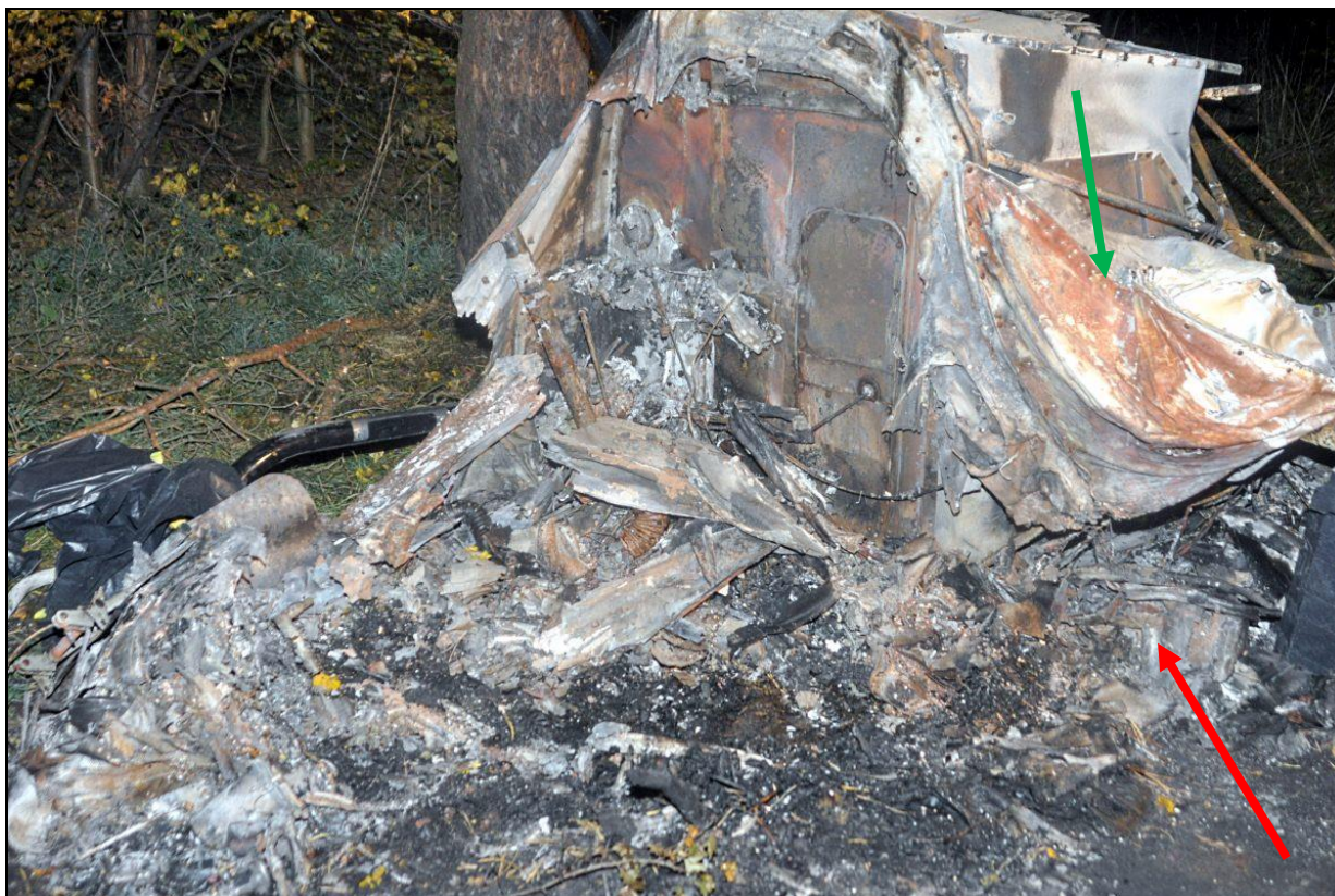
29 – Całkowicie wypalona i stopiona kabinowa część kadłuba (na pierwszym planie) – zbliżenie kadłuba leżącego na lewym boku od góry. Zieloną strzałką wskazane resztki prawego, a czerwoną resztki lewego zbiornika paliwa.
