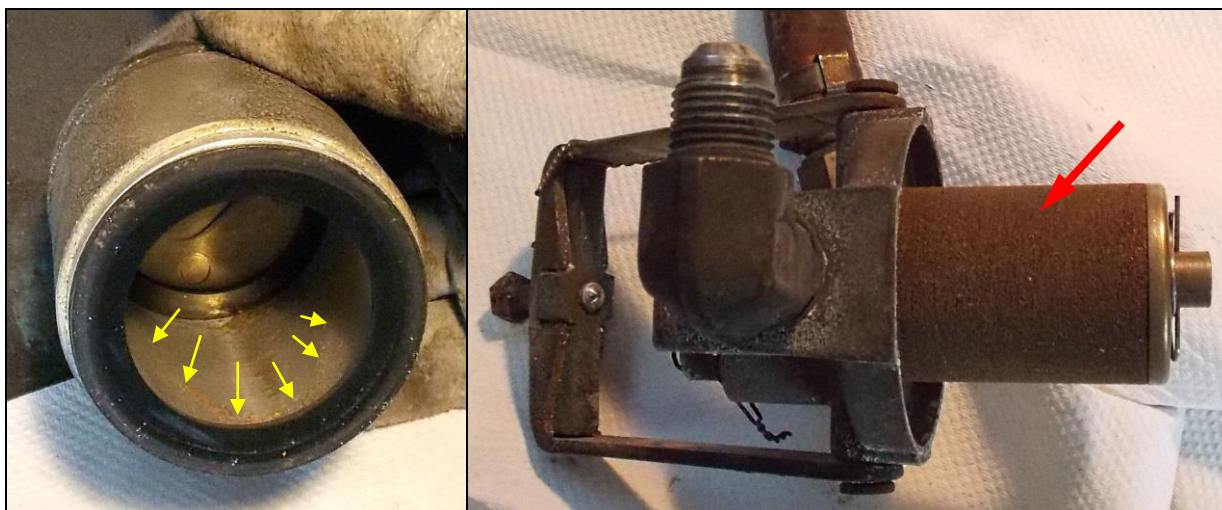
50, 51 – Filtr paliwa rozebrany na podstawowe części. Widoczny oznaczony grotami żółtych strzałek ślad osadu, wskazujący na obecność powierzchni płynu (paliwa) przy nienormalnej (znacznie przechylonej) pozycji kadłuba utrzymującej się przez dłuższy czas. Na powierzchni elementu filtrującego (strzałka czerwona) brak widocznych zanieczyszczeń.
