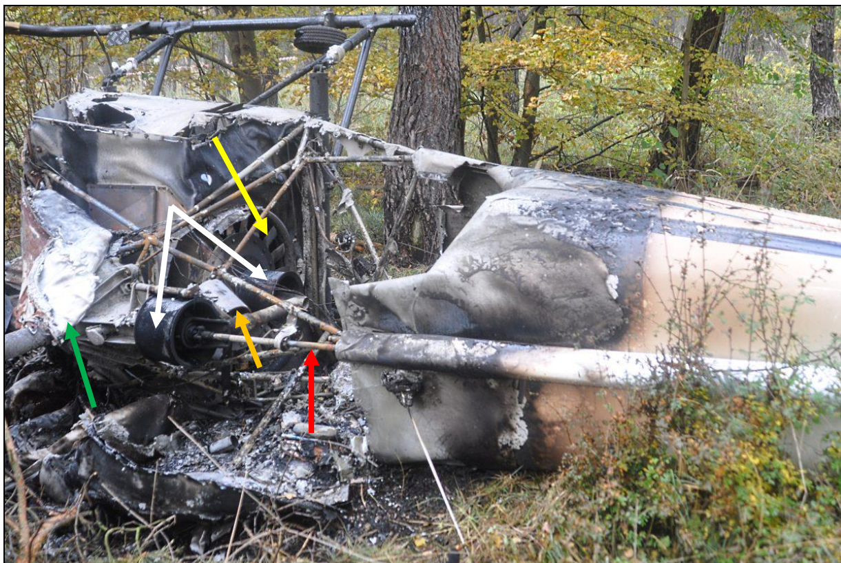
27 – Widok wypalonego kratownicowego przedziału kadłuba za silnikiem od strony grzbietu. Widoczny wentylator silnika (strzałka żółta) oraz koła przekładni pasowej (strzałki białe), koło napinające (strzałka pomarańczowa) i wał transmisyjny napędu śmigła ogonowego (strzałka czerwona). Strzałką zieloną wskazane resztki prawego zbiornika paliwa. Zwraca uwagę zasięg nadpalenia pokryć belki ogonowej [foto: Policja].
