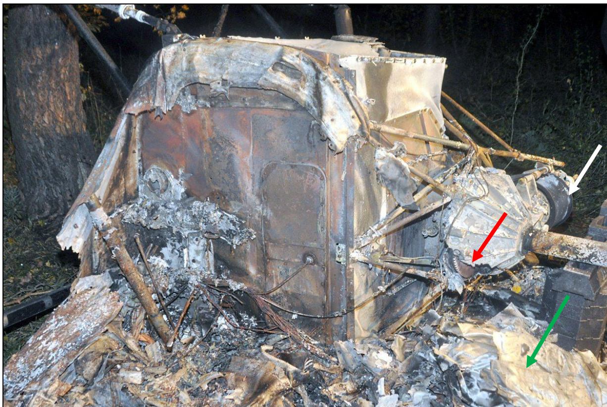
30 – Całkowicie wypalona i stopiona kabinowa część kadłuba (na pierwszym planie) oraz mniej uszkodzony przedział silnika z zamocowaną do niego przekładnią zębatą wirnika głównego – zbliżenie kadłuba leżącego na lewym boku od góry. Zwraca uwagę znaczne uszkodzenie (nadtopienie) skorupy korpusu przekładni [strzałka czerwona]. Widoczne górne koło przekładni pasowej (strzałka biała) i resztki prawego zbiornika paliwa (strzałka zielona) – po oderwaniu od wraku.
