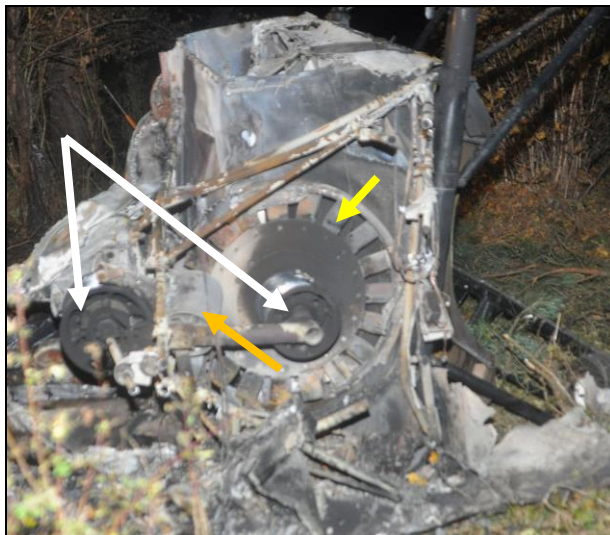
33 – Przedział silnikowy kadłuba odcięty od reszty wraku, widoczny od tyłu. Widoczny wentylator silnika (strzałka żółta) oraz koła przekładni pasowej (strzałki białe) i koło napinające (strzałka pomarańczowa).
