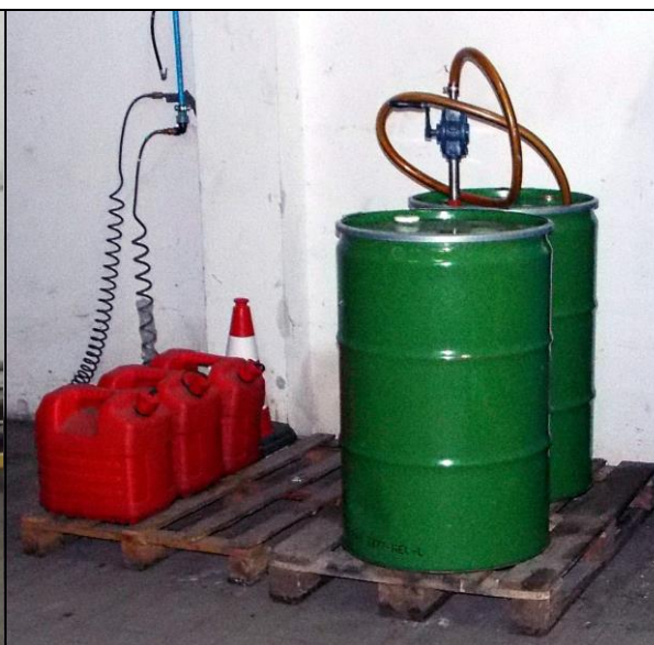
53 – Beczki 200-litrowe na paliwo z ręczną pompą i 20-litrowe kanistry na paliwo, pozostawione w miejscu stałego stacjonowania śmigłowca.
