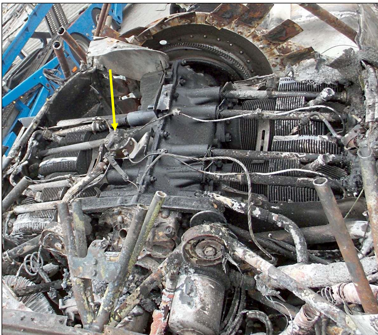
47 – Silnik w widoku od góry i od strony agregatów, wrak zdemontowany. Widoczne urządzenie wtryskowe na korpusie silnika.
