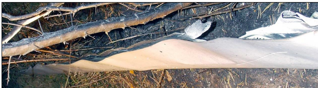
26 – Łopata nr 2 wirnika głównego – uszkodzenia splotu charakterystyczne dla uderzenia w płaską przeszkodę na całej długości noska [foto: Policja].
