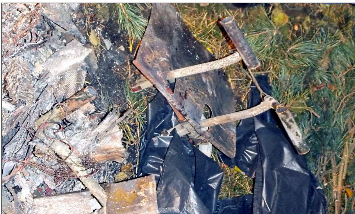
32 – Sterownice nożne wraz z fragmentami podłóg w wypalonych szczątkach kabiny.
