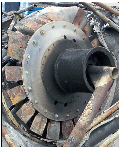
45 – Wentylator silnika. Stan łopatek świadczy, że w chwili zderzenia z ziemią nie obracał się.
