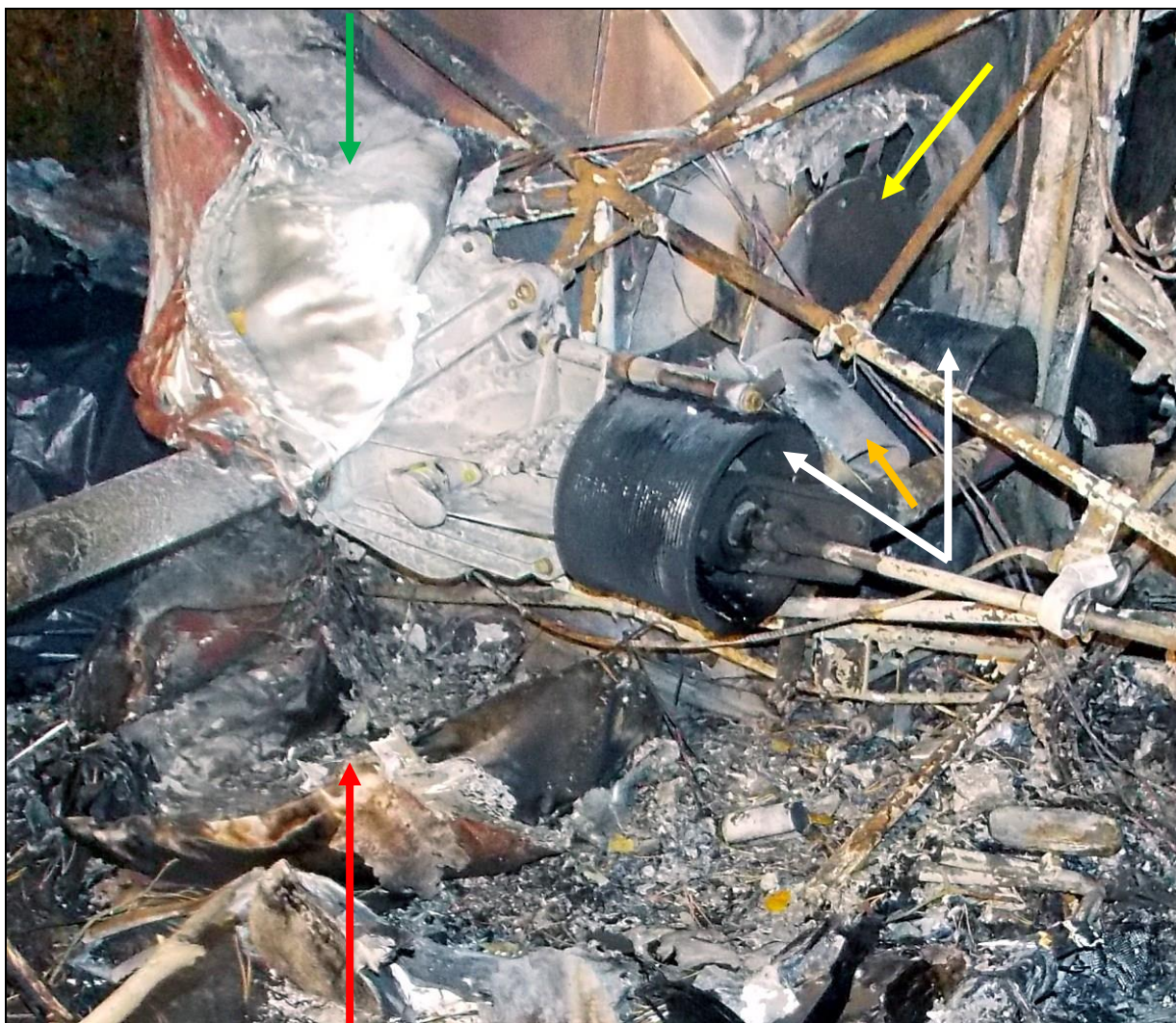
31 – Zbliżenie kadłuba leżącego na lewym boku. Zielona strzałka - prawego zbiornika paliwa, czerwona – resztki lewego zbiornika paliwa, białe – koła pasowe przekładni, pomarańczowa – koło napinające przekładni pasowej, żółta – wentylator silnika.
