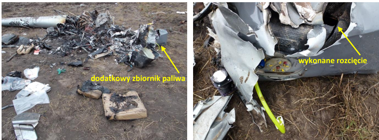
Foto 4. Usytuowanie dodatkowego zbiornika paliwa na miejscu wypadku i wykonane rozcięcie w celu pobrania próbki paliwa do badania
