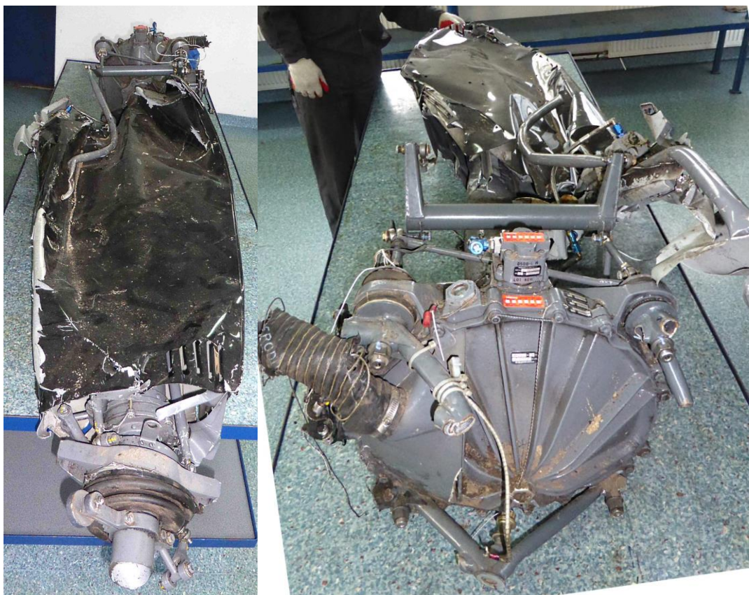
Foto 7. Ogólny widok stanu przekładni
