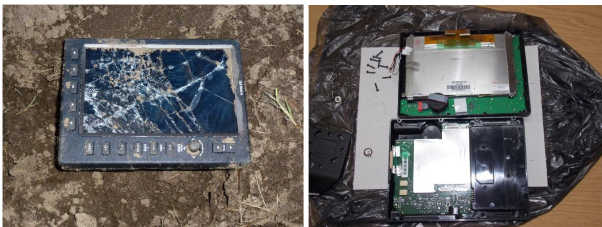
Foto 15. Widok urządzenia GPSMAP 695 na miejscu wypadku i po otwarciu obudowy
