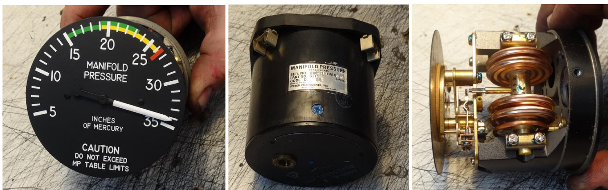
Foto 12. Wskaźnik ciśnienia ładowania
