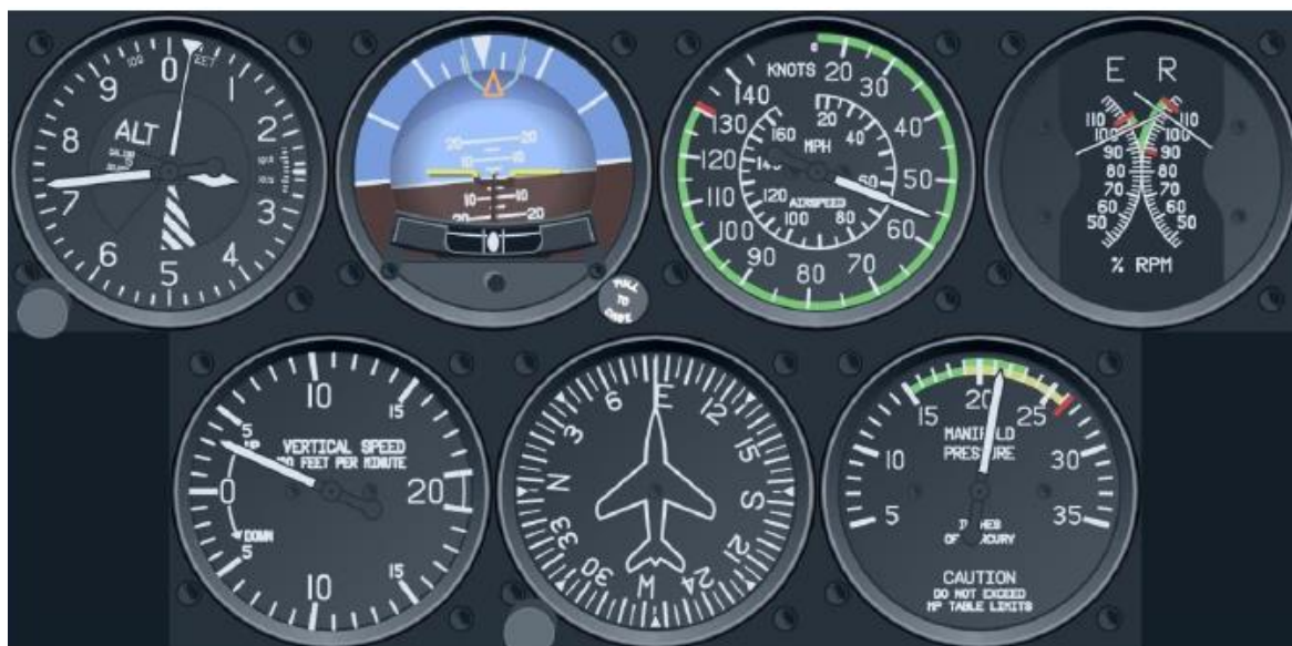
Foto 16.. Przykładowy panel przyrządów śmigłowca R44
