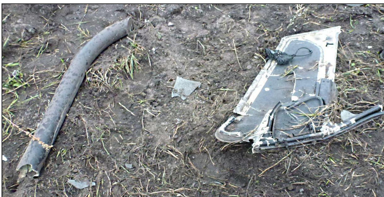
21 – Fragment złamanej lewej płozy podwozia (po lewej) i fragment lewych przednich drzwi kabiny (po prawej).
