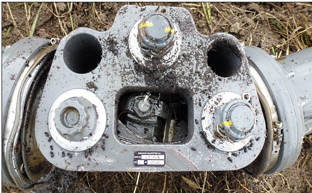
86 – Głowica wirnika głównego, zbliżenie, widok z boku.
