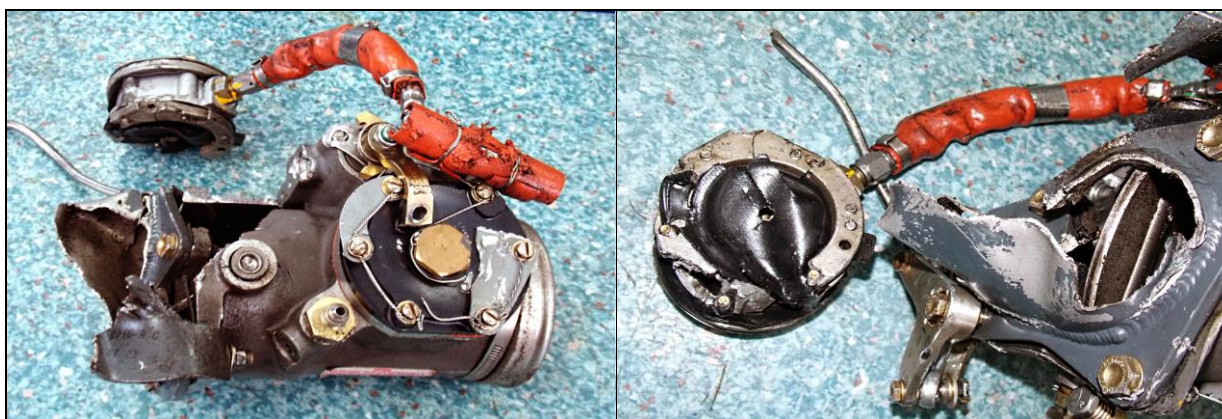
71, 72 – Zniszczona pompa paliwowa silnika z serwomechanizmem.
