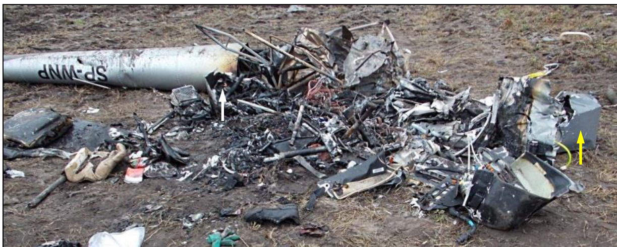
24 – Szczątki kadłuba i spalonego wnętrza kabiny. Żółtą strzałką wskazany uszkodzony pomocniczy zbiornik paliwa, który znalazł się poza strefą pożaru i zachował szczelność; białą – zniszczony główny zbiornik paliwa.
