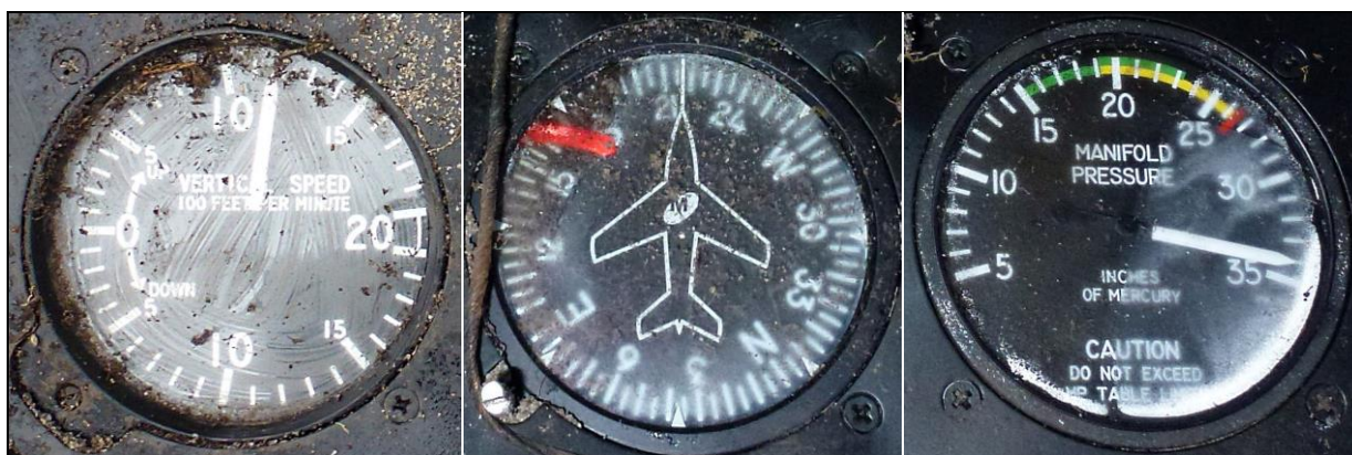
54, 55, 56 – Zbliżenie na przyrządy pokładowe – od lewej wariometr, busola i wskaźnik ciśnienia ładowania.
