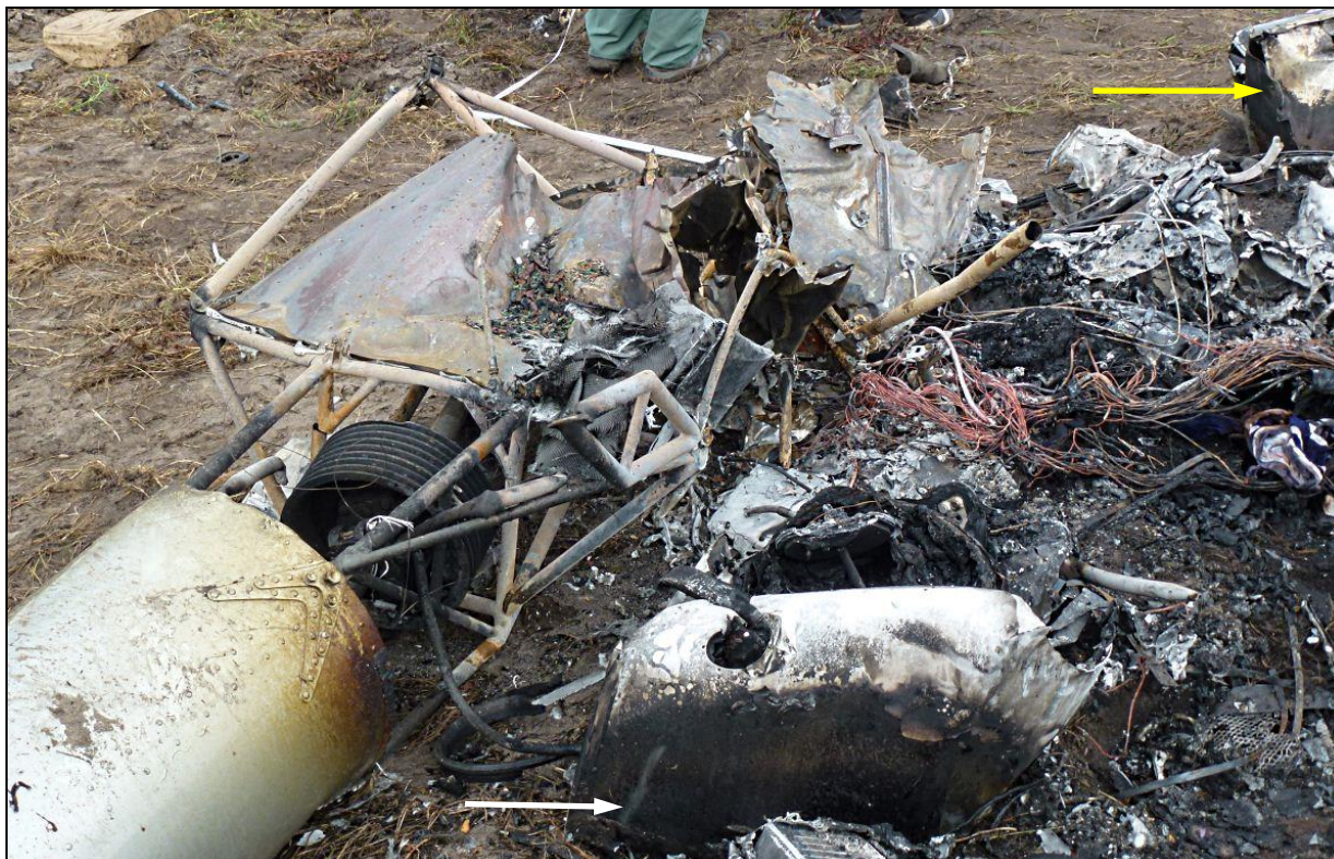
39 – Szczątki kadłuba zniszczonego wskutek rozbicia i pożaru. Żółtą strzałką wskazany pomocniczy zbiornik paliwa, białą strzałką – zniszczony główny zbiornik paliwa. Dobrze widoczna zniszczona kratownica środkowej części kadłuba i zdeformowana pozioma przegroda ogniowa.
