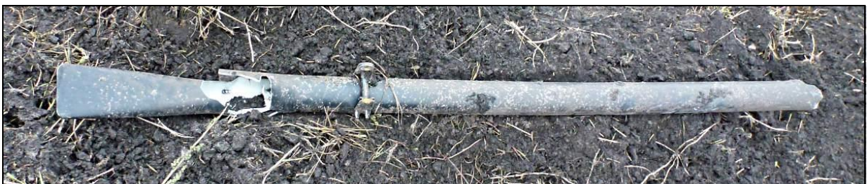
17 – Lewa płoza podwozia – pierwszy element oddzielony od śmigłowca po kontakcie z ziemią.
