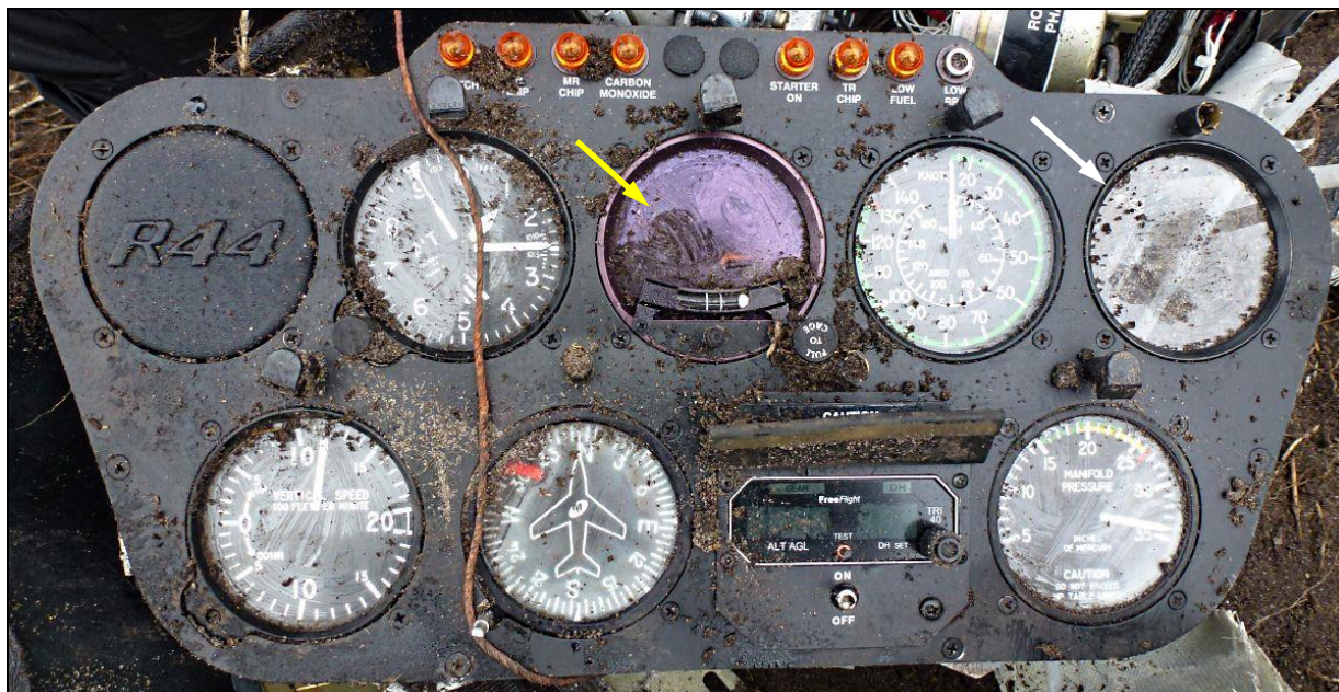
50 – Tablica przyrządów. Żółtą strzałką wskazany sztuczny horyzont (częściowo odłamany od tablicy i niewidoczny przez szybkę), białą – miejsce po odłamaniu obrotomierzu.
