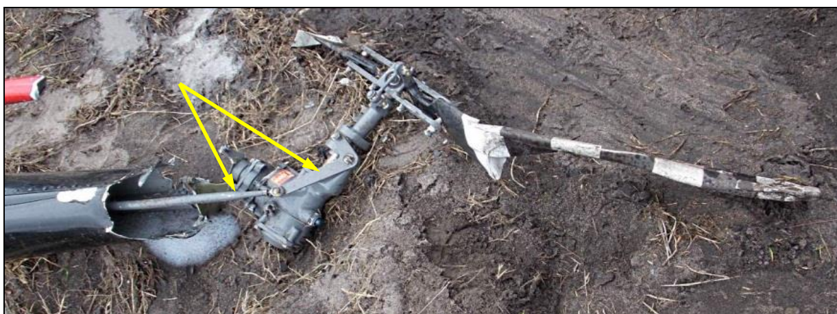
31 – Zniszczone śmigło ogonowe z przekładnią kątową, oderwaną od konstrukcji belki ogonowej. Widoczny popychacz i dźwignia sterowania skokiem łopatek śmigła ogonowego (wskazane strzałkami) – układ sterowania śmigłem ogonowym zachował ciągłość kinematyczną w tym rejonie konstrukcji.
