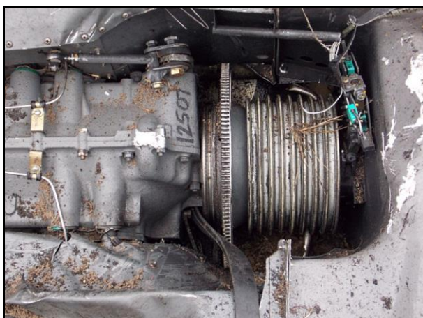
68 – Silnik – dolne koło przekładni pasowej.
