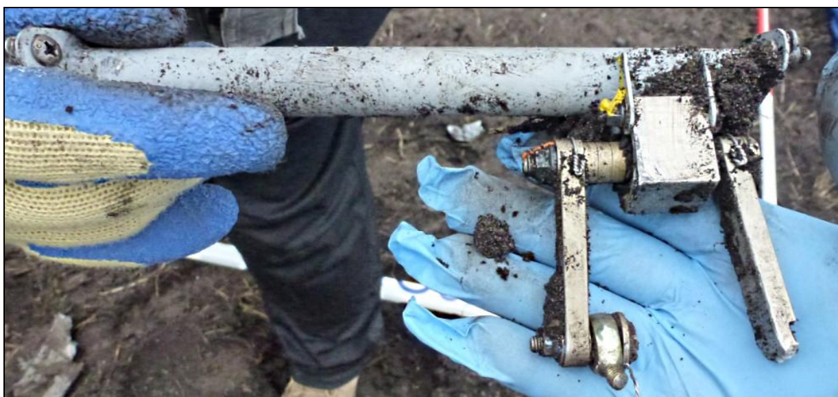
22 – Jeden z elementów układu sterowania z przedniej części kadłuba.
