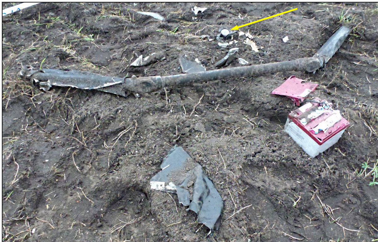
18 – Przednie golenie podwozia, wyłamane z konstrukcji kadłuba. Z prawej strony widoczny akumulator, strzałką wskazana busola magnetyczna, oderwana od konstrukcji wiatrochronu.
