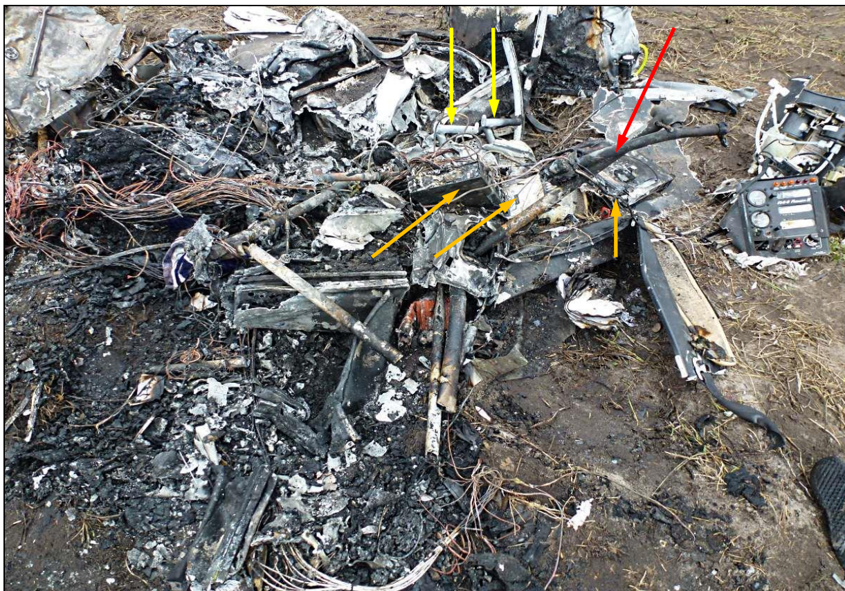
45 – Spalone szczątki wnętrza kabiny. Żółtymi strzałkami wskazane sterownice nożne, czerwoną – sterownica ręczna, pomarańczowymi – zniszczone elementy wyposażenia radiowego.
