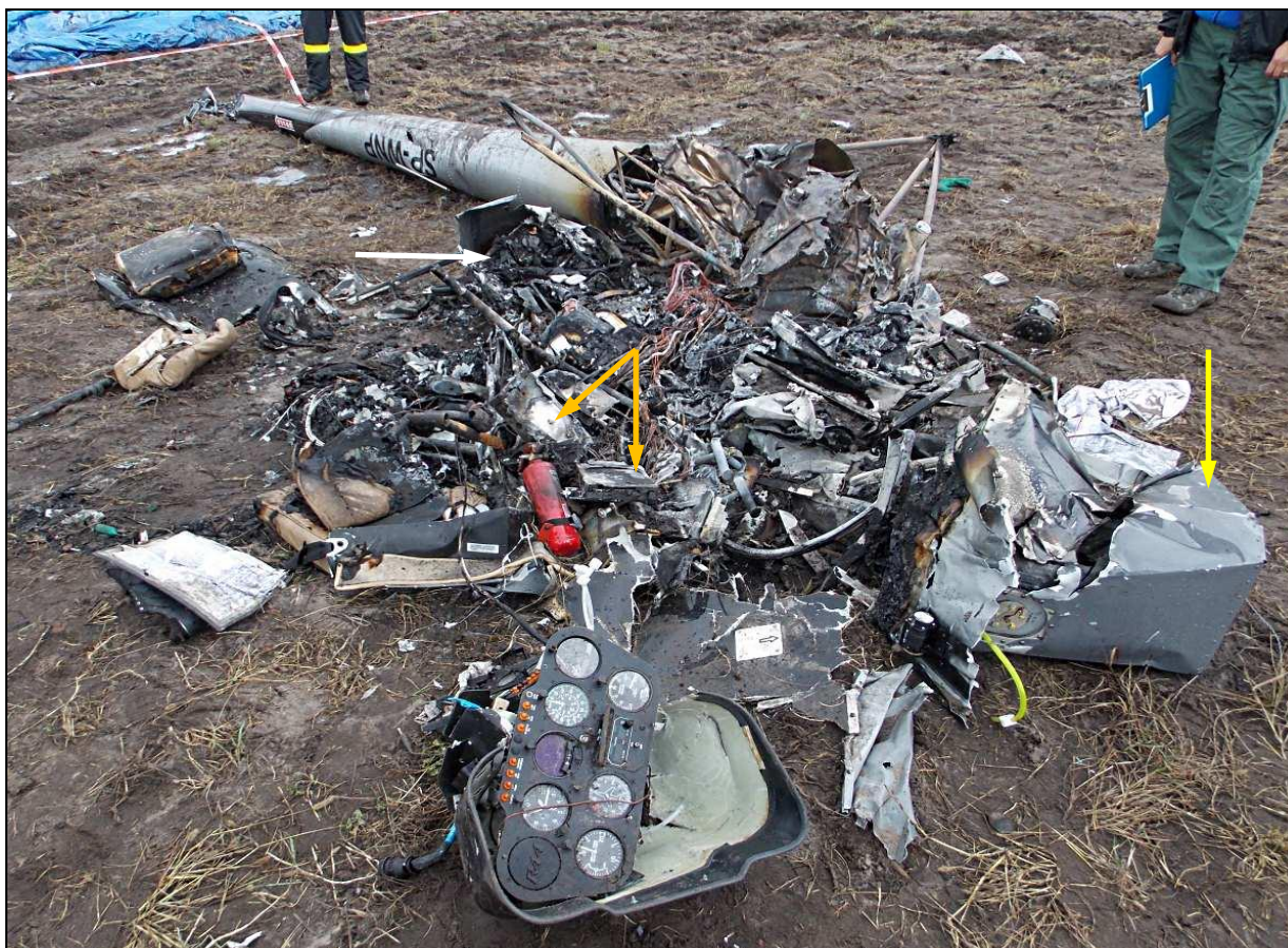
46 – Spalone szczątki kadłuba. Żółtą strzałką wskazany pomocniczy zbiornik paliwa, białą – zniszczony główny zbiornik paliwa, pomarańczowymi – zniszczone elementy wyposażenia radiowego.
