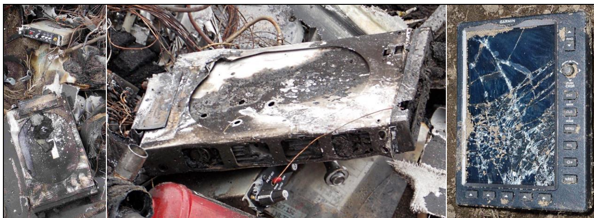
63, 64 – Zniszczone pożarem urządzenia łączności.
