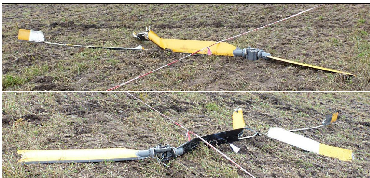
83, 84 – Dwa ujęcia (od góry i od dołu) zniszczonego wirnika głównego, oderwanego od konstrukcji śmigłowca.
