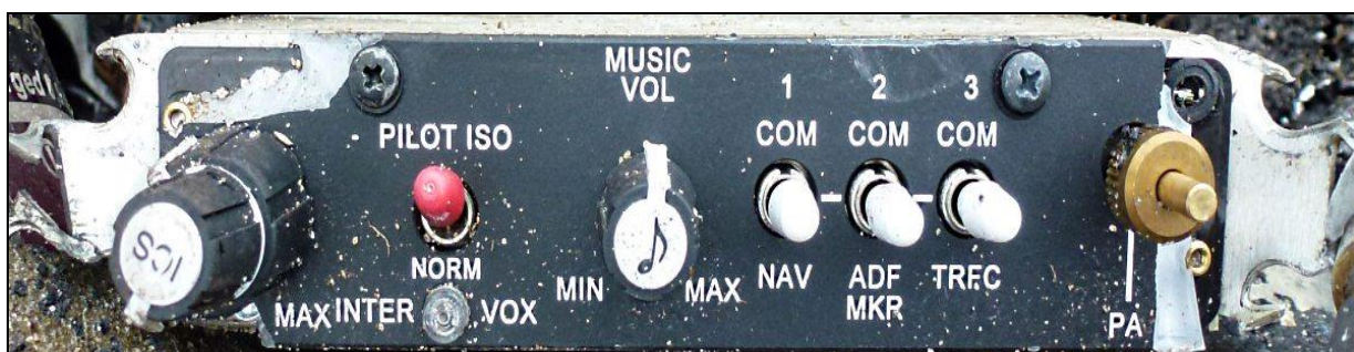
62 – Pulpit przełączników łączności wewnętrznej.
