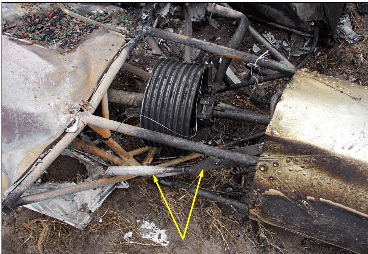
33 – Górne koło przekładni pasowej ze sprzęgłem wolnego koła. Strzałkami wskazana dźwignia pośrednia w układzie sterowania skokiem łopat śmigła ogonowego i fragment zniszczonego popychacza.
