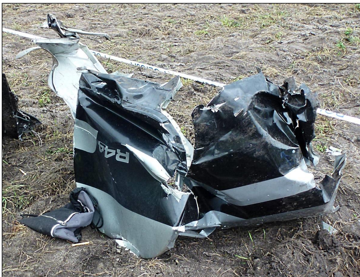
29 – Zniszczona tylna owiewka kadłuba – widok od strony zewnętrznej.
