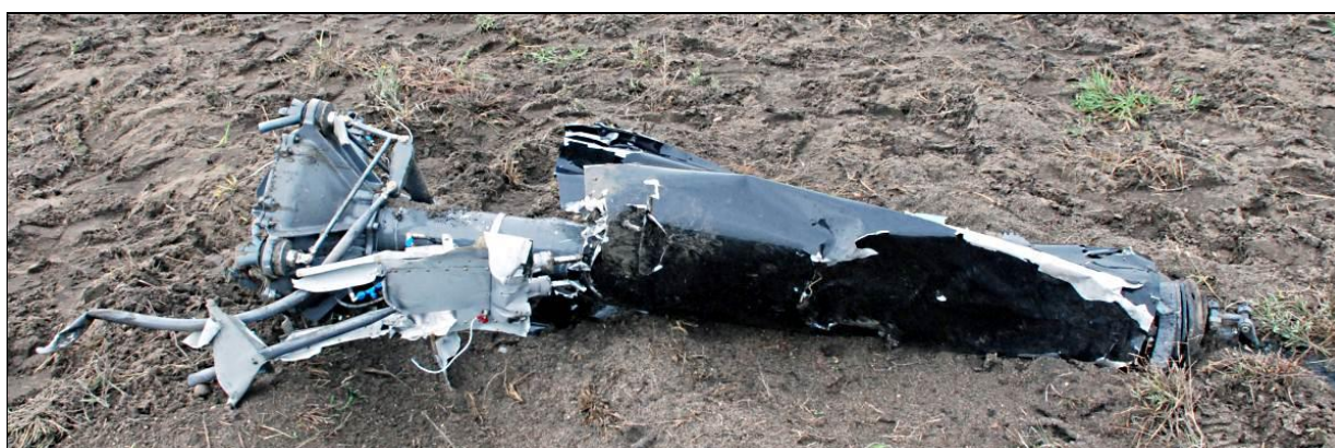
73, 74 – Powyżej i poniżej: oderwana od śmigłowca przekładnia zębata wirnika głównego, widok ogólny na miejscu wypadku, dwa ujęcia [foto: Policja].
