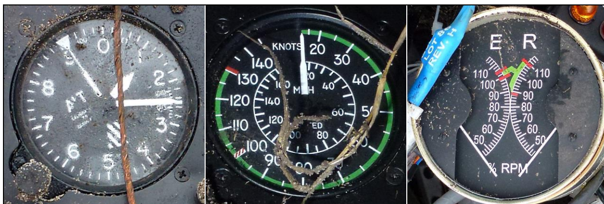
51, 52, 53 – Zbliżenie na przyrządy pokładowe – od lewej wysokościomierz, prędkościomierz oraz wskaźnik obrotomierzy silnika i wirnika głównego.
