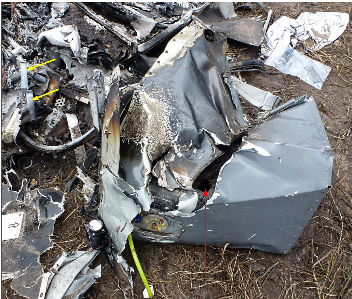
43 – Pomocniczy zbiornik paliwowy, który zachował szczelność po wypadku. Czerwoną strzałką wskazany otwór w płaszczu neoprenowym, wycięty dla pobrania próbki paliwa. Żółtymi strzałkami wskazane sterownice nożne.
