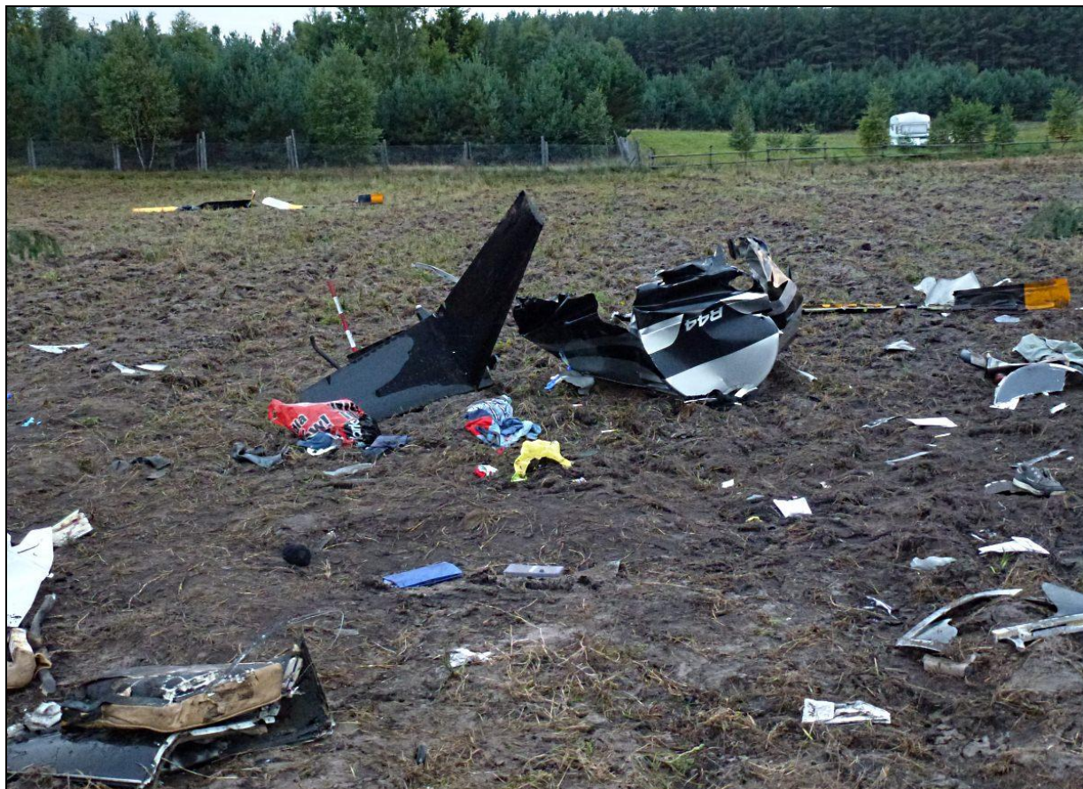
26 – Ogólny widok głównego pola szczątków, w centrum kadru oderwane usterzenie i zniszczona tylna owiewka kadłuba, w głębi wirnik główny.
