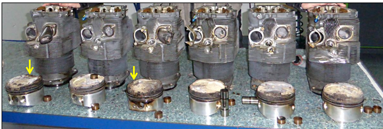
70 – Cylindry i tłoki silnika po demontażu – na tłokach cylindrów nr 1 i nr 3 wskazane strzałkami nagromadzenia gleby zassanej do silnika w chwili jego zderzenia z ziemią już po oderwaniu się od konstrukcji śmigłowca. Jest to niewątpliwy dowód działania silnika w chwili jego zderzenia z ziemią.
