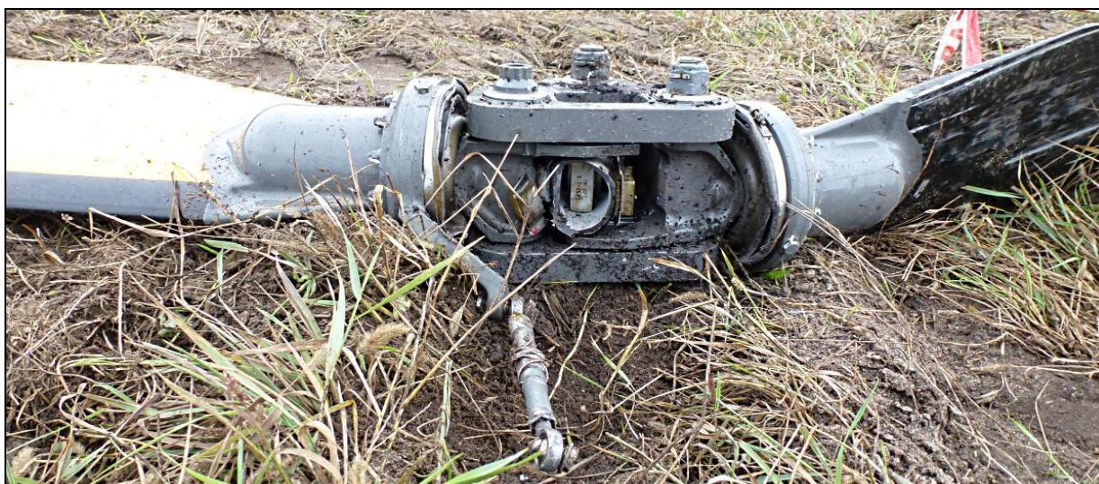
85 – Głowica wirnika głównego z łopatkami – widok od dołu.
