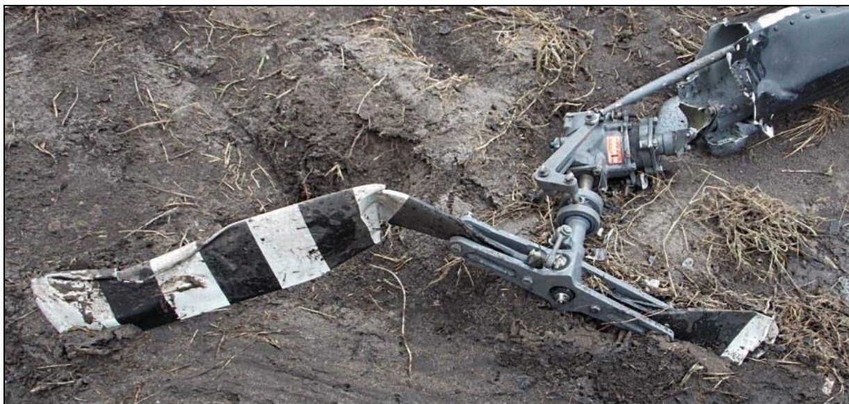
30 – Zniszczone śmigło ogonowe z przekładnią kątową, oderwaną od konstrukcji belki ogonowej.
