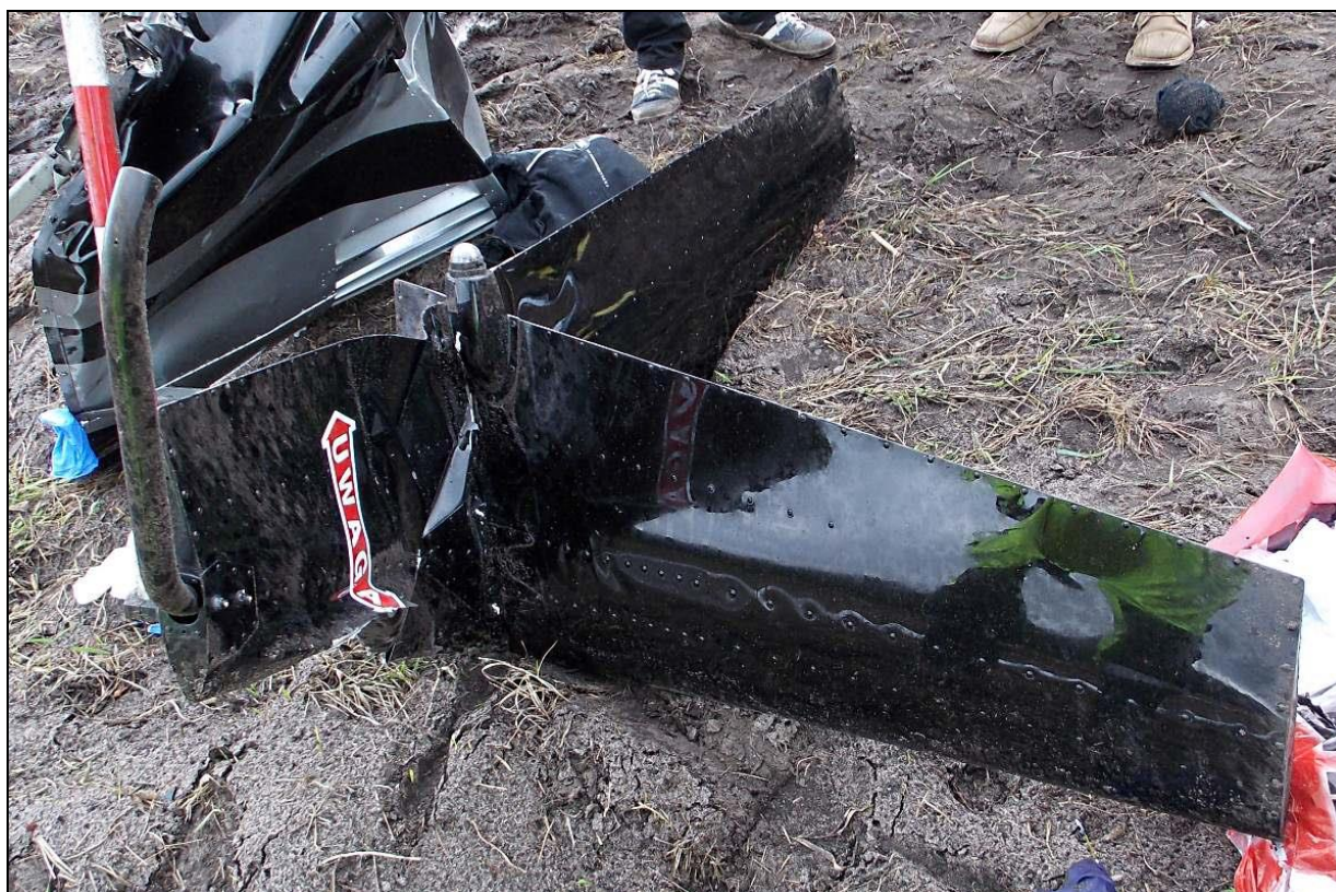
27 – Usterzenie oderwane od belki ogonowej.
