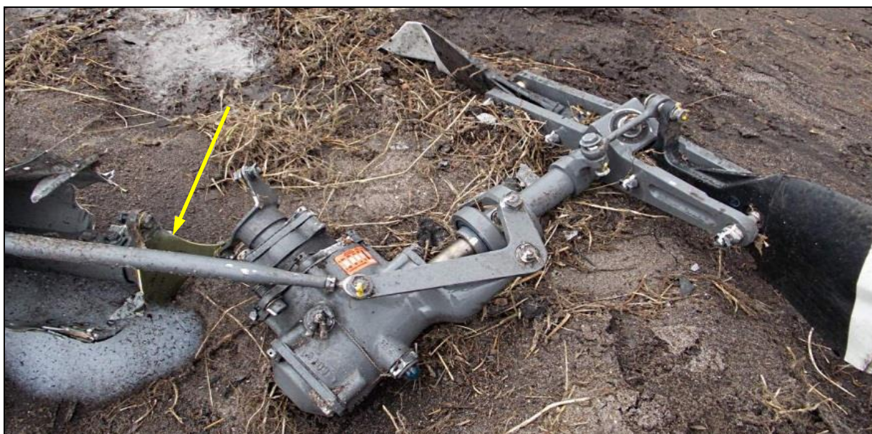
32 – Zniszczone śmigło ogonowe z przekładnią kątową, oderwaną od konstrukcji belki ogonowej. Strzałką wskazane częściowo rozerwane sprężęto łączące przekładnię kątową z wałem transmisyjnym w belce ogonowej.
