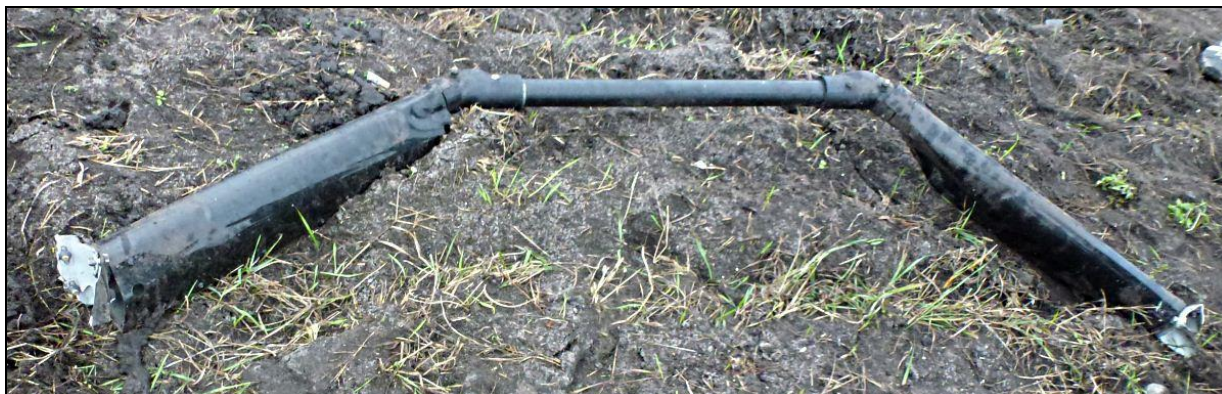
20 – Tylne golenie podwozia, wyłamane z konstrukcji kadłuba.
