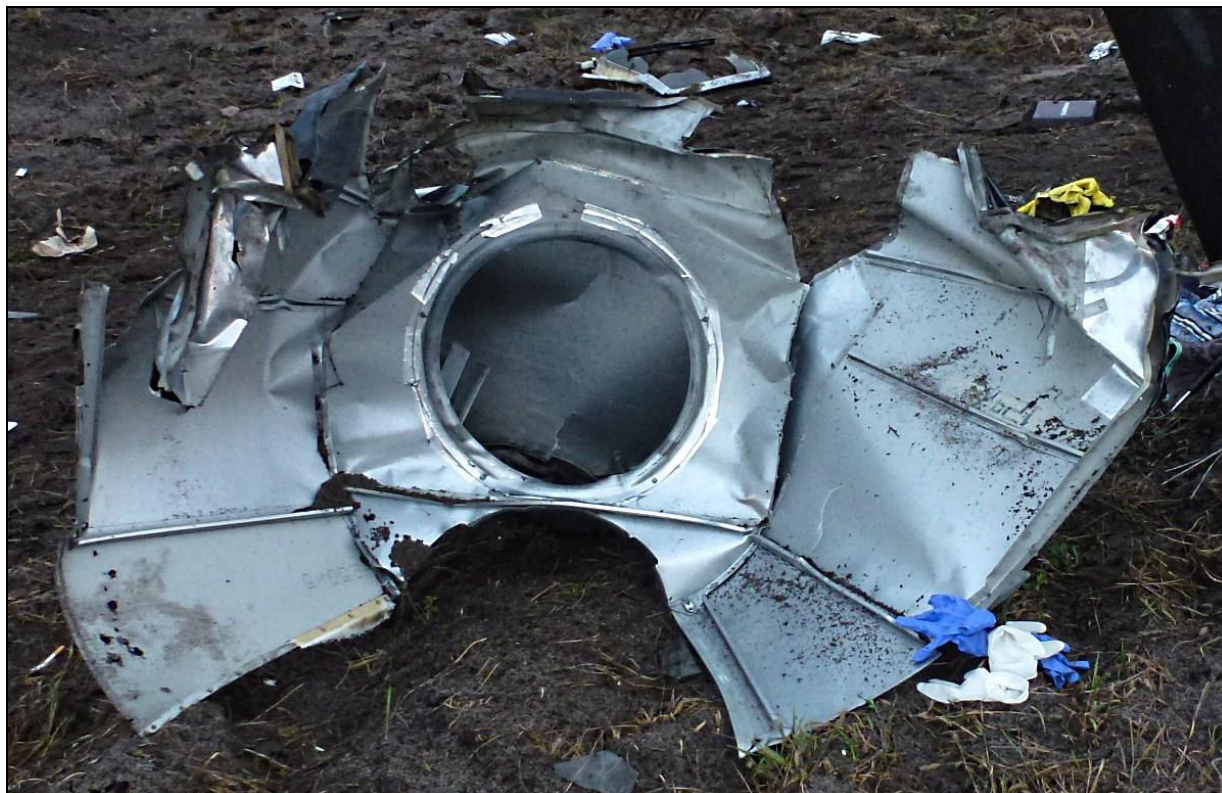
28 – Zniszczona tylna owiewka kadłuba – widok od strony wewnętrznej.
