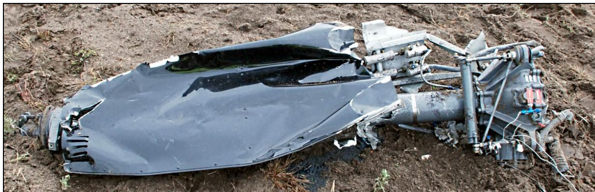
73, 74 – Powyżej i poniżej: oderwana od śmigłowca przekładnia zębata wirnika głównego, widok ogólny na miejscu wypadku, dwa ujęcia [foto: Policja].
