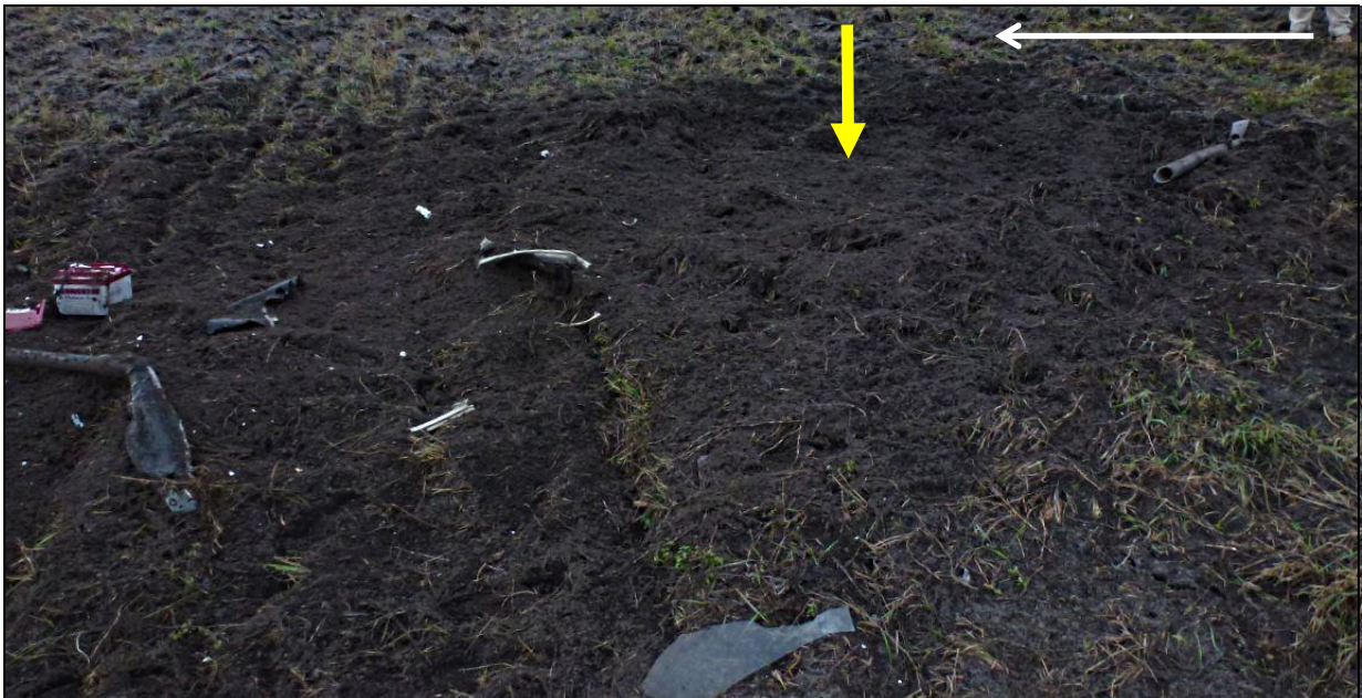
16 – Ślad zderzenia z ziemią, widok z lewej strony, zbliżenie. W obrębie śladu widoczne elementy zniszczonego podwozia, przedniej części kadłuba i oszklenia kabiny. Biała strzałka wskazuje kierunek ruchu śmigłowca, żółta strzałka – miejsce uderzenia kadłubem w ziemię.
