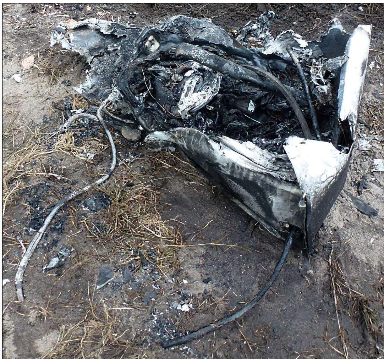
42 – Główny zbiornik paliwowy, rozerwany wskutek zderzenia z ziemią. Jego rozszczelnienie spowodowało znaczny wyciek paliwa, w wyniku którego nastąpił pożar.
