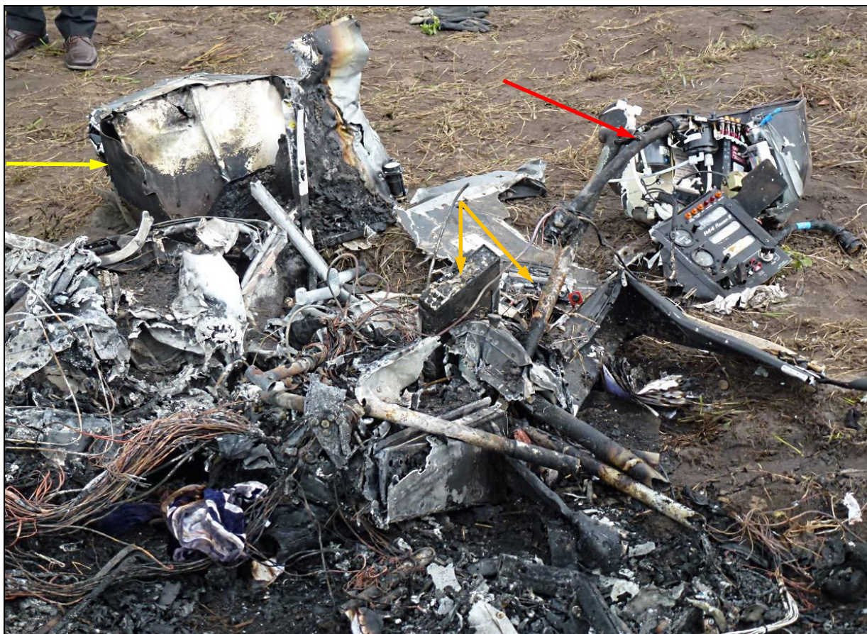
40 – Szczątki kadłuba zniszczonego wskutek rozbicia i pożaru. Żółtą strzałką wskazany pomocniczy zbiornik paliwa, pomarańczowymi strzałkami – zniszczone elementy wyposażenia radiowego i nawigacyjnego, czerwoną strzałką – sterownica ręczna.
