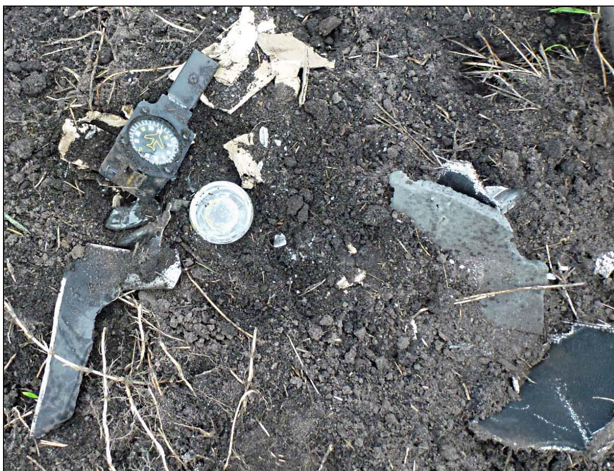
19 – Szczątki przedniej części kadłuba i busola magnetyczna, oderwana od konstrukcji wiatrochronu - zbliżenie.
