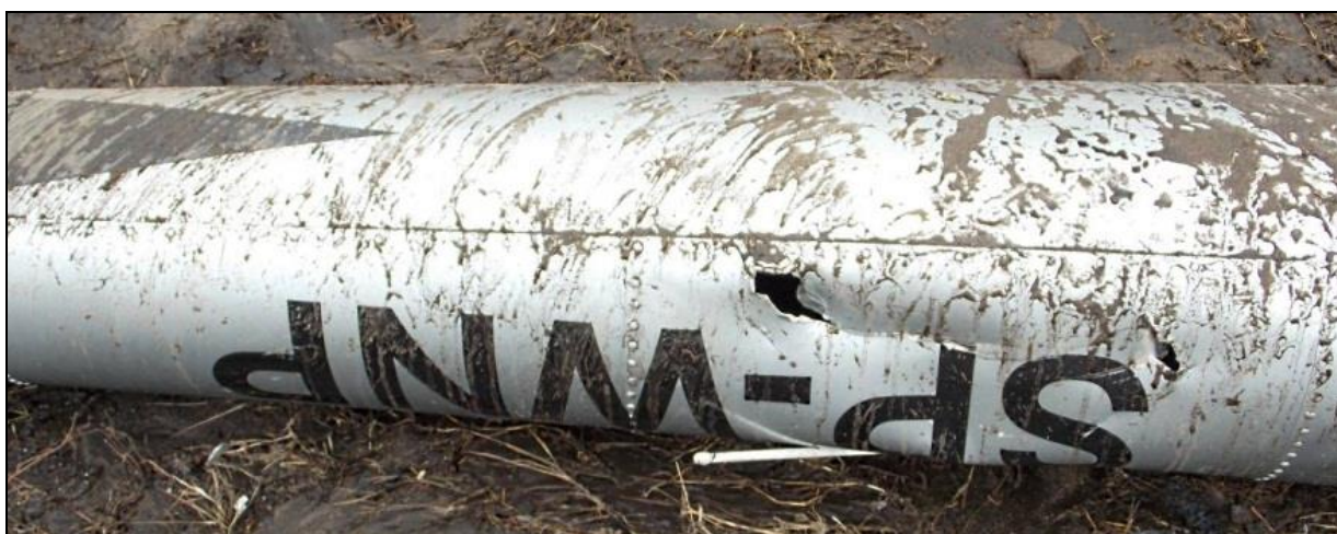
36 – Zbliżenie na środkową część belki ogonowej z lokalnym wgnieciem i przebicciem pokrycia przez odłamek konstrukcji rozpadającego się śmigłowca.
