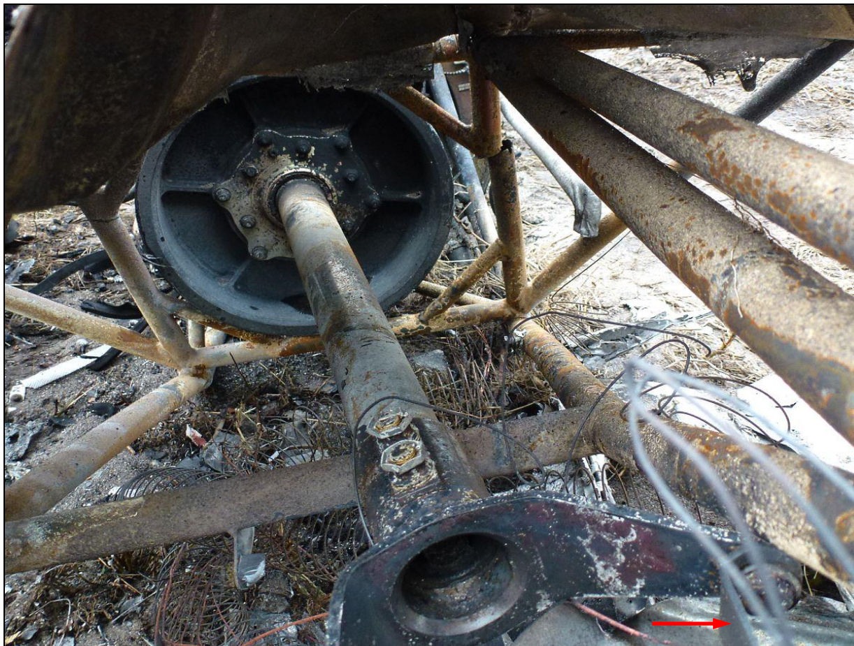
34 – Górne koło przekładni pasowej na wale. Na pierwszym planie sprzęgło przekładni wirnika głównego. Strzałką wskazany fragment ramienia sprzęgła odłamany od przekładni zębatej wirnika głównego.
