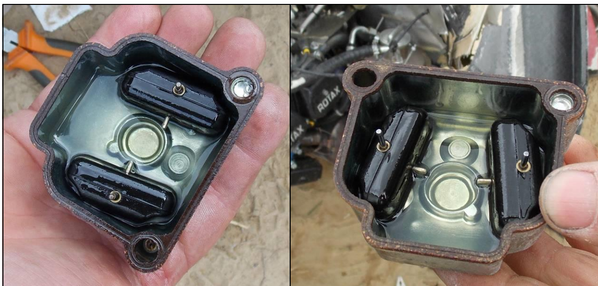
Rys.9. Komory pływakowe gaźników, lewego i prawego. Widoczny niski stan paliwa.
