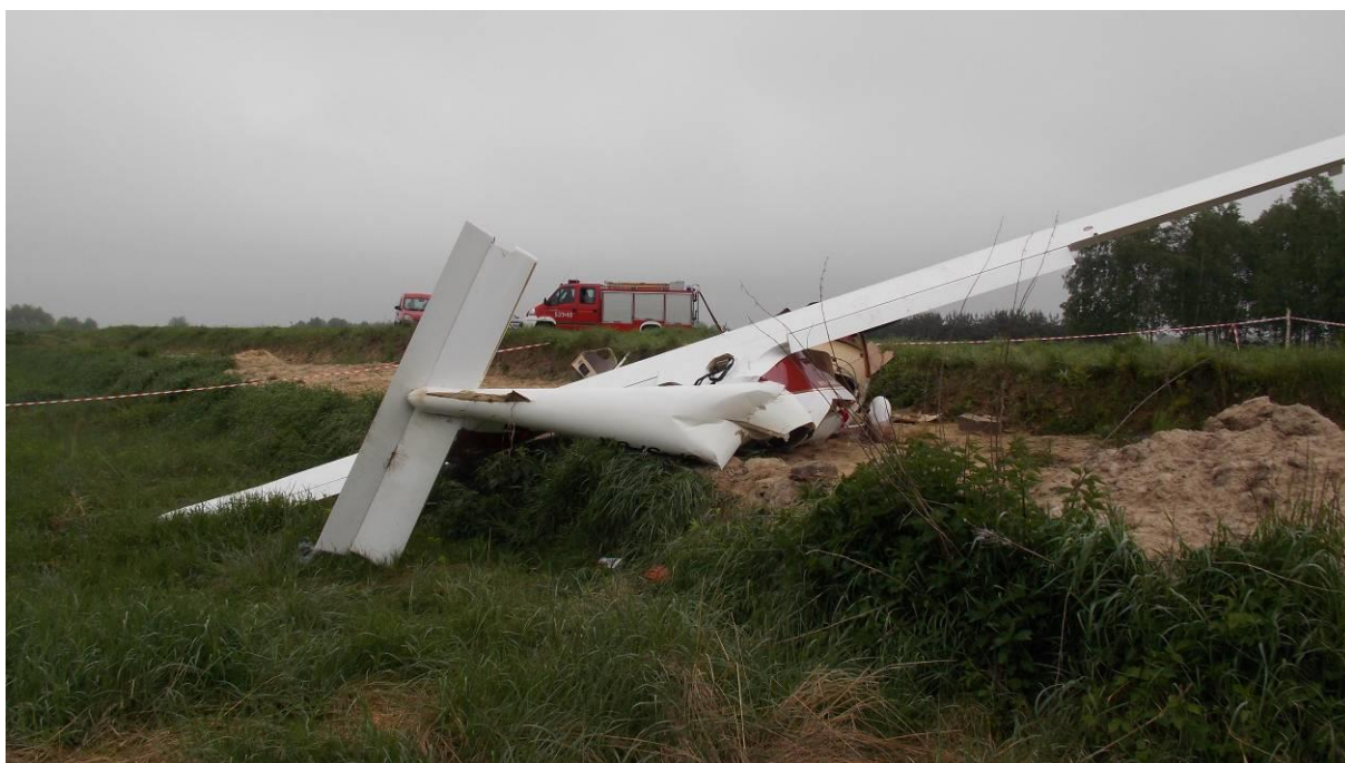
Rys.7. Położenie wraku na miejscu upadku. W tle po prawej stronie widoczne skrajne drzewa brzozowego lasu, o które samolot zahaczył podczas startu.
