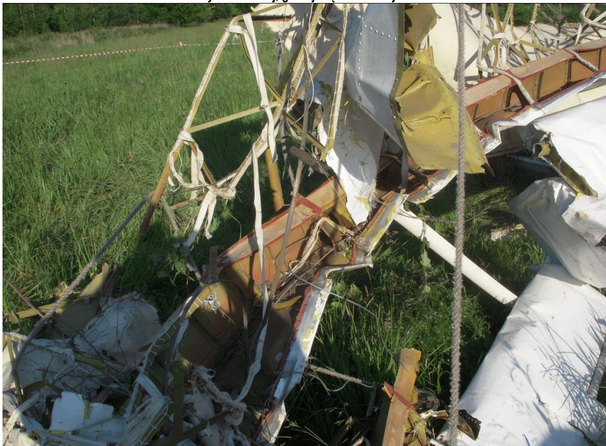
21 – Widok na zniszczoną strukturę lewego skrzydła.
