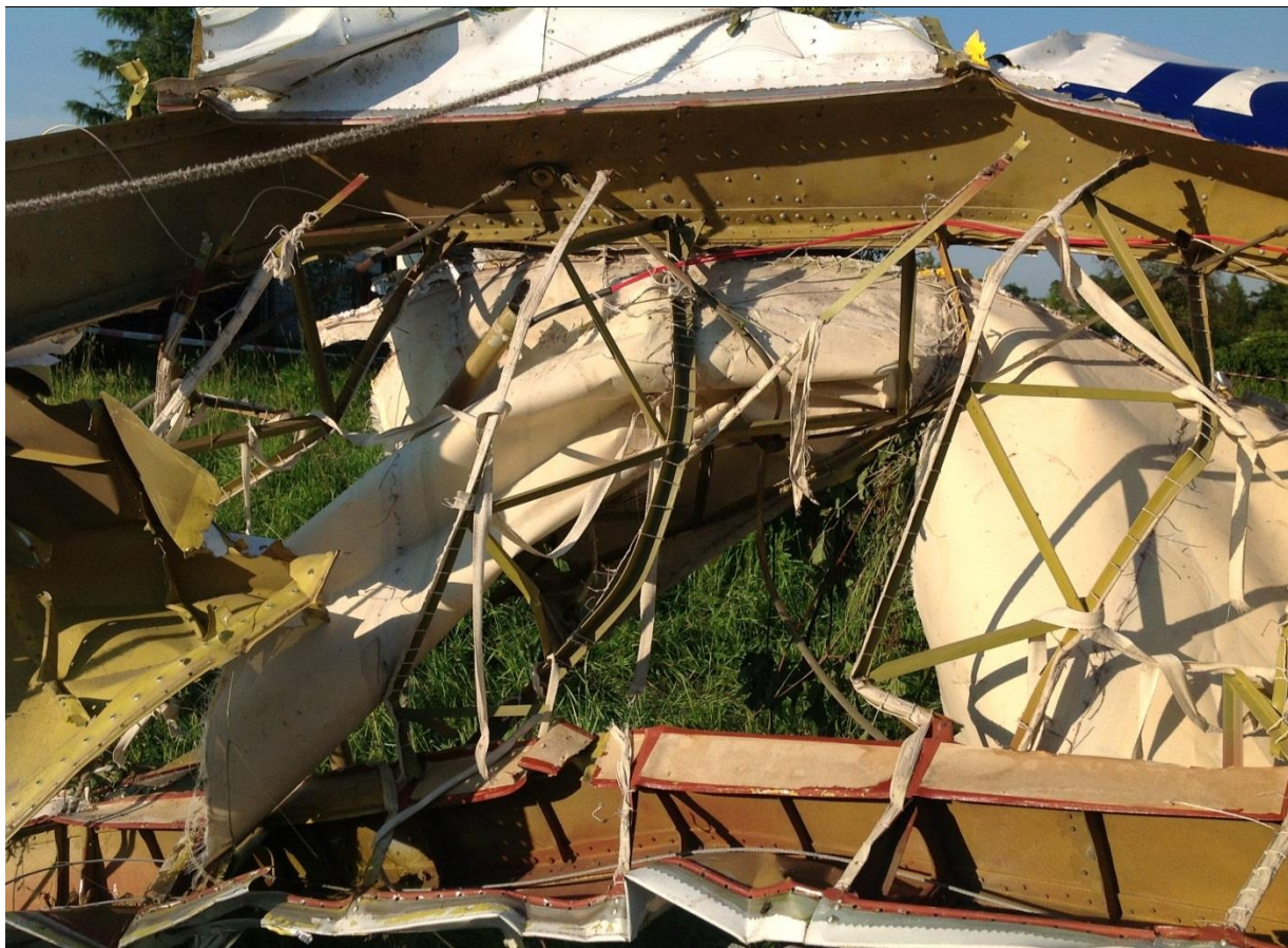
20 – Zbliżenie na zniszczone lewe skrzydło. W lewej, górnej części ilustracji widoczna liną holowniczą.
