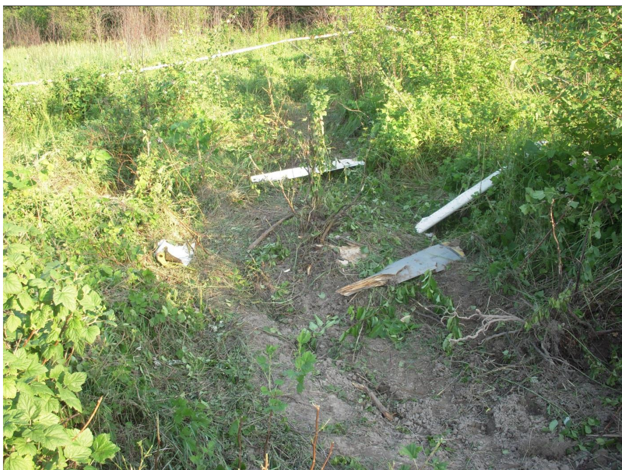
13 – Zbliżenie na miejsce uderzenia kadłuba o ziemię. Widoczna odłamana łopata śmigła i połamane elementy slotu lewego skrzydła.
