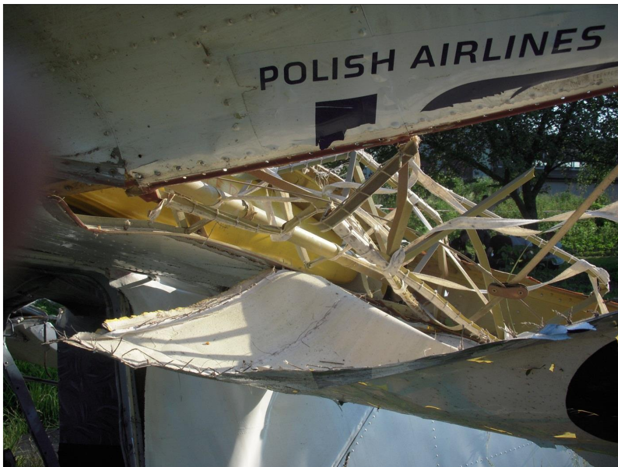
18 – Widok od spodu na przykadłubową część lewego skrzydła. Widoczne oderwane od kesonu płócienne pokrycie oraz porozrywane nici.
