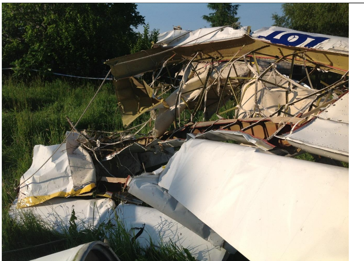
15 – Ogólny widok na uszkodzenia lewego skrzydła.
