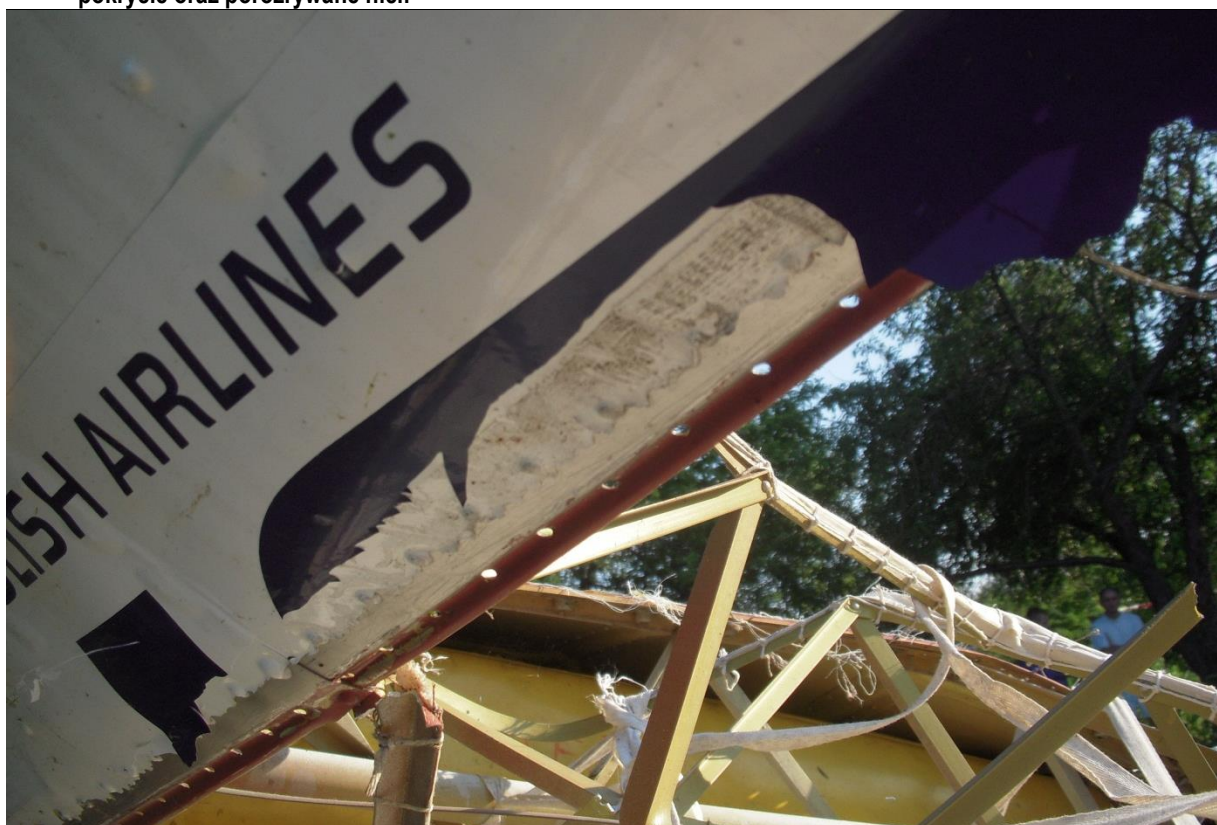
19 – Zbliżenie na miejsce mocowania płótna do kesonu. Widoczna porozrywana naklejka.
