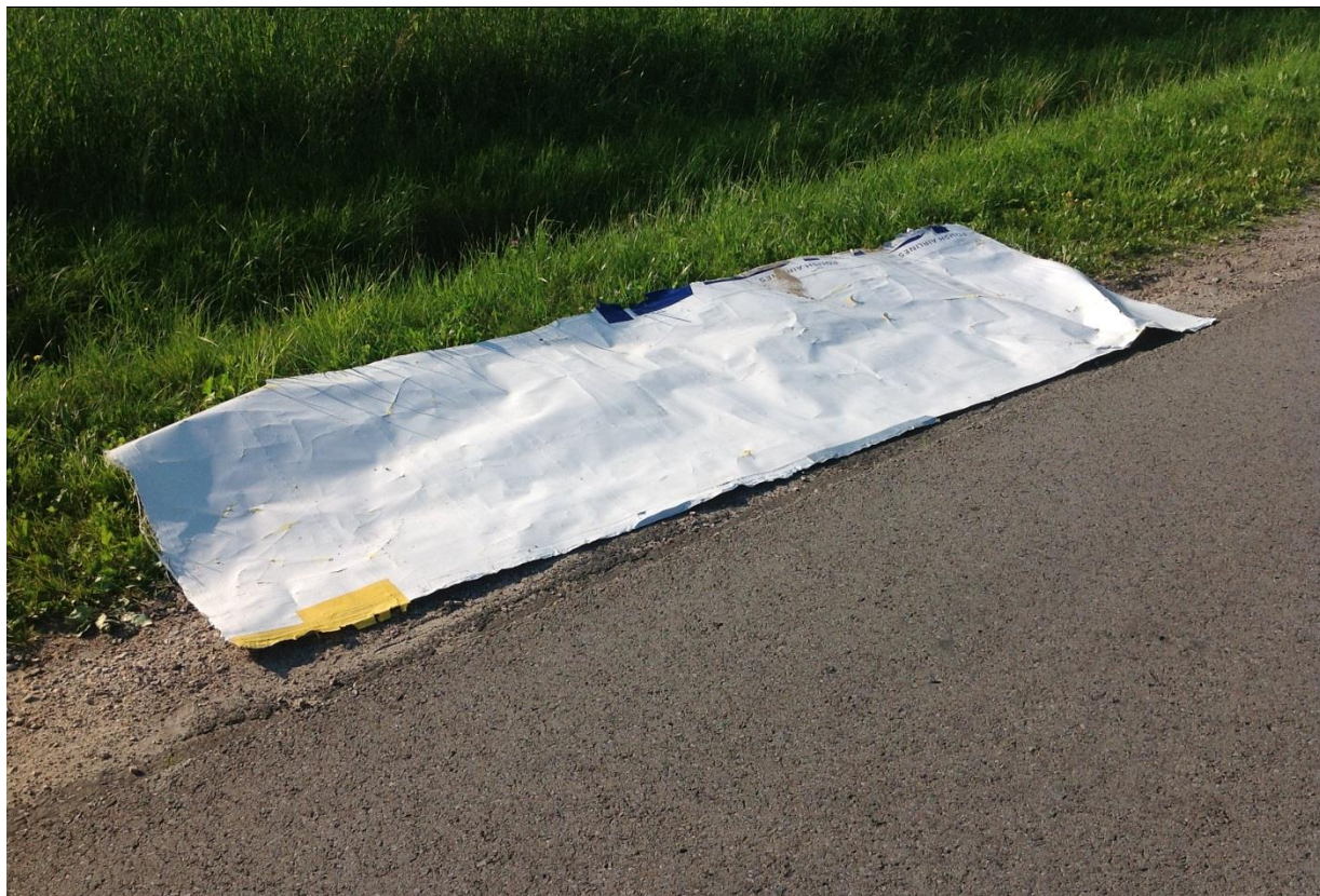
16 – Górne płócienne pokrycie lewego skrzydła (wymiary 3.2m x 1.2m) położone przez świadków na drodze w pobliżu miejsca zdarzenia.
