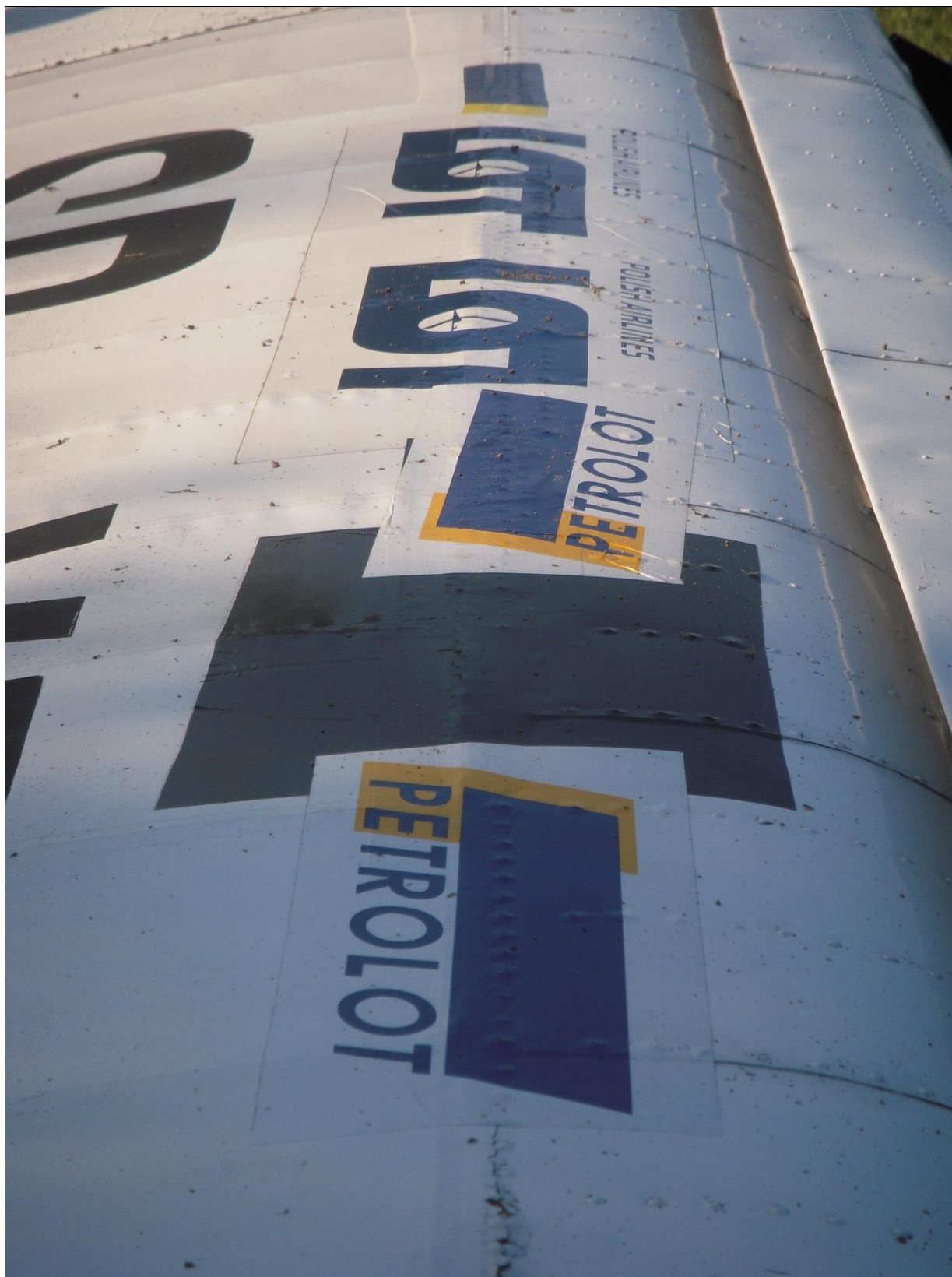
22 – Widok na górną powierzchnię prawego skrzydła. Widoczne liczne naklejki i taśmy klejące. Na dole ilustracji widoczne odklejenie taśmy zabezpieczającej przysycie płótna do konstrukcji skrzydła.
