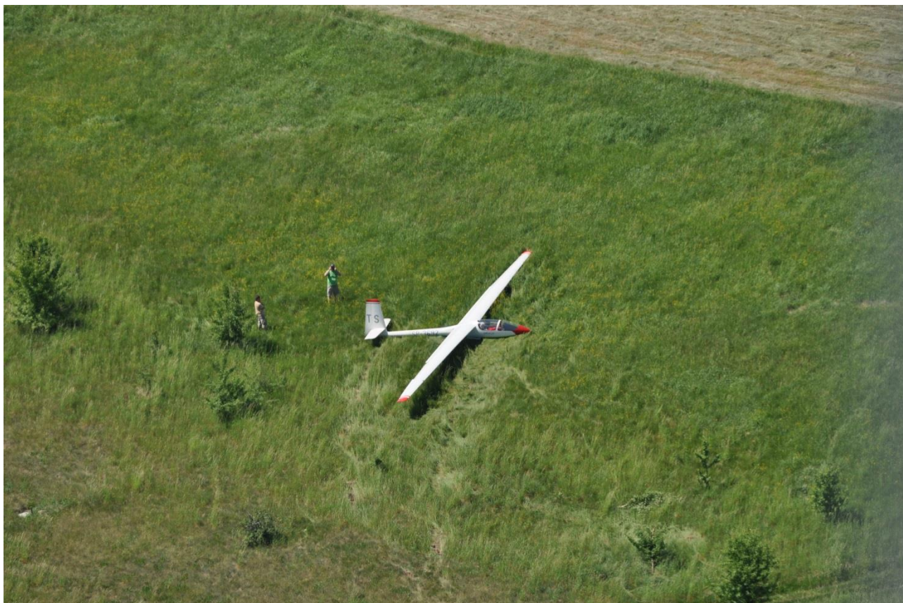
Fot. 2 Widoczne ślady obrotu w prawo i przesuwania się szybowca bokiem po trawie
