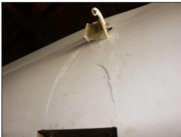
Rys.15 Zbliżenie na pęknięte dolne pokrycie statecznika poziomego
