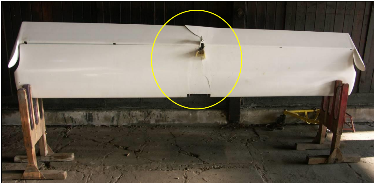
Rys.10 Ogólny widok uszkodzonego usterzenia poziomego szybowca; widoczne wyrwane z belki ogonowej tylne okucie mocowania usterzenia poziomego oraz popękane pokrycia dolne statecznika poziomego i steru wysokości
