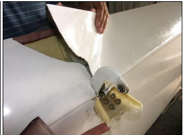
Rys.14 Zbliżenie na wyrwane tylne okucie oraz rozerwane dolne pokrycie steru wysokości
