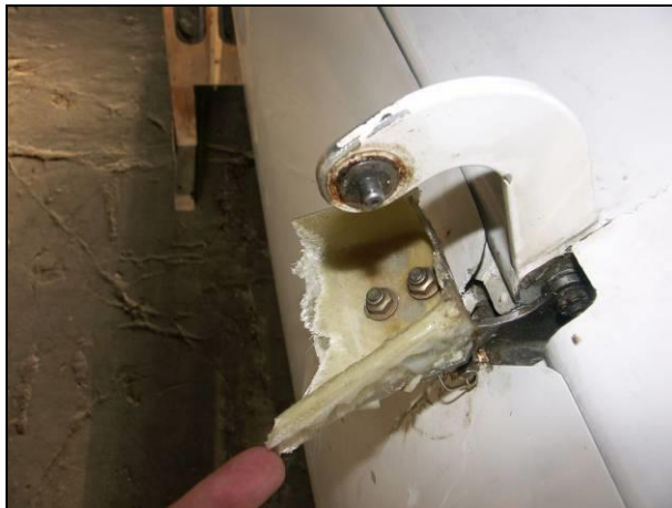
Rys.13 Zbliżenie na wyrwane z belki ogonowej tylne okucie mocowania usterzenia poziomego
