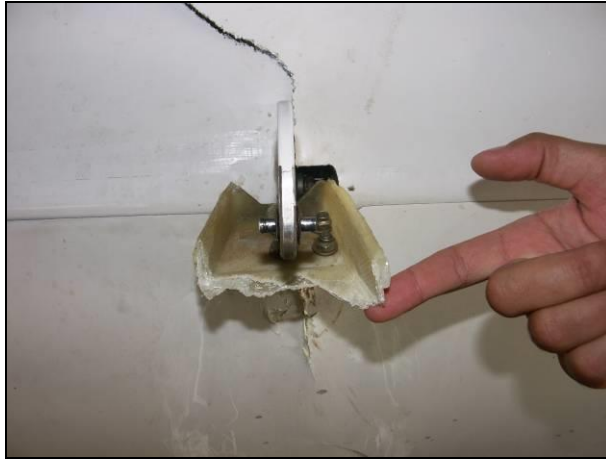
Rys.11,12 Zbliżenia na wyrwane z belki ogonowej tylne okucie mocowania usterzenia poziomego oraz popękane pokrycia dolne statecznika poziomego i steru wysokości
