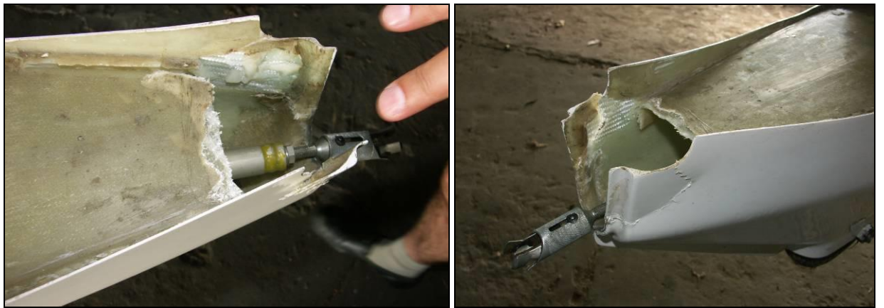
Rys.8,9 Zbliżenia na miejsce w belce ogonowej po wyrwanym tylnym okuciu mocowania usterzenia poziomego oraz uszkodzone połączenie napędu steru wysokości (złącza szybkorozłącznego)
