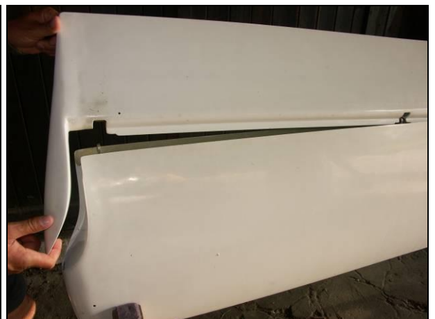
Rys.16 Oddzielenie na zawiasach steru wysokości od statecznika poziomego
