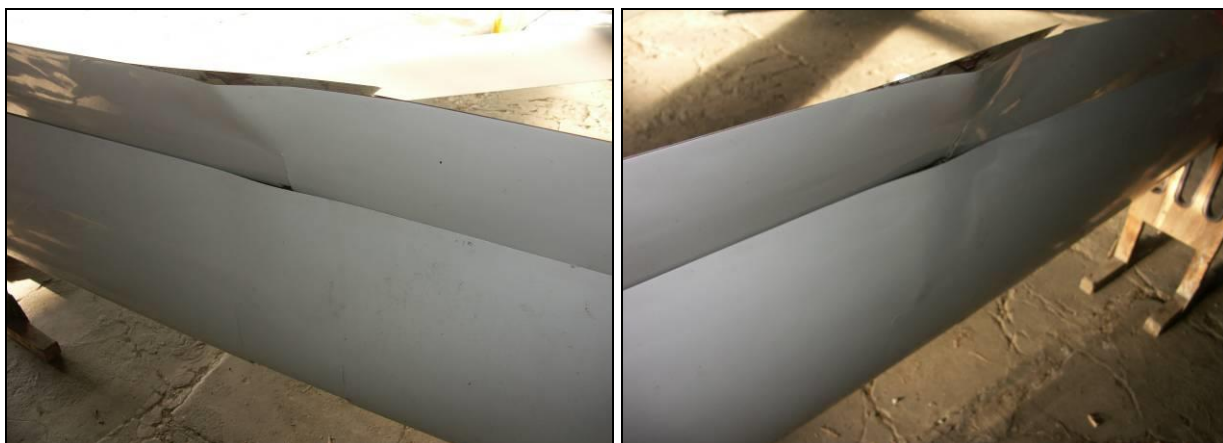
Rys.17,18 Rozklejenie krawędzi spływu steru wysokości z widocznym rozerwaniem jego dolnego pokrycia oraz pofalowania i pęknięcia na górnych pokryciach usterzenia poziomego
