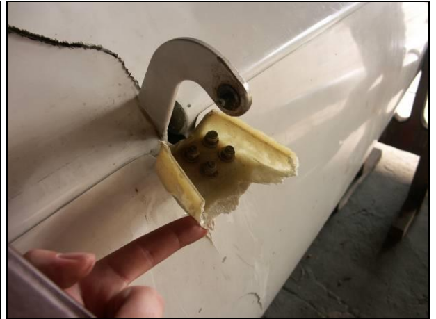
Rys.11,12 Zbliżenia na wyrwane z belki ogonowej tylne okucie mocowania usterzenia poziomego oraz popękane pokrycia dolne statecznika poziomego i steru wysokości
