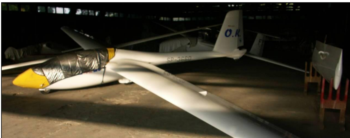
Rys.3 Ogólny widok uszkodzonego szybowca w hangarze (widoczne oderwane usterzenie poziome)
