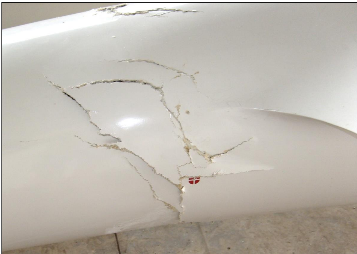
22 – Przełom kadłuba za skrzydłami, widok z prawej strony [AWM].
