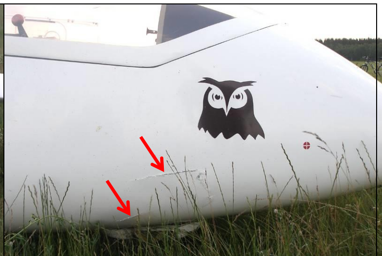
16 – Pęknięcia pokrycia kadłuba po prawej stronie przy zamocowaniu przedniego kółka [AWM].
