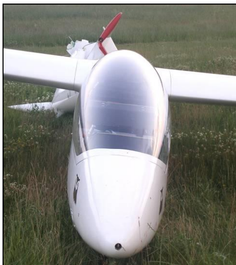
15 – Nosek kadłuba z przodu, widoczne pęknięcia pokrycia kadłuba po prawej stronie przy zamocowaniu przedniego kółka [AWM].
