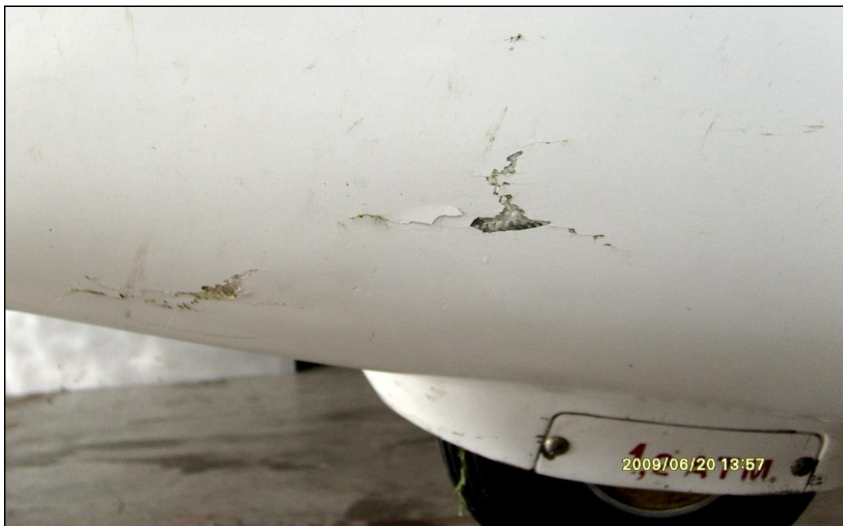
17 – Pęknięcia pokrycia kadłuba po lewej stronie przy zamocowaniu podwozia głównego [AWM].
