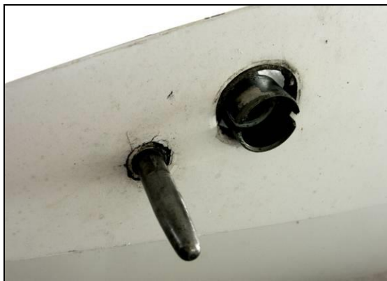
13 – Tylny sworzeń montażowy prawego skrzydła na kadłubie – widoczne pęknięcia materiału kompozytowego wokół obsady sworznia [AWM].
