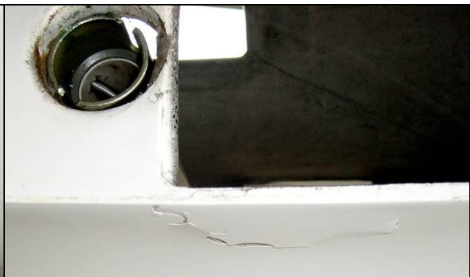
14 – Dolna krawędź otworu na dźwigar skrzydła po prawej stronie kadłuba – widoczne pęknięcia pokrycia lakierniczego, sygnalizujące możliwość pęknięcia materiału [AWM].
