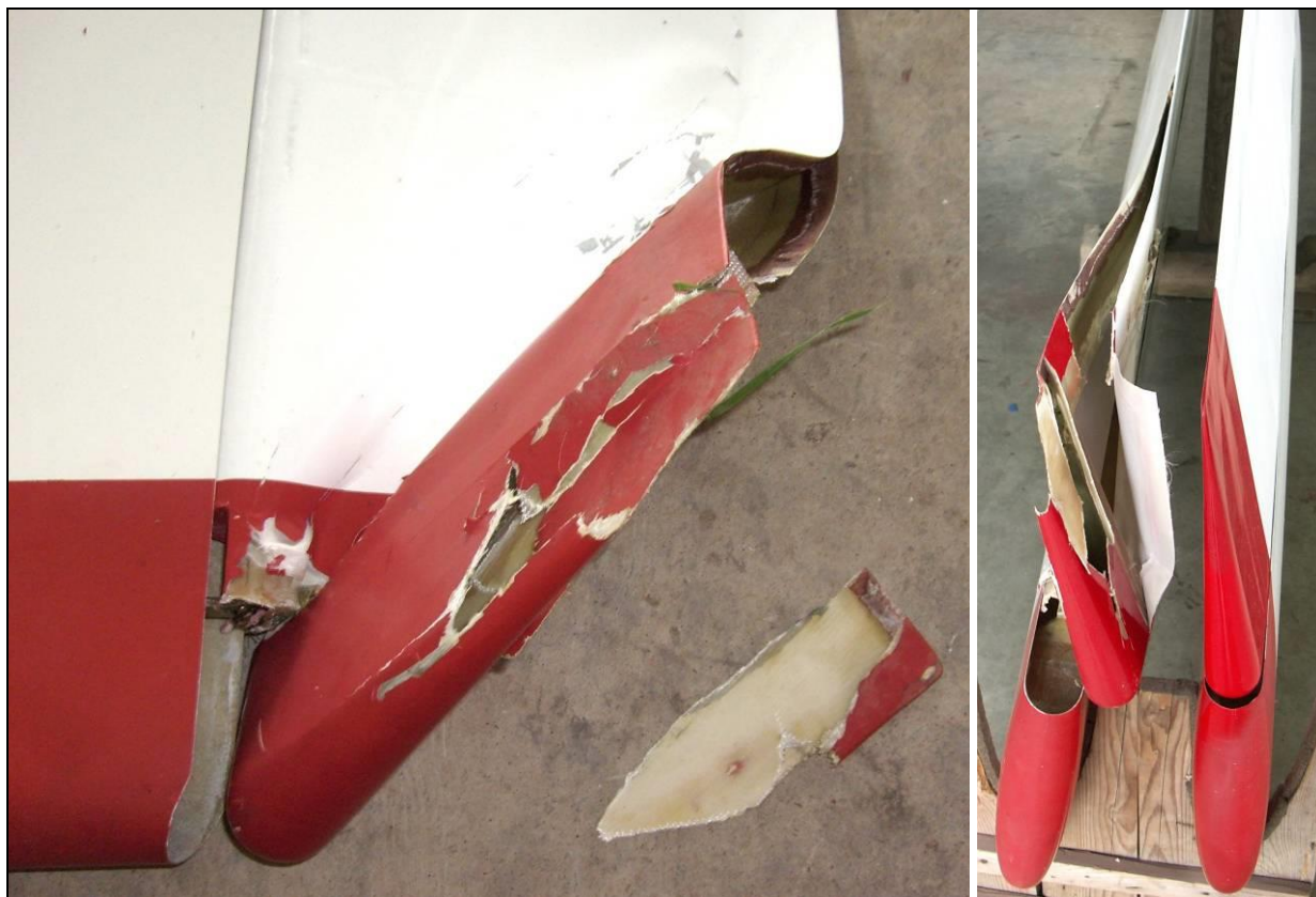
30, 31 – Uszkodzenie końcówki lewego segmentu steru wysokości, widoczne rozdarcie pokrycia wzdłuż spływu [PKBWL].
