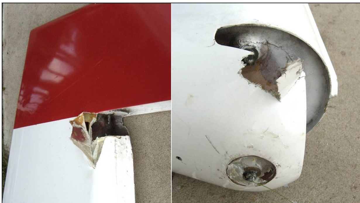
32 – Ster kierunku – uszkodzenie górnego zawiasu [PKBWL].
