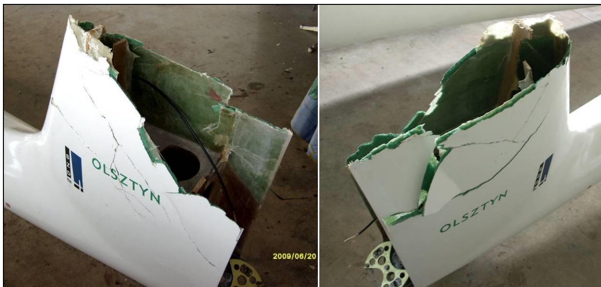
24, 25 – Przełom statecznika pionowego z lewej i prawej strony [AWM, PKBWL].
