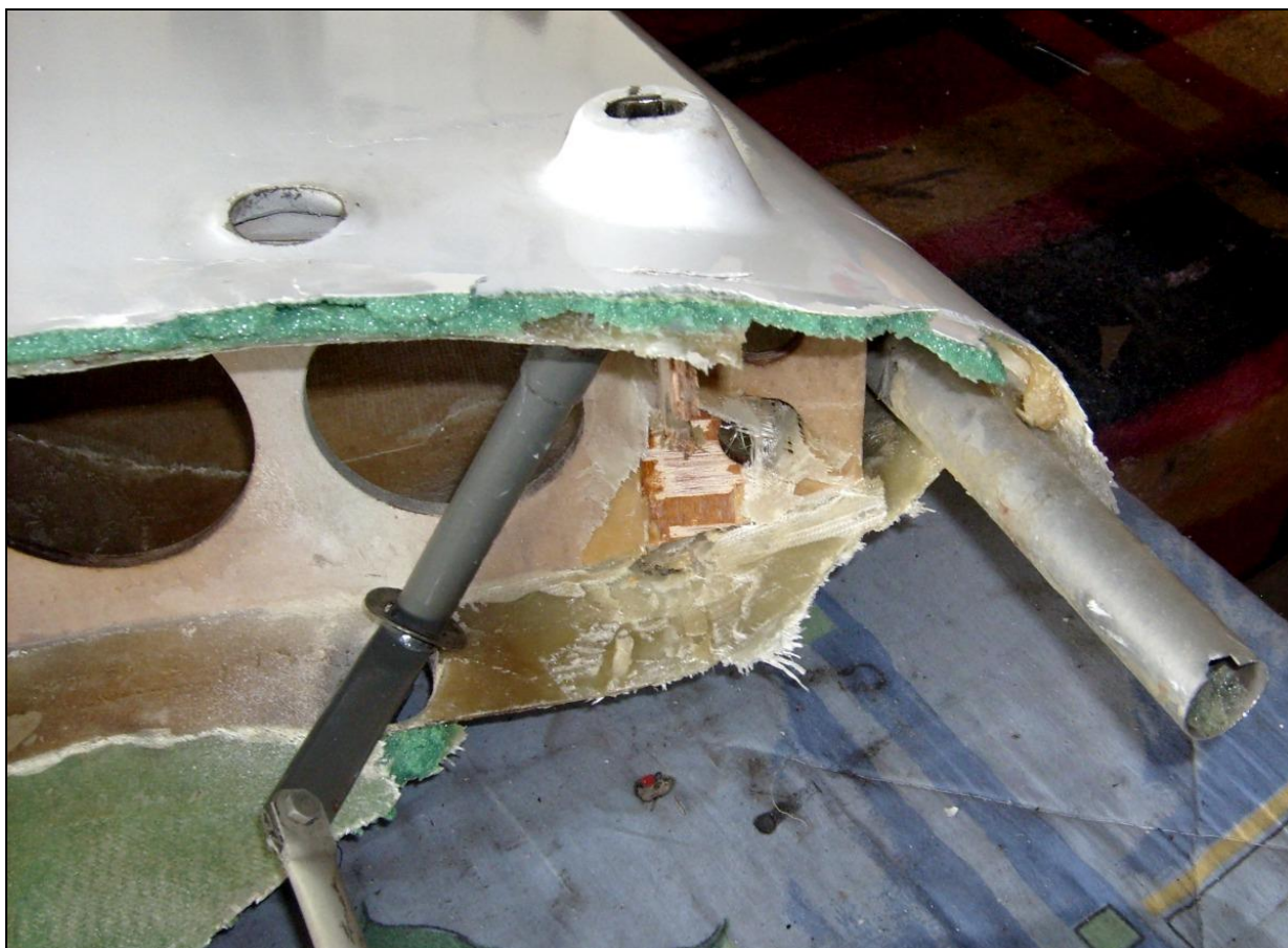
29 – Odłamana górna część statecznika pionowego pokazana od strony przełomu – przód żebra nasadowego [PKBWL].
