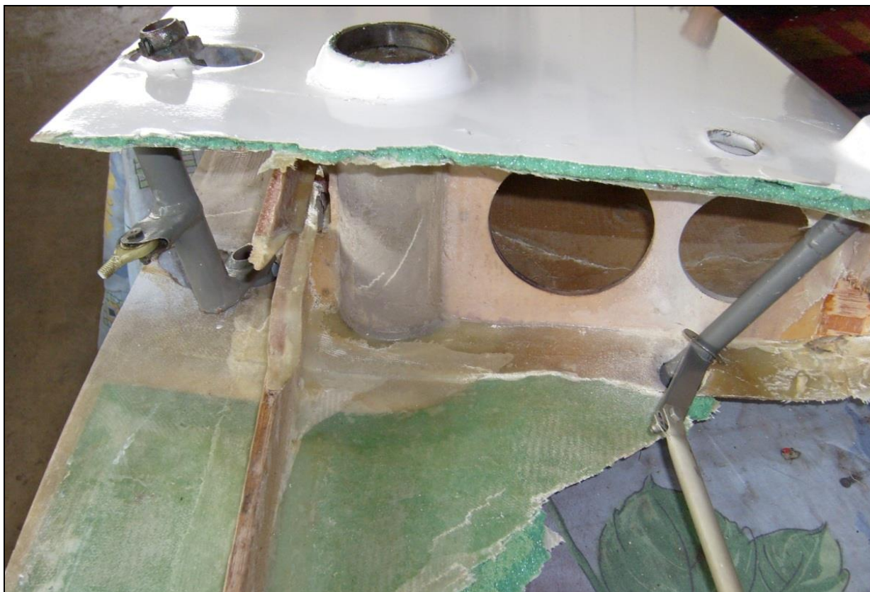
28 – Odłamana górna część statecznika pionowego pokazana od strony przełomu – tył żebra nasadowego [PKBWL].
