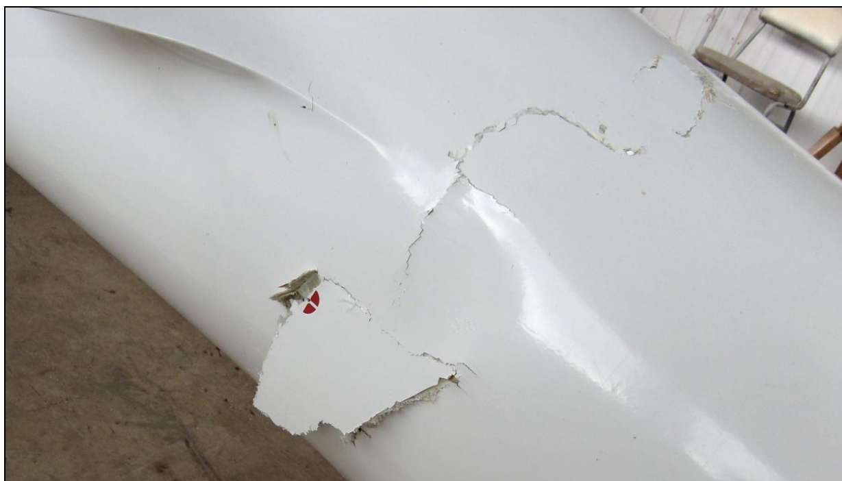
21 – Przełom kadłuba za skrzydłami, widok z lewej strony [AWM].
