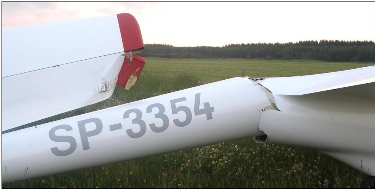
12 – Belka ogonowa, przełamana za skrzydłami i uszkodzona końcówka lewego segmentu steru wysokości [AWM].
