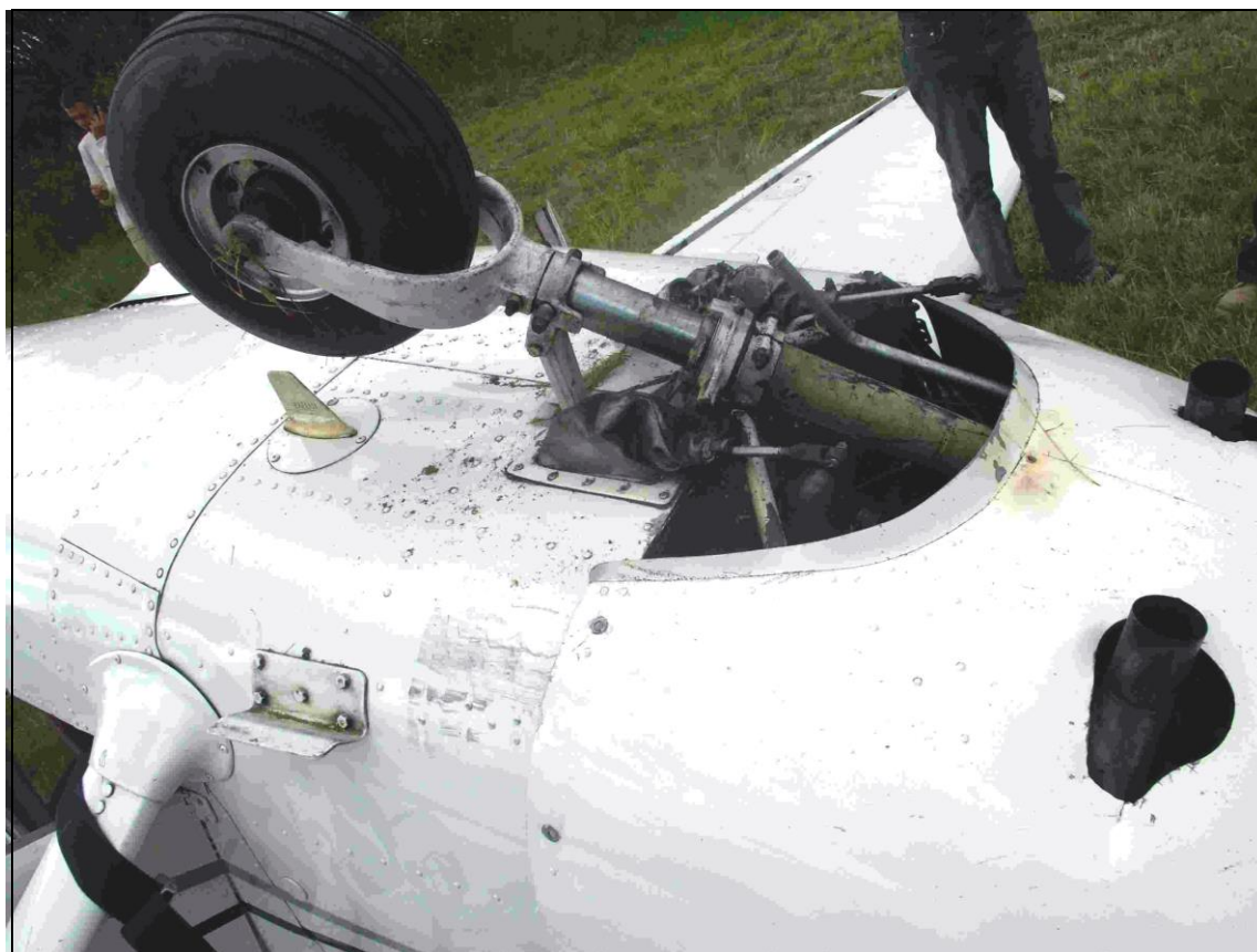
14 – Złamane podwozie przednie, uszkodzenia osłony dolnej silnika.
