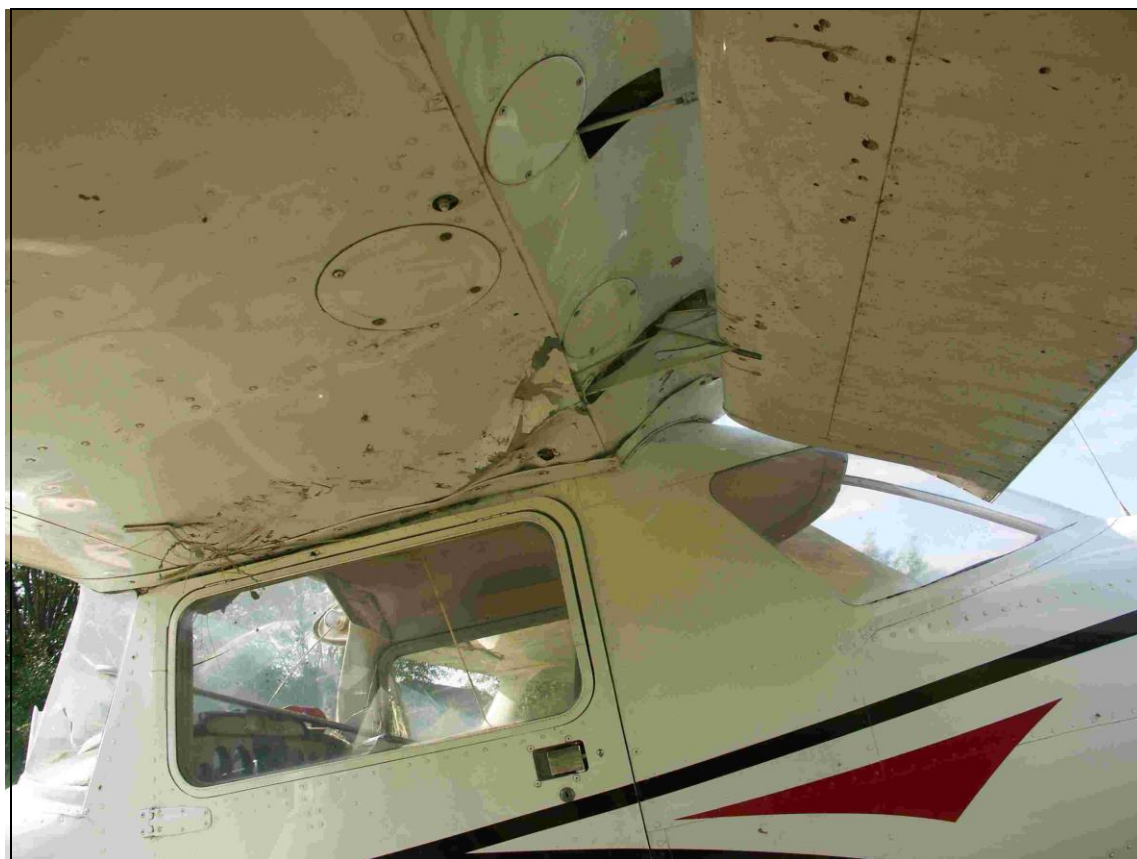
26 – Uszkodzenia lewego skrzydła u nasady.
