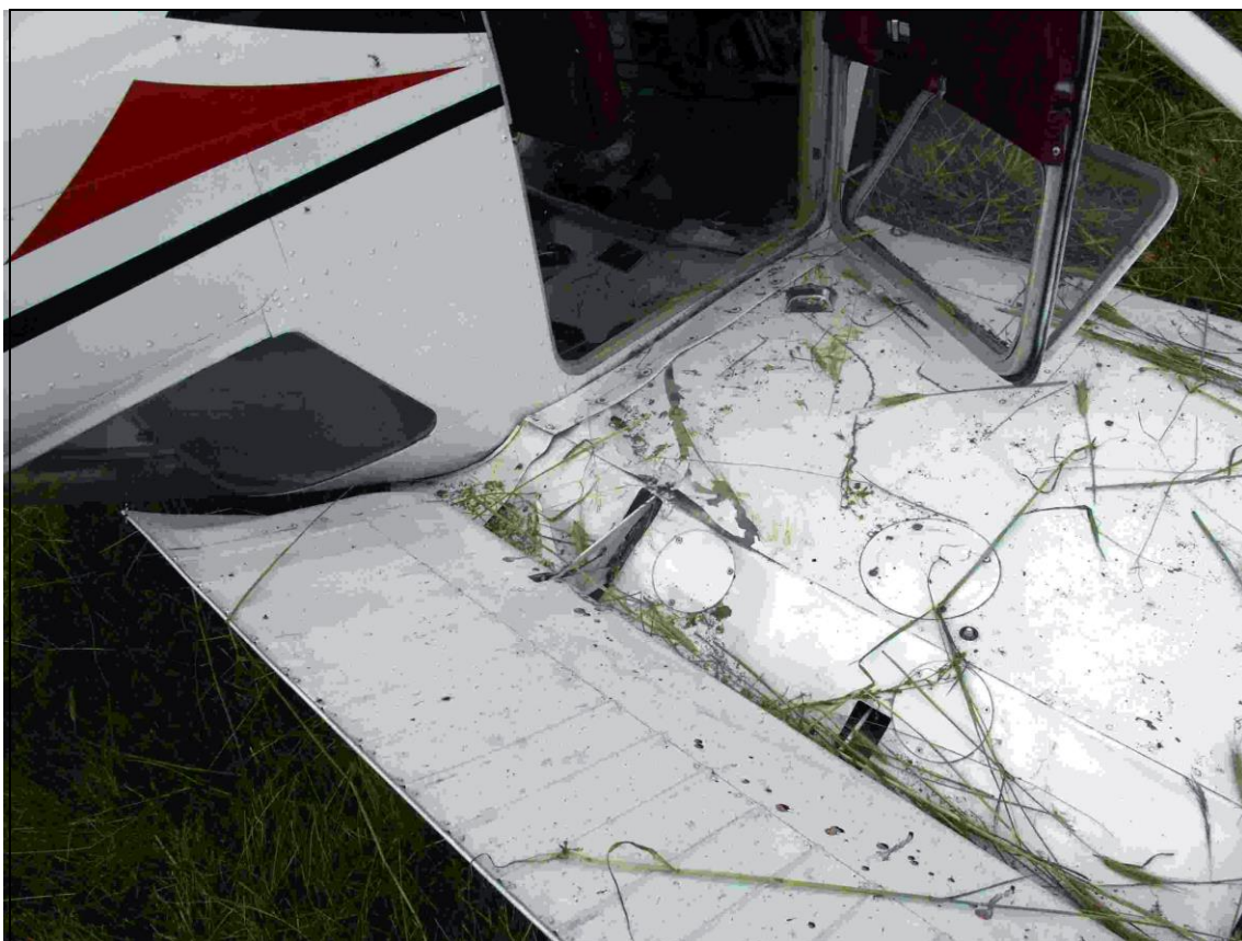
17 – Uszkodzenia dolnego pokrycia lewego skrzydła u nasady.
