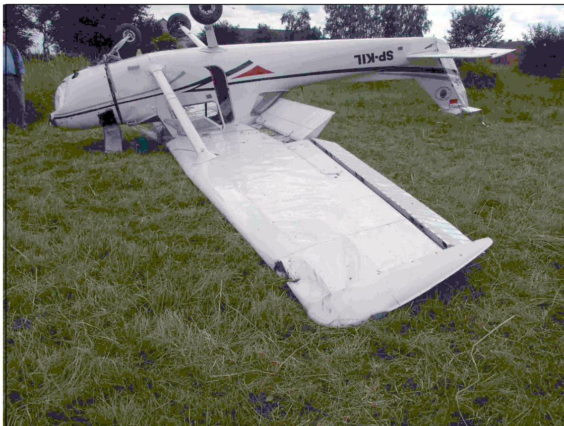
15 – Uszkodzenia dolnego pokrycia prawego skrzydła samolotu.
