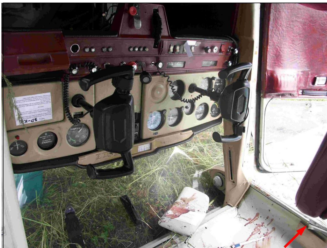
20 – Tablica przyrządów – widok ogólny. Widoczne zgięcie suwaka przepustnicy. W prawym dolnym rogu zdjęcia widoczna rozerwana listwa obramowania drzwi, o którą pasażer skaleczył się w głowę.
