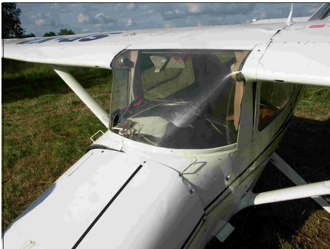
25 – Zbliżenie przedniej części kadłuba – widoczne uszkodzenia wiatrochronu, osłony silnika, deformacje pokryw skrzydeł i kadłuba.
