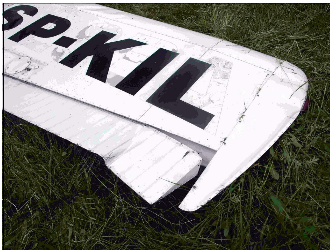
16 – Uszkodzona końcówka lewego skrzydła i lewa lotka od spodu.
