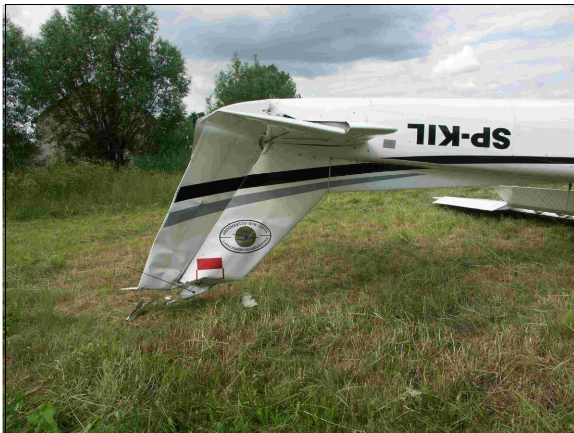
11 – Uszkodzone usterzenie pionowe.
